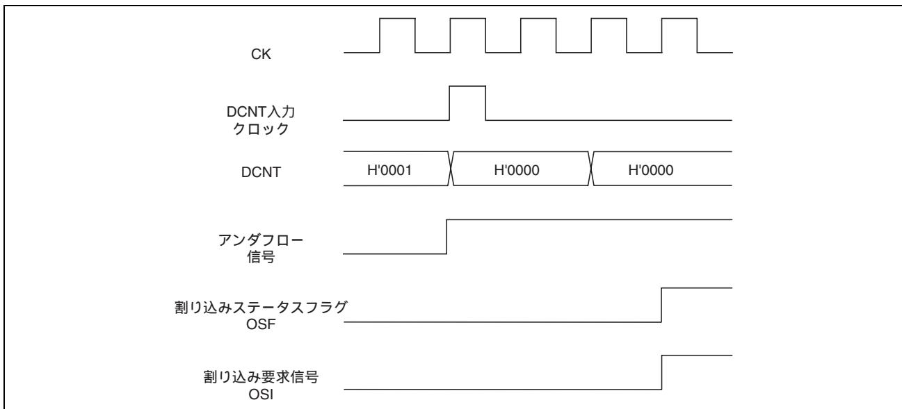
図 11.40 アンダフロー時の OSF のセットタイミング
