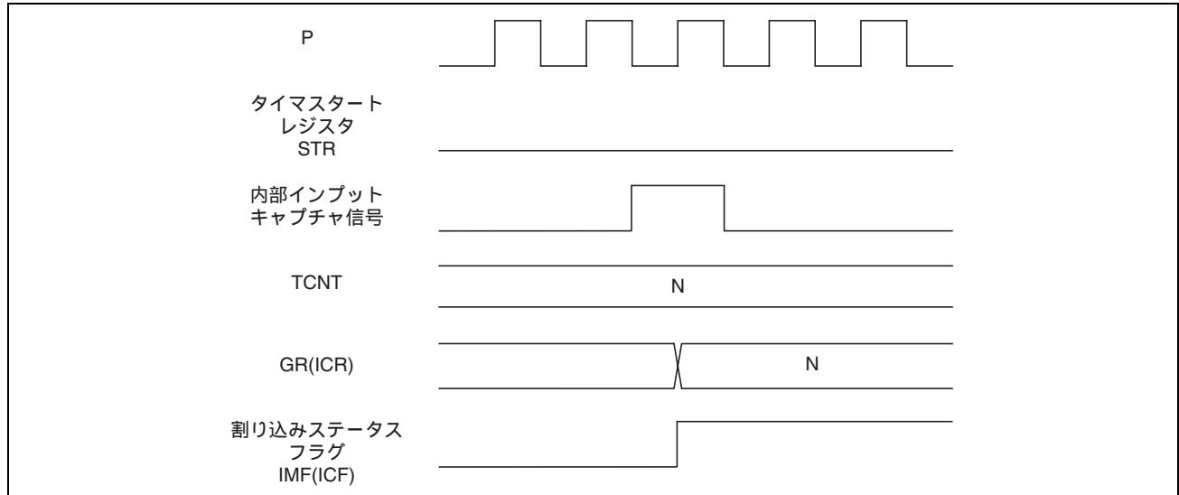
図 11.71 フリーランニングカウンタを動作させる前のインプットキャプチャ動作
