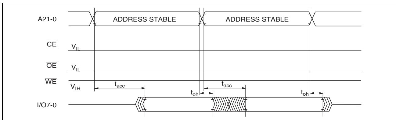
図 24.34 CE、OE イネーブル状態リード時のタイミング波形
