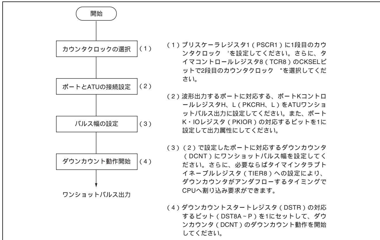
図 11.56 ワンショットパルス出力動作の設定手順例
