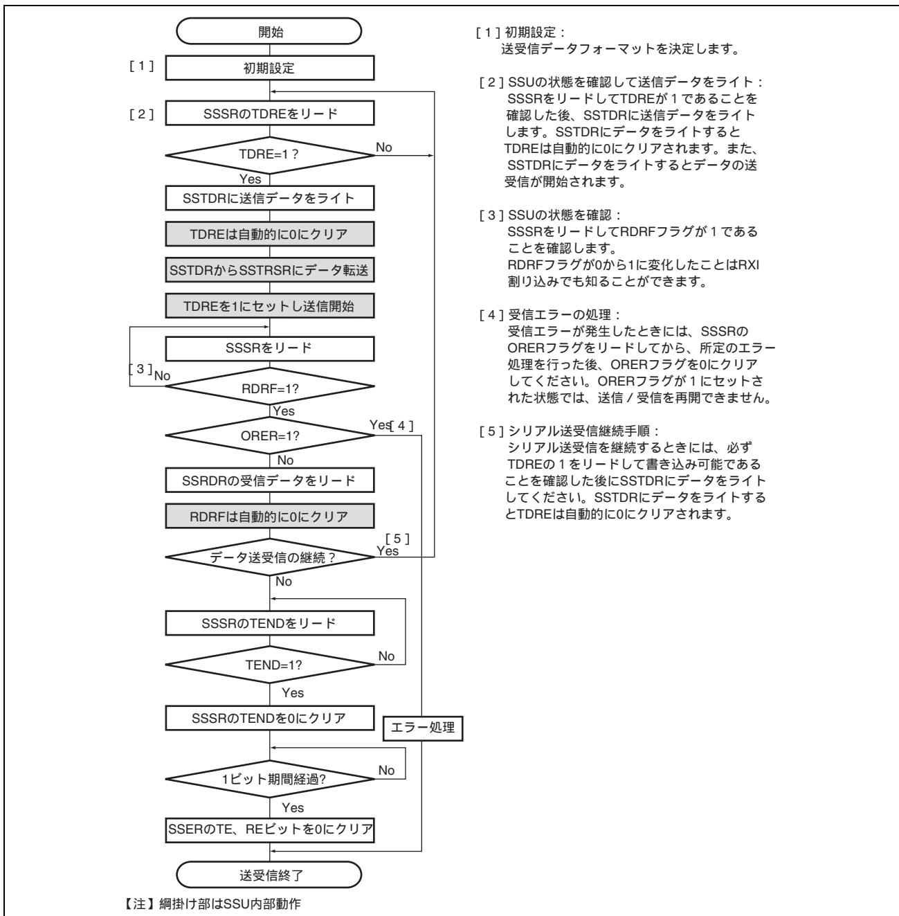
図 16.9 データ送受信同時動作のフローチャート例
