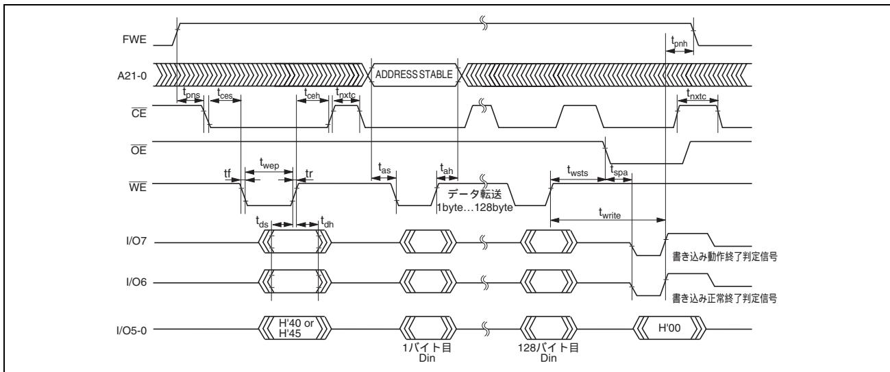
図 25.36 自動書き込みモードのタイミング波形
