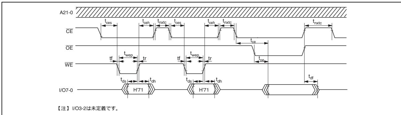
図 25.38 ステータス読み出しモードのタイミング波形
