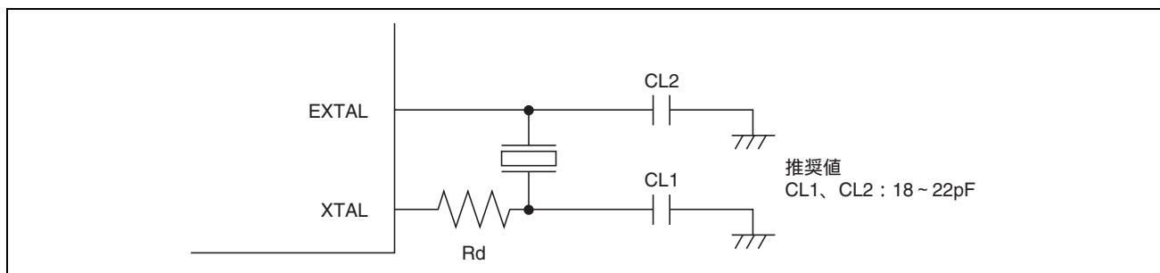
図 5.3 水晶発振子の接続例
