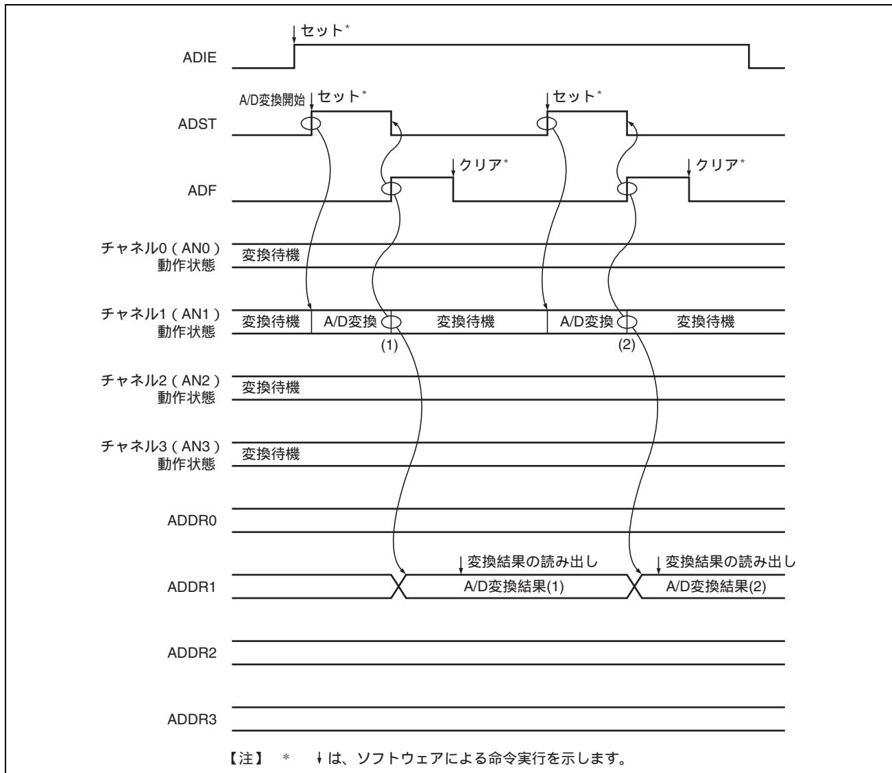
図 18.3 A/D 変換器の動作例 ( 単一モード チャンネル 1 選択時 )
