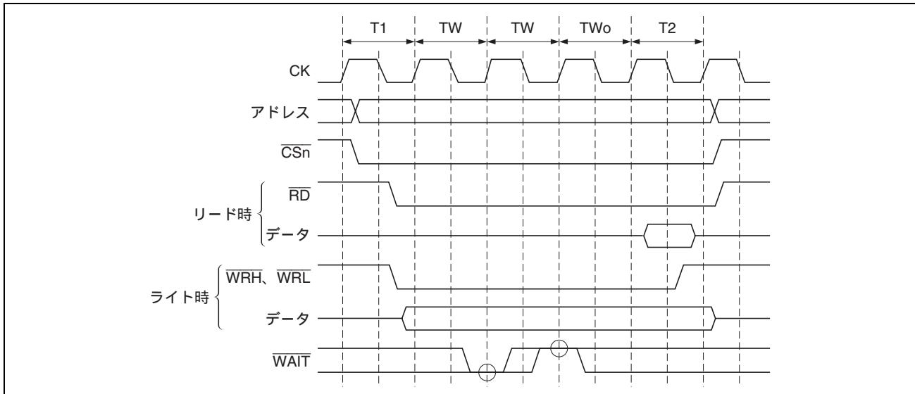
図 9.5 外部空間アクセスのウェイトステートタイミング (ソフトウェアウェイト 2 ステート +  $\overline{\text{WAIT}}$  信号によるウェイトステート)
