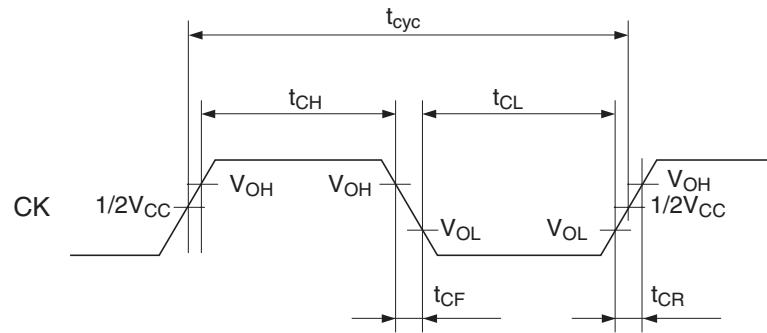
【注】CK端子は $V_{CC} = 3.3V \pm 0.3V$ の電源回路です。
