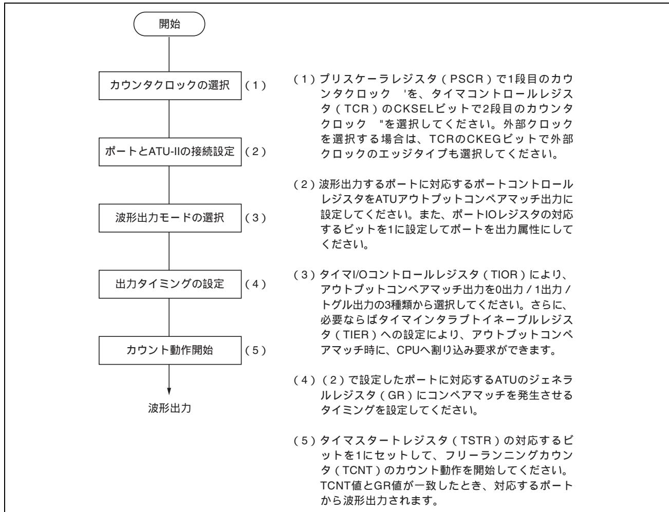
図 11.54 アウトプットコンペアマッチによる波形出力動作の設定手順例
