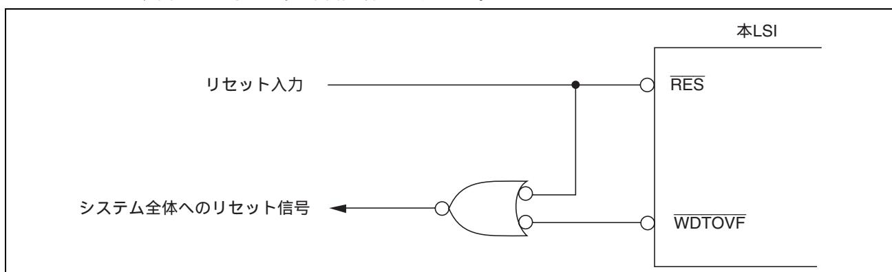
図 13.9  $\overline{\text{WDTOVF}}$  信号によるシステムリセット回路例
