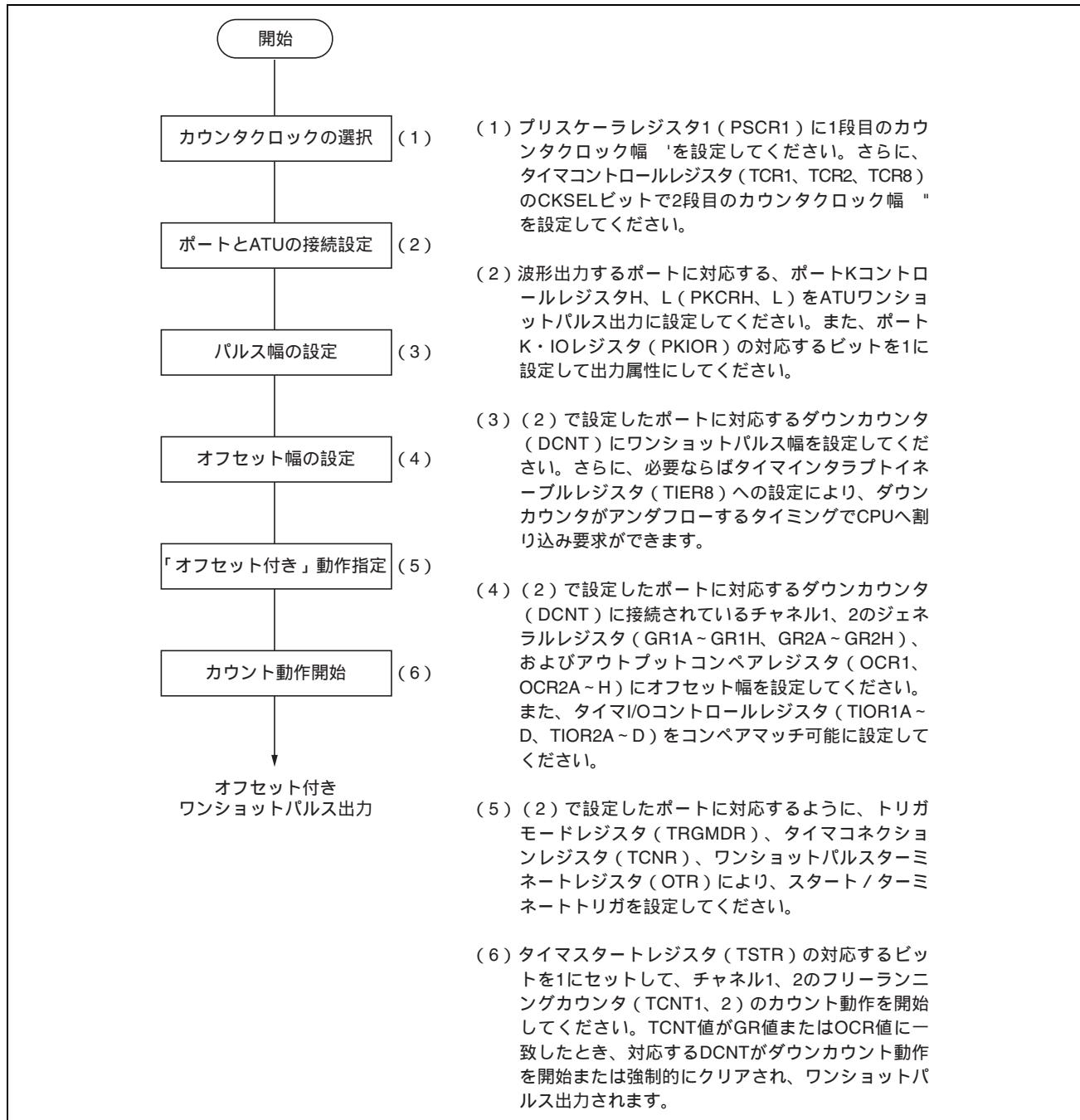
図 11.57 オフセット付きワンショットパルス出力動作の設定手順例
