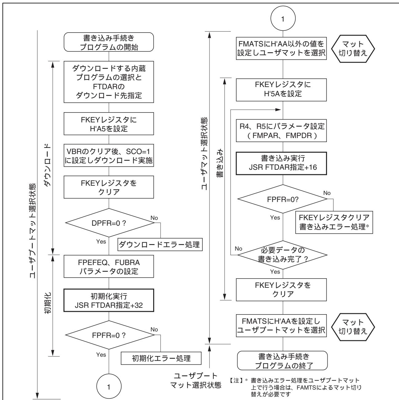
図 24.14 ユーザブートモードでのユーザマットへの書き込み手順
