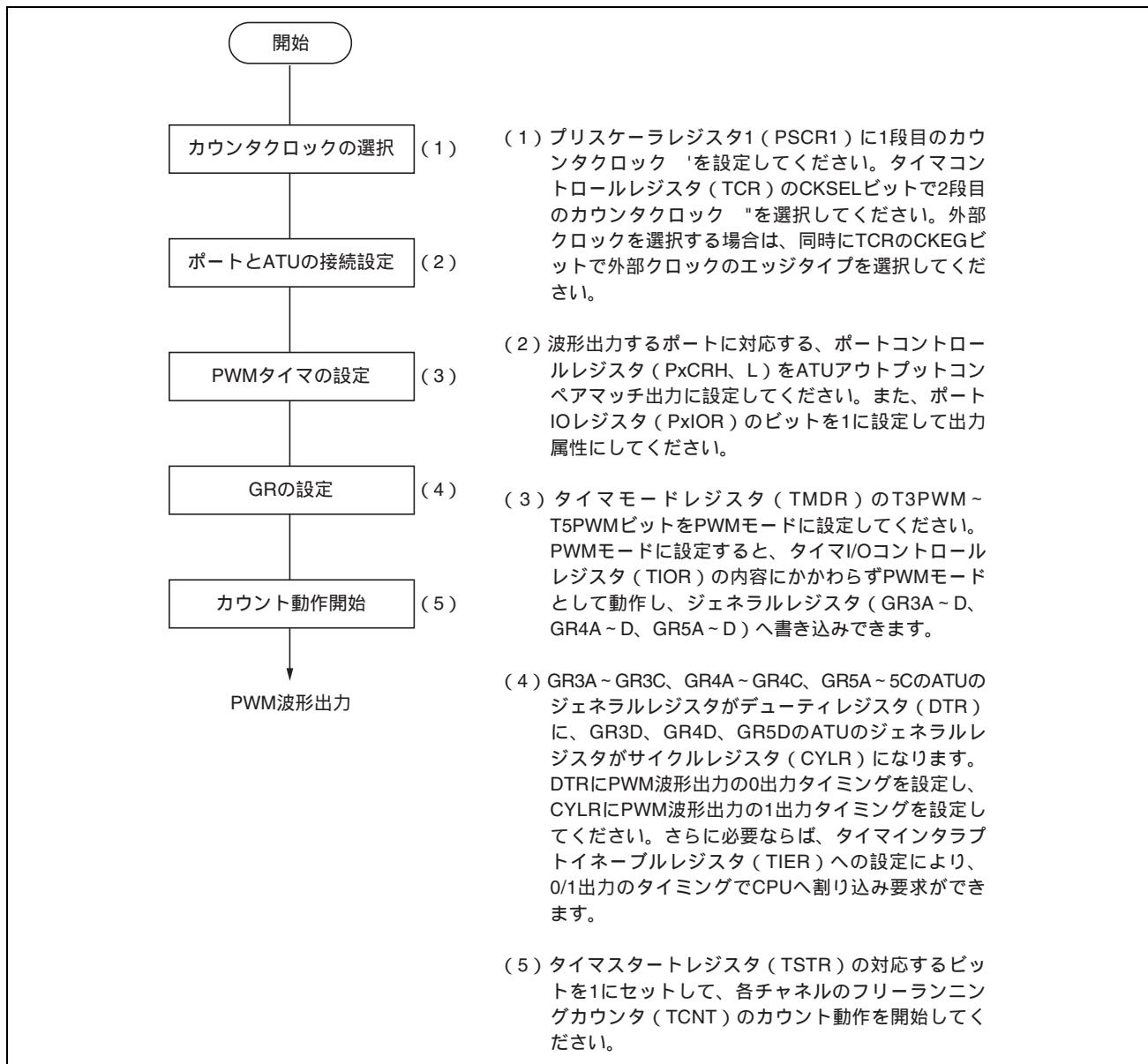
図 11.59 PWM タイマ (ch3~5) 動作の設定手順例
