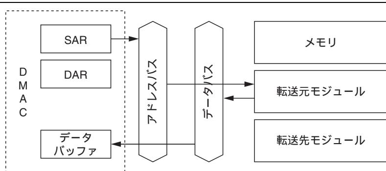
SARの値をアドレスとし、転送元モジュールからデータを読み込み、DMAC内部に一時格納する。
