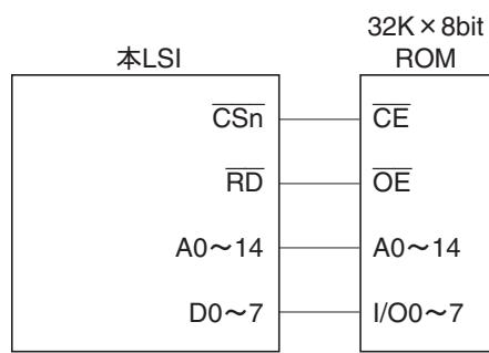
図 9.10 8 ビットデータバス幅 ROM 接続例
