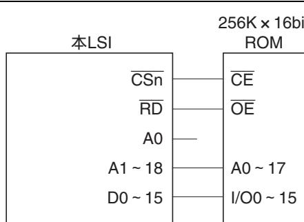
図 9.11 16 ビットデータバス幅 ROM 接続例
