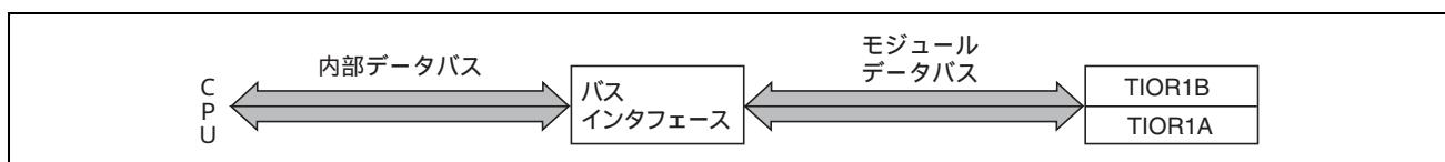
図 11.51 TIOR1A、B へのワード書き込み / 読み出し動作
