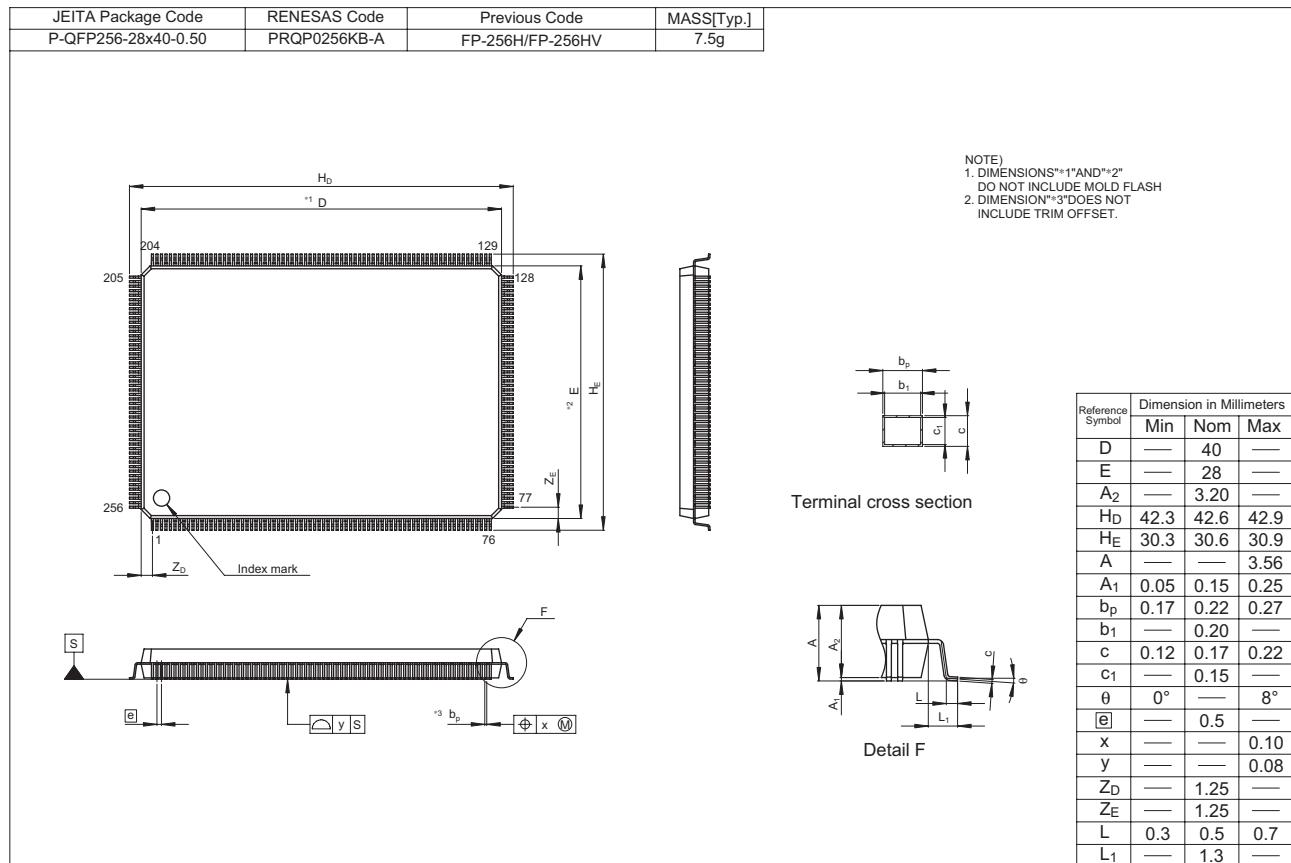
図D.1 外形寸法図(FP-256H)
