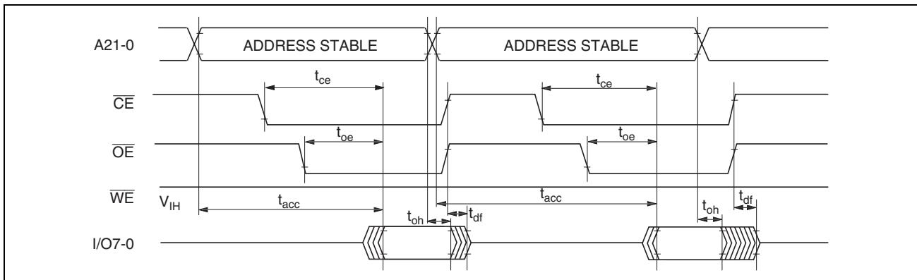
図 25.35 CE、OE クロック方式リード時のタイミング波形
