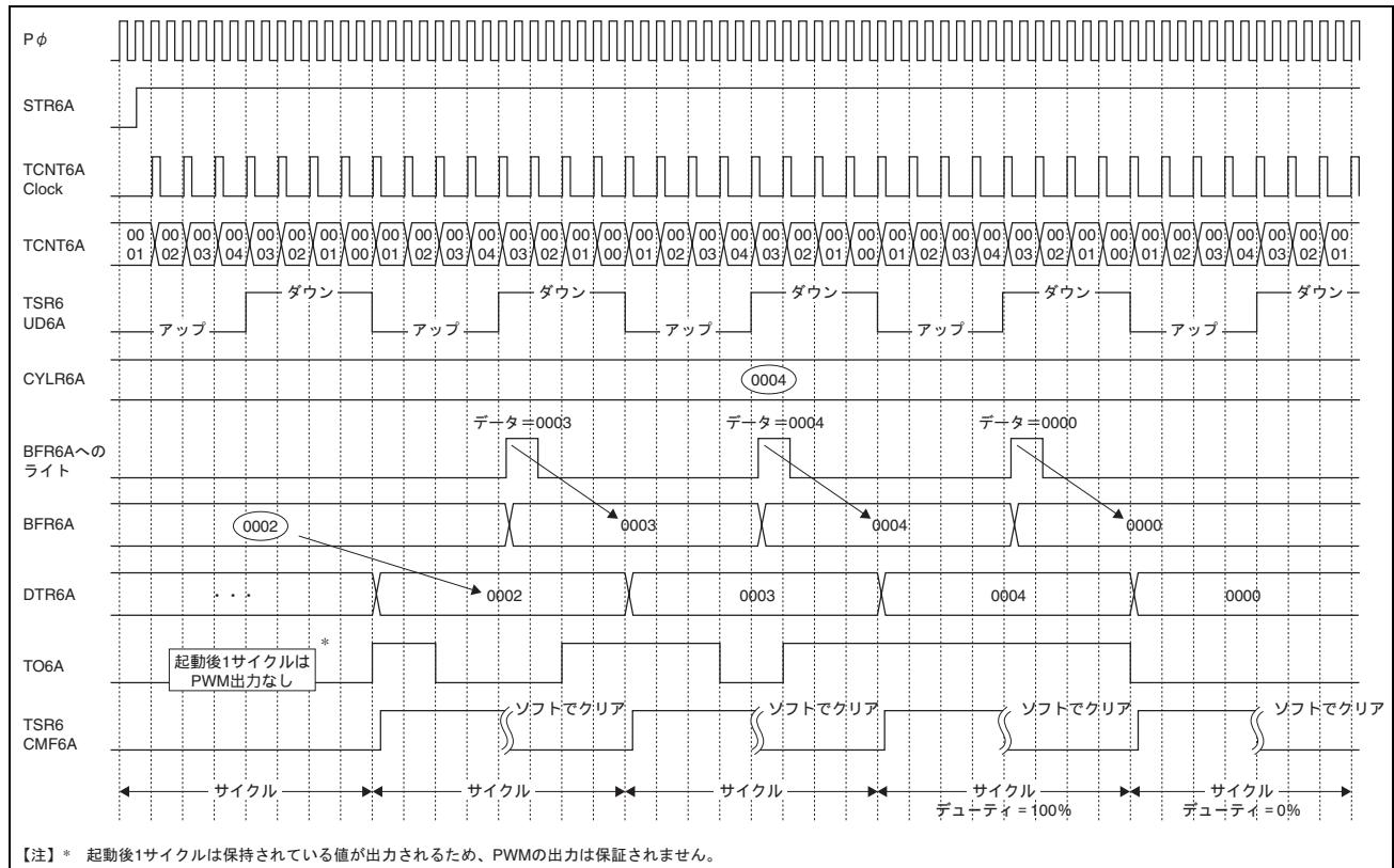
図 11.22 相補 PWM モード動作
