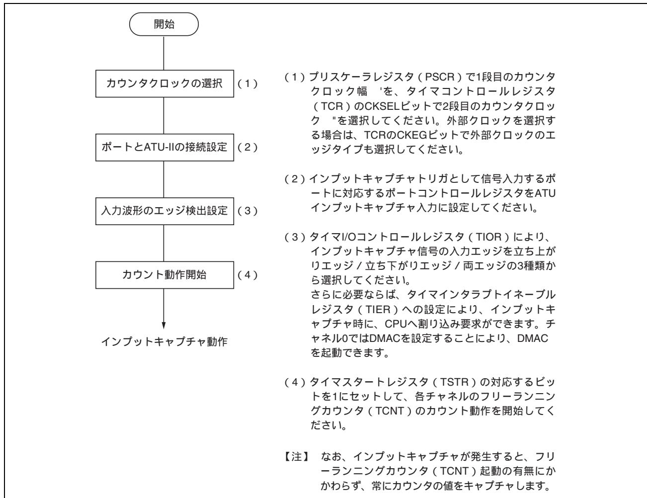
図 11.53 インプットキャプチャ動作の設定手順例
