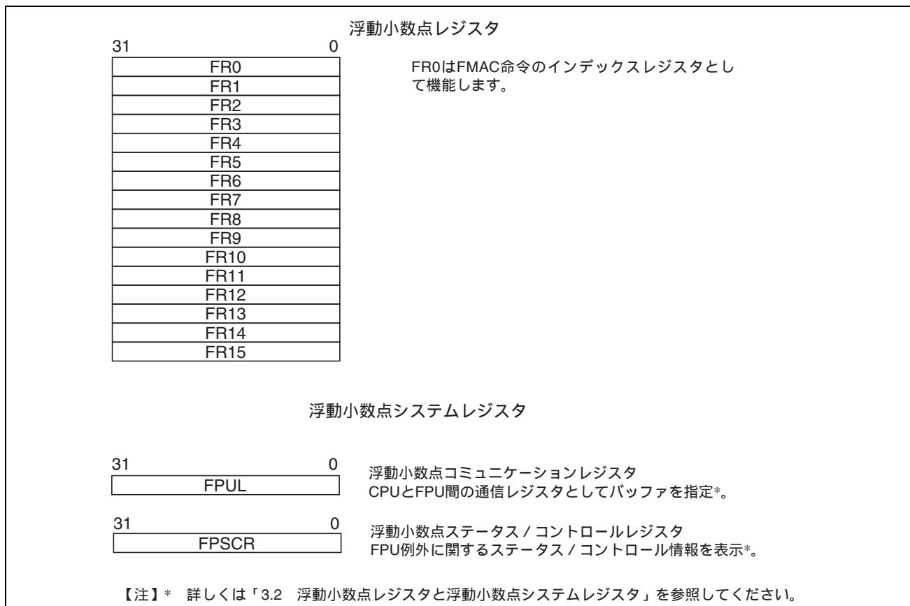
図 3.1 レジスタの構成の概要（浮動小数点レジスタ、浮動小数点システムレジスタ）
