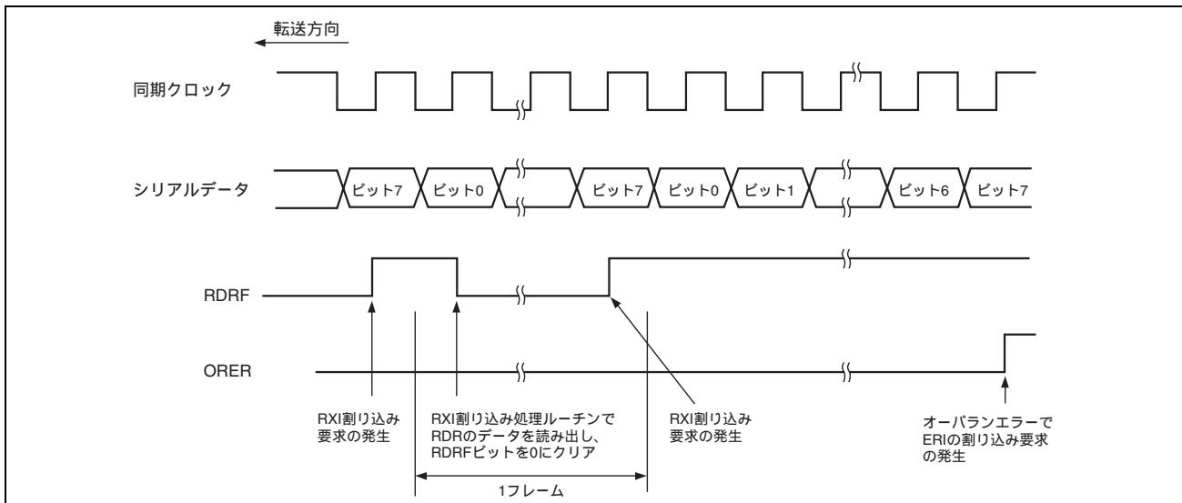
図 15.22 SCI の受信時の動作例
