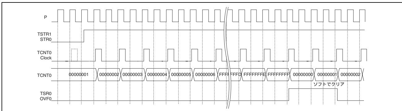
図11.13 フリーランニングカウンタ動作およびオーバーフロータイミング
