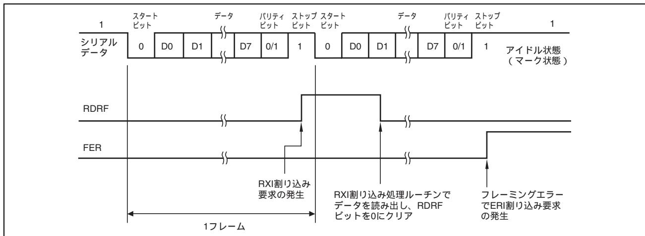
図 15.9 SCI の受信時の動作例 (8 ビットデータ / パリティあり / 1 ストップビットの例)
