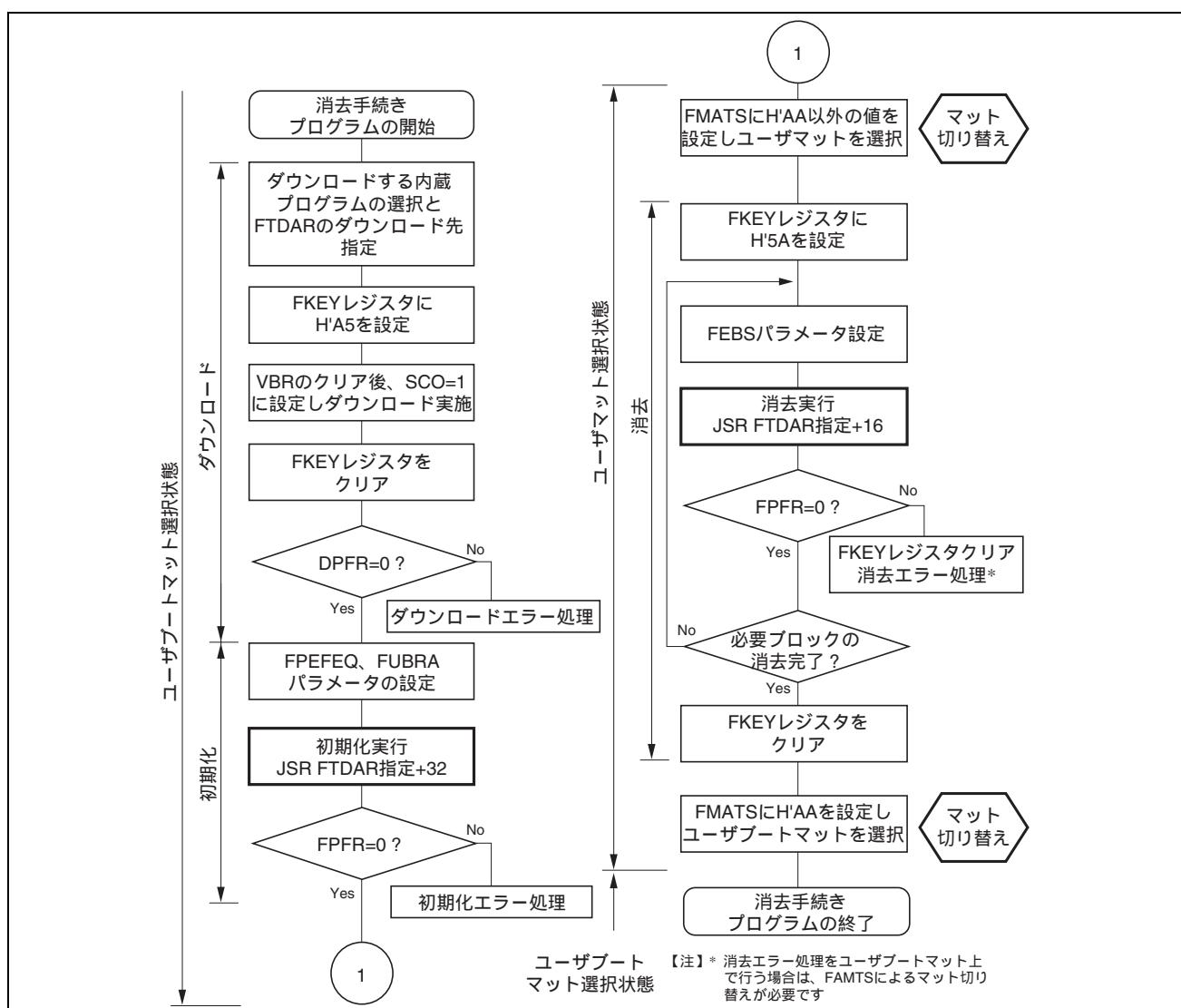
図 24.15 ユーザブートモードでのユーザマットの消去手順
