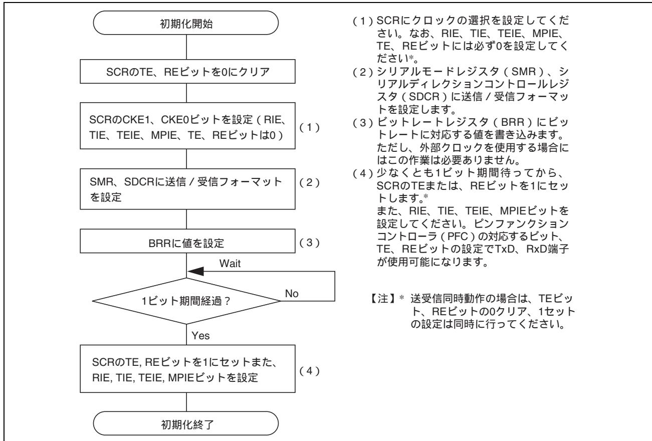
図 15.17 SCI の初期化フローチャートの例
