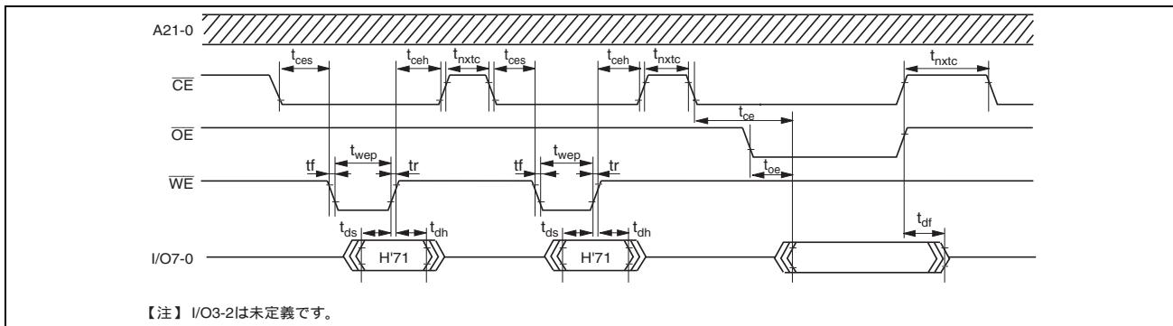
図 24.38 ステータス読み出しモードのタイミング波形
