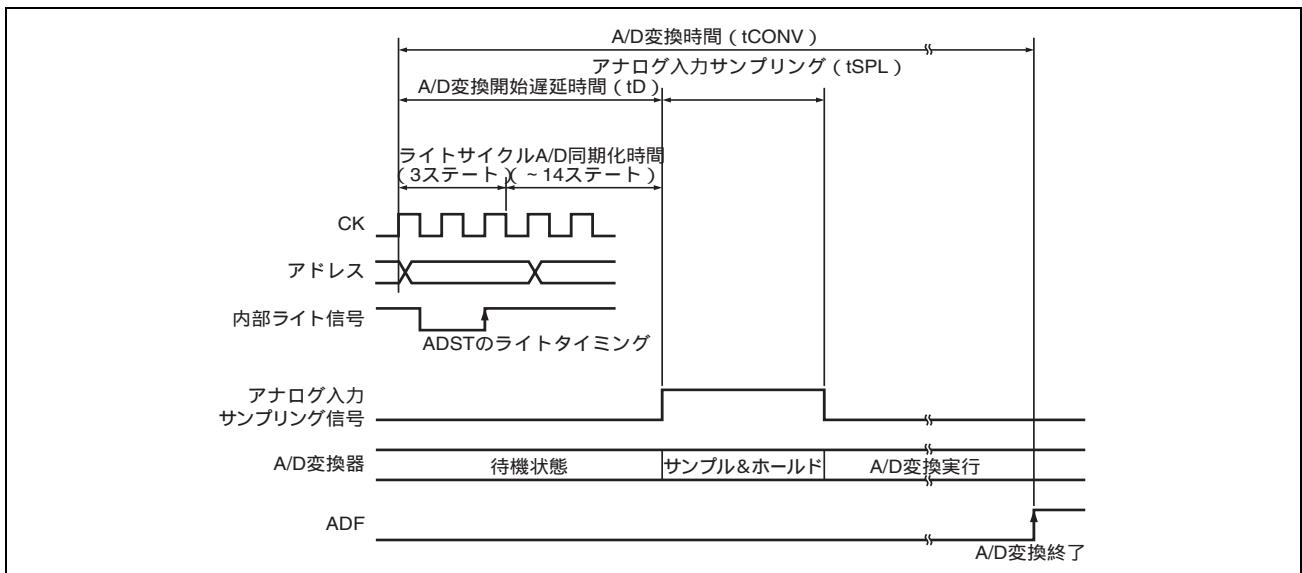
図 18.6 A/D 変換タイミング
