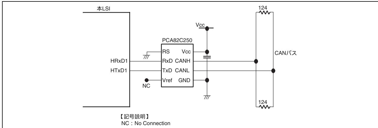
図 17.16 PCA82C250 を用いたハイスピードインターフェース
