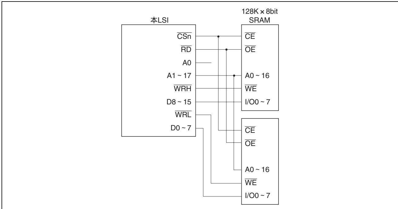
図 9.13 16 ビットデータバス幅 SRAM 接続例
