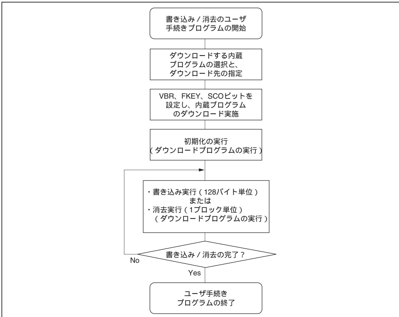
図 25.5 ユーザ手続きプログラムの概要
