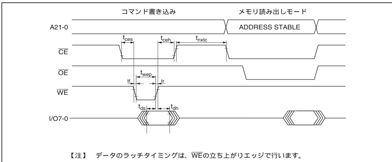
図 24.32 コマンド書き込み後メモリ読み出しタイミング図
