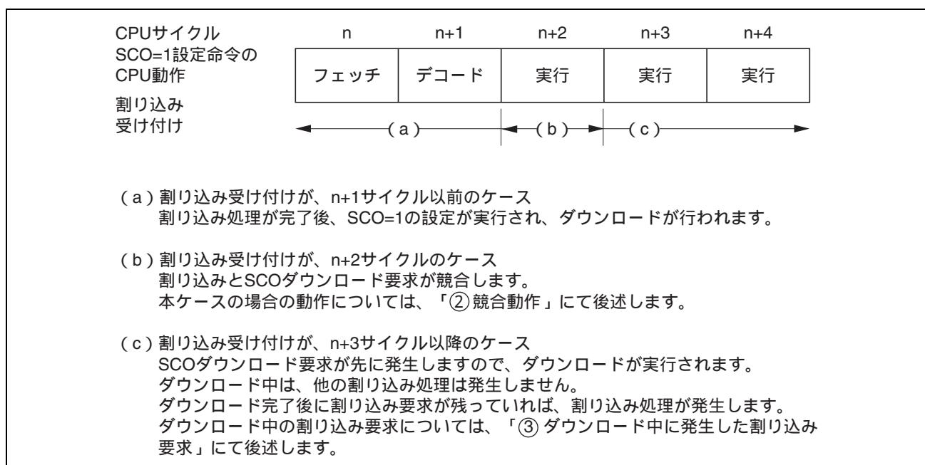
図 24.21 SCO ダウンロード要求と割り込み要求の競合タイミング
