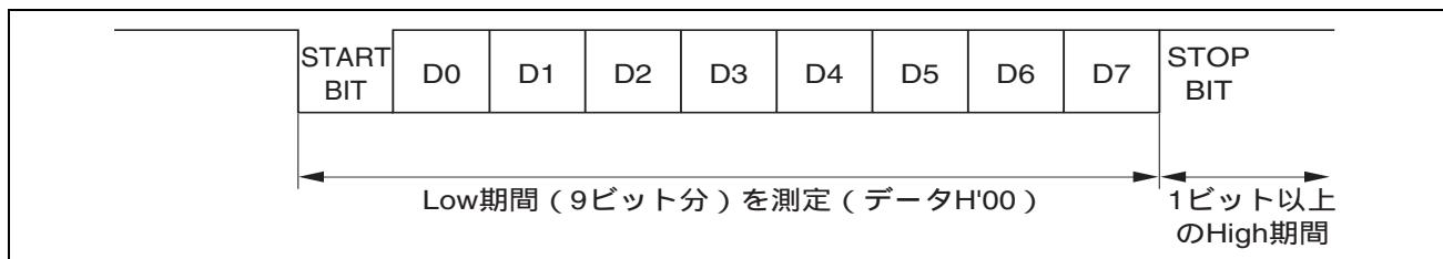
図24.7 SCIビットレートの自動合わせ込み動作
