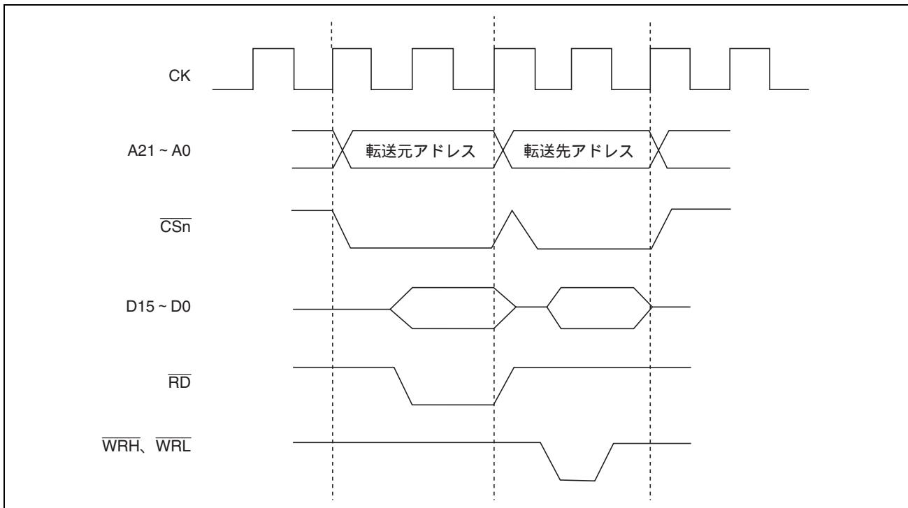
図 10.4 デュアルアドレスモード、直接アドレスでのデータの流れ
