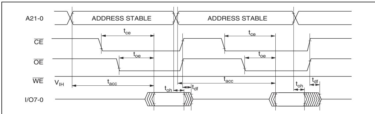
図 24.35 CE、OE クロック方式リード時のタイミング波形
