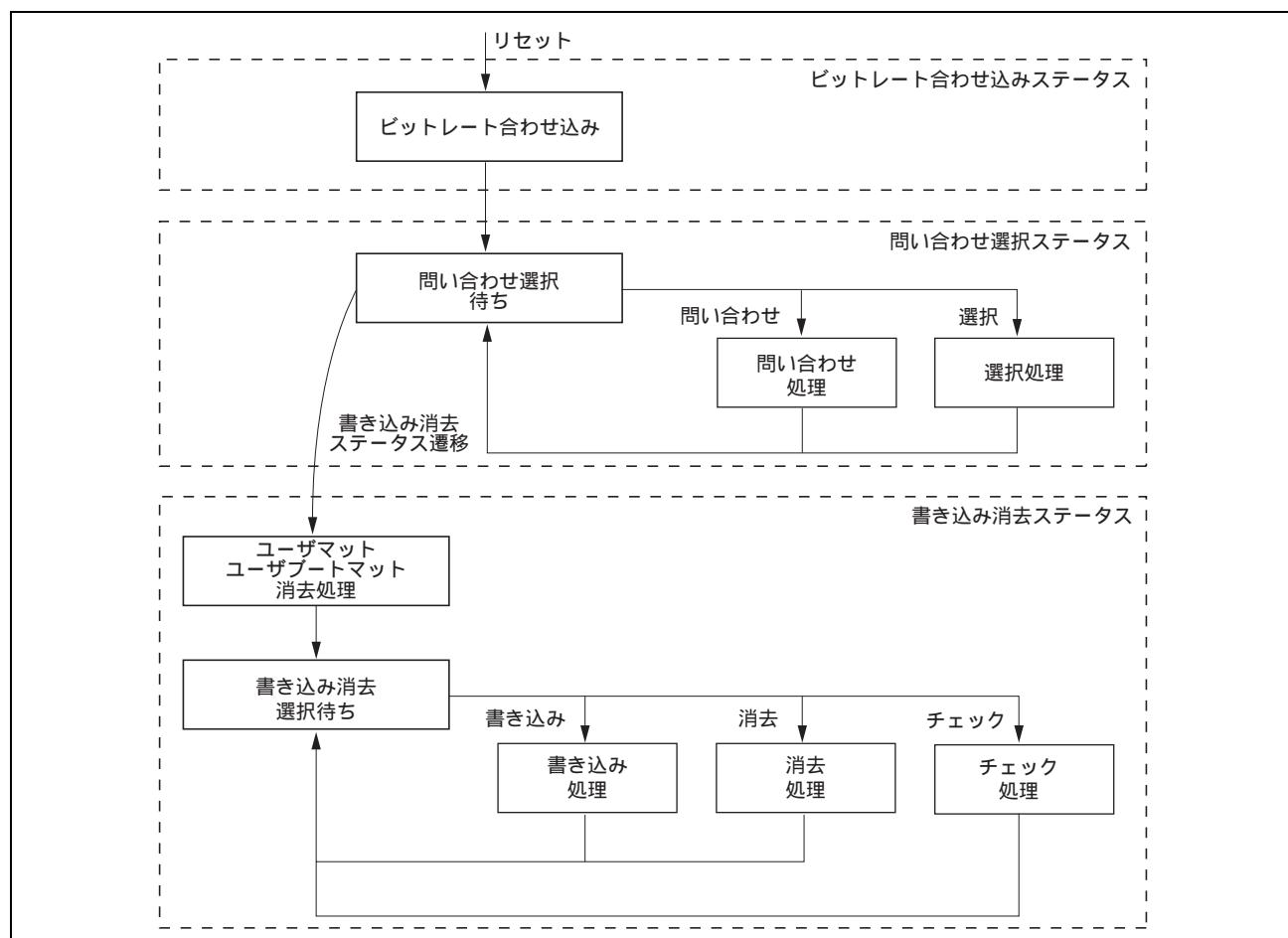
図 25.26 ブートプログラムの処理フロー
