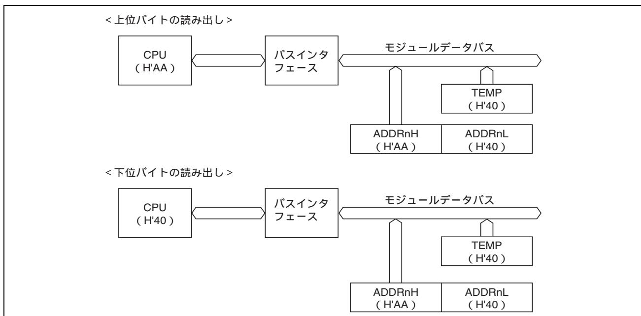
図 18.2 ADDR のアクセス動作 ( ( H'AA40 ) 読み出し時 )
