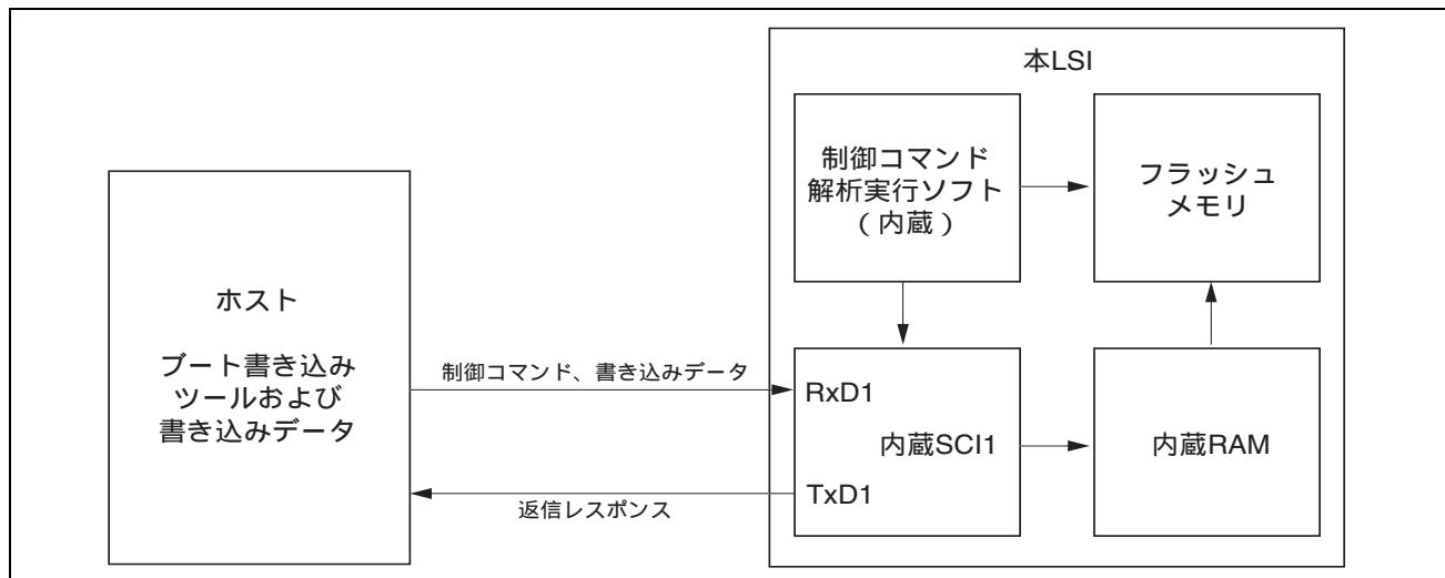
図24.6 ブートモード時のシステム構成図
