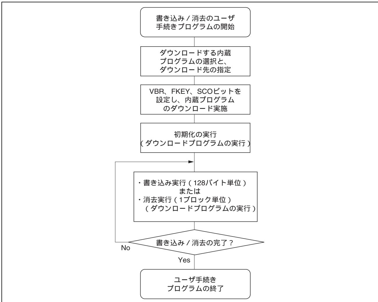
図 24.5 ユーザ手手続きプログラムの概要
