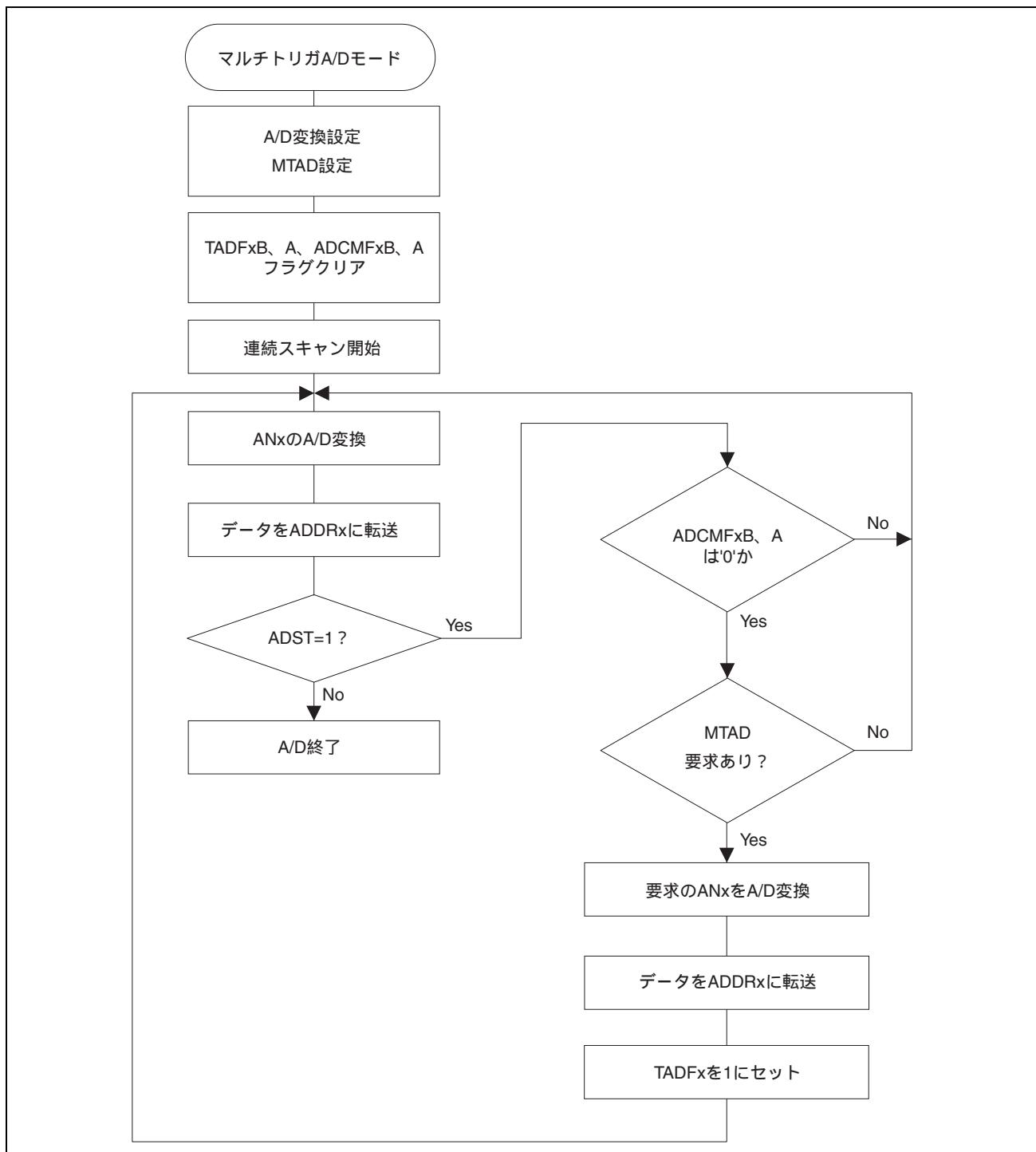
図 19.3 マルチトリガ A/D 変換器の動作フローチャート
