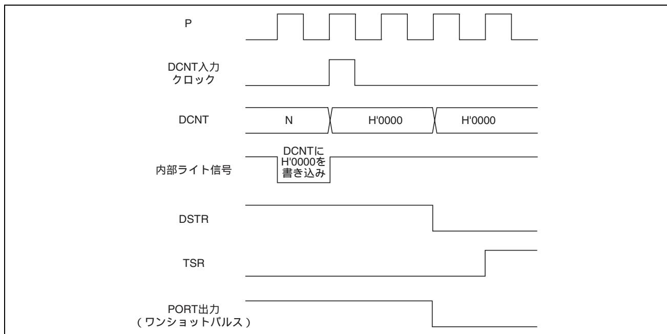
図 11.70 CPU からのダウンカウンタ停止方法と動作
