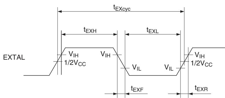
【注】EXTAL端子は $V_{CC} = 3.3V \pm 0.3V$ の電源回路です。
