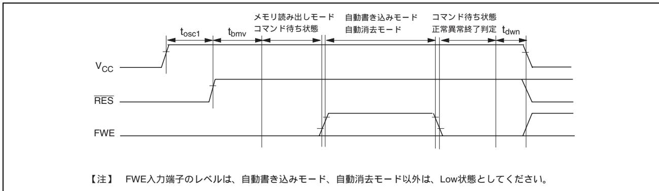
図 24.39 発振安定時間、ライタモードセットアップ時間、電源立ち下げシーケンス
