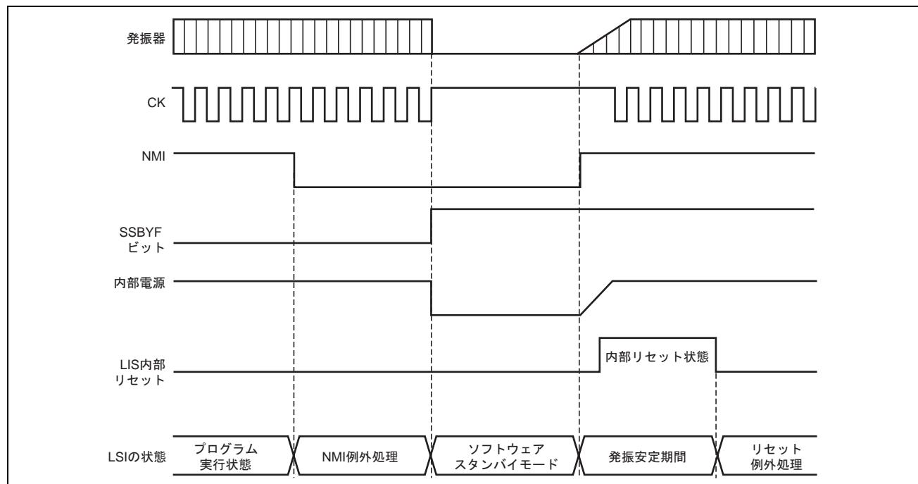
図 27.3 ソフトウェアスタンバイモード時の NMI タイミング (応用例)
