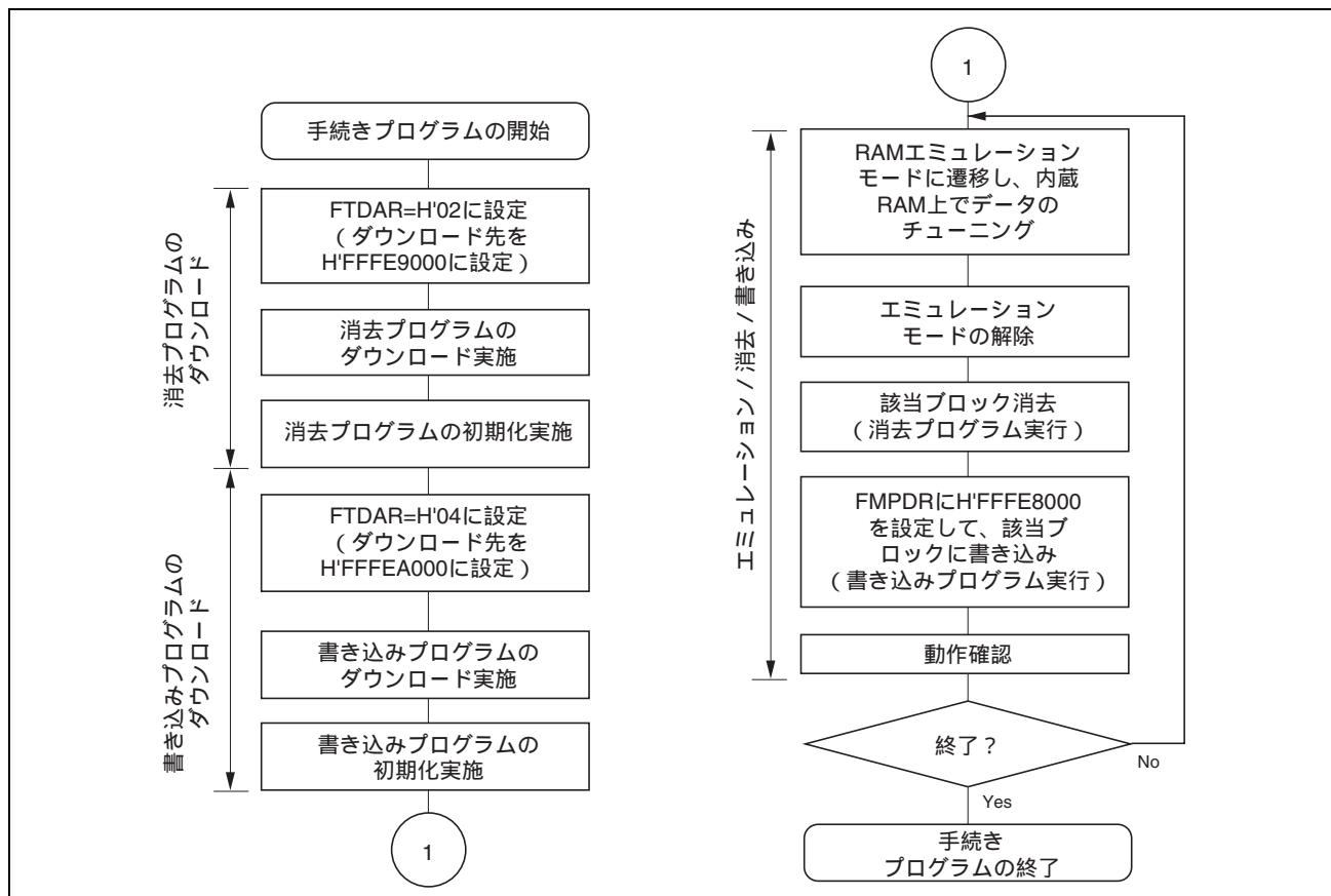
図 25.13 RAM エミュレーション、消去、書き込みの繰り返し例（概要）
