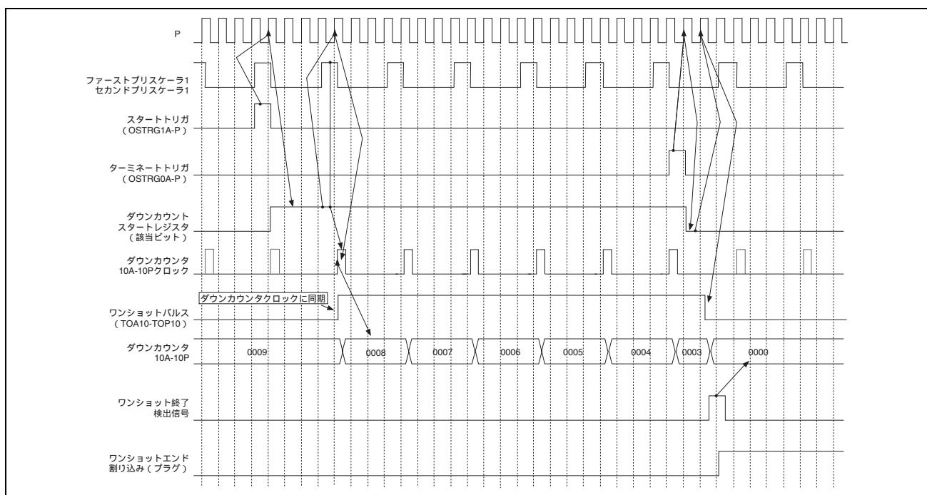
図 11.18 オフセット付きワンショットパルス出力機能と出力遮断機能動作
