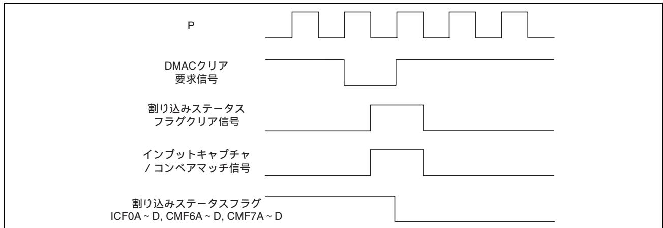
図 11.69 割り込みステータスフラグのDMACによるクリアとインプットキャプチャ／コンペアマッチによるセットの競合
