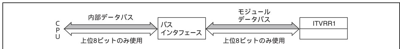
図 11.52 ITVRR1 へのバイト書き込み / 読み出し動作
