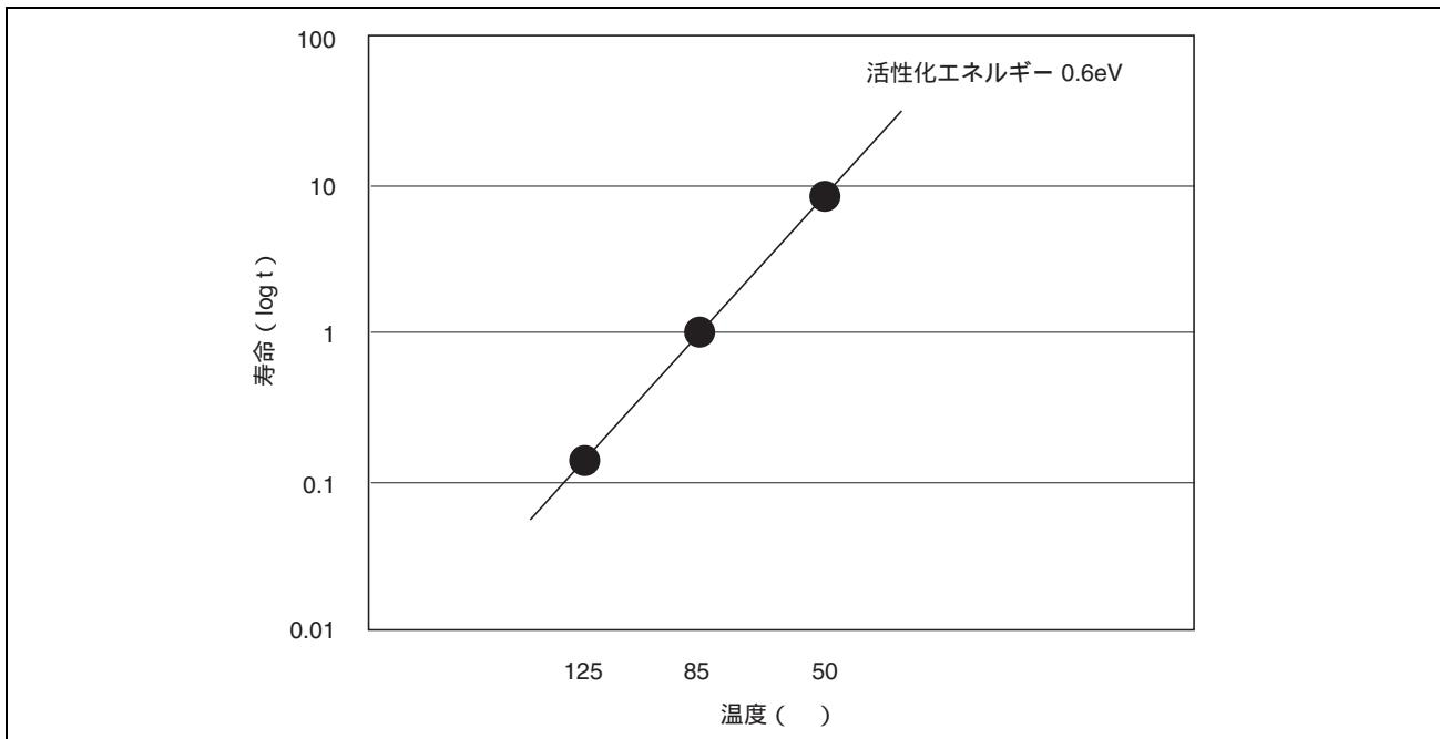
図28.2 酸化膜の絶縁破壊の温度依存性
