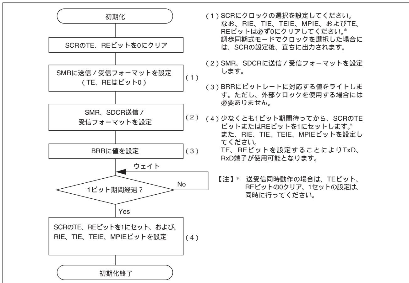
図 15.4 SCI の初期化フローチャートの例
