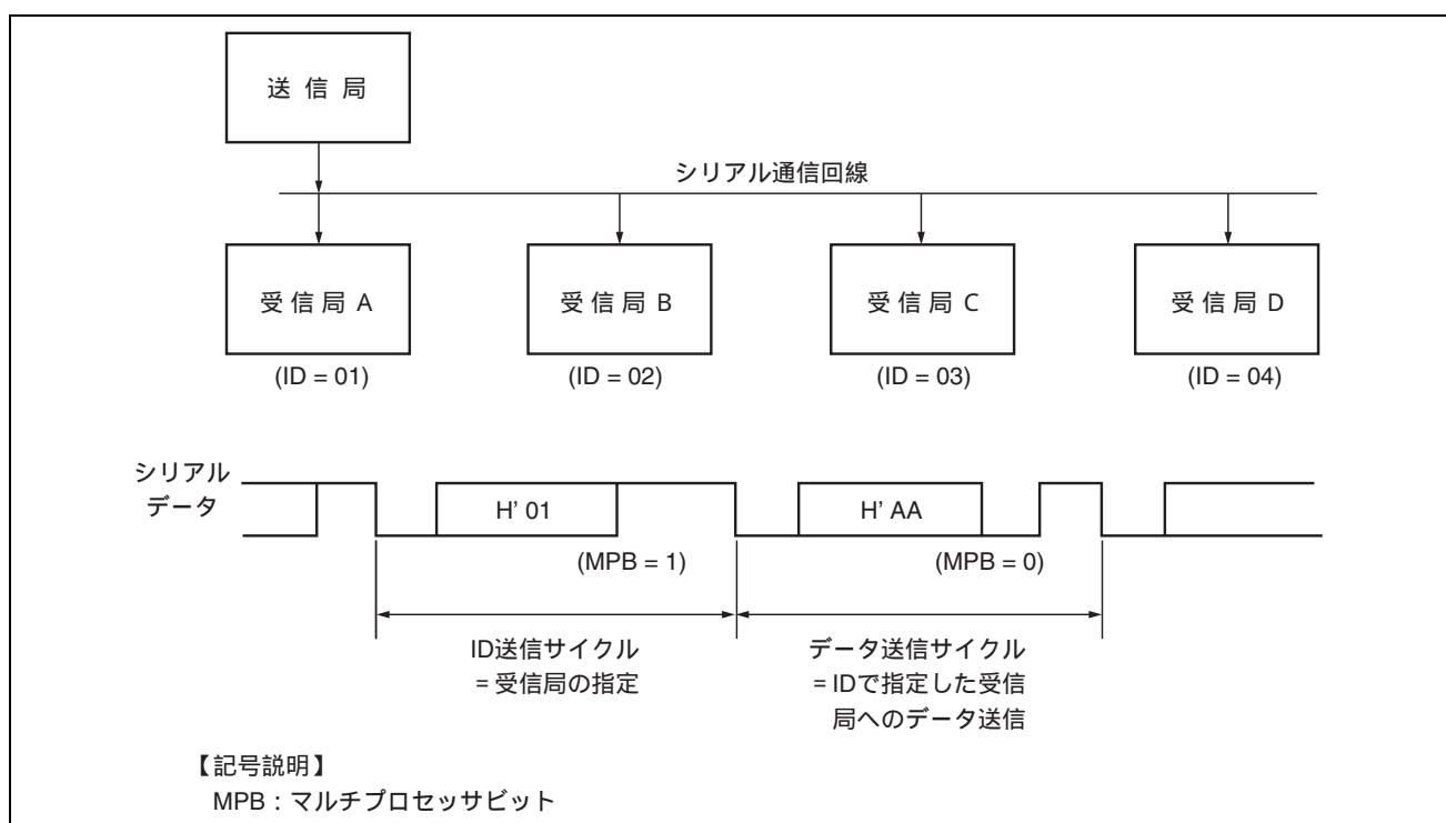
図 15.10 マルチプロセッサフォーマットを使用したプロセッサ間通信の例
