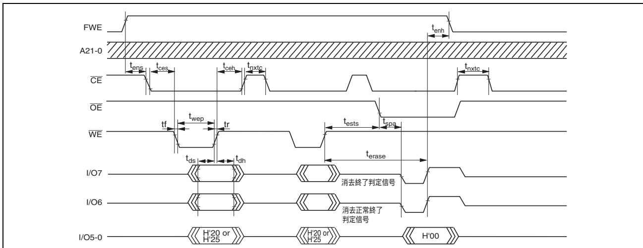
図 24.37 自動消去モードのタイミング波形
