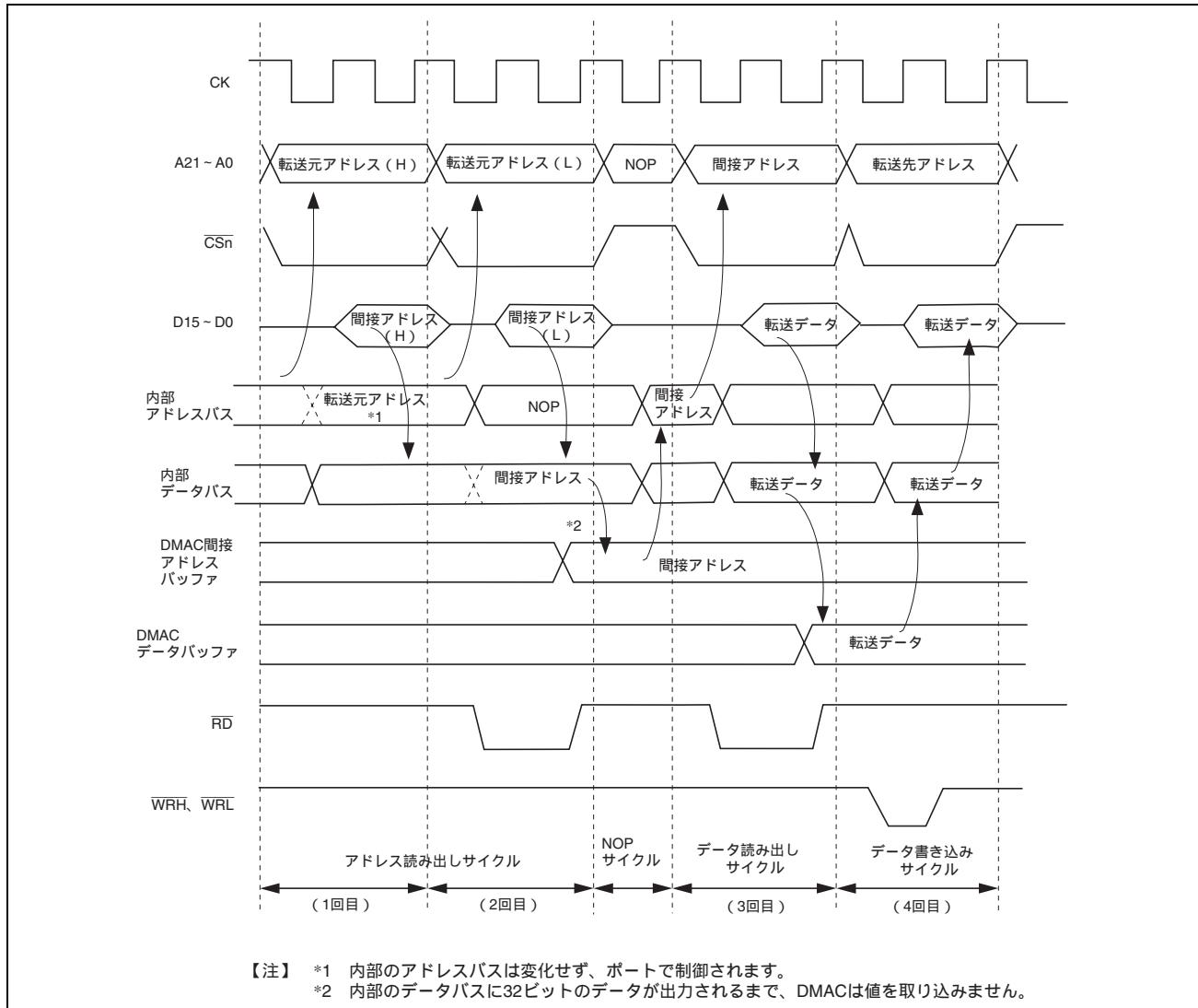
図 10.6 デュアルアドレスモード、間接アドレスでの転送タイミング例 (1)
