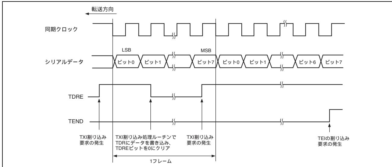
図 15.19 SCI の送信時の動作例
