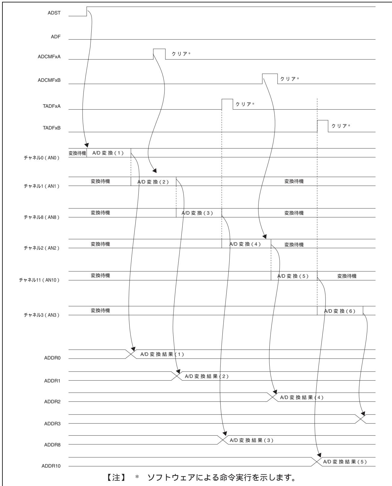
図 19.2 マルチトリガ A/D 動作例
