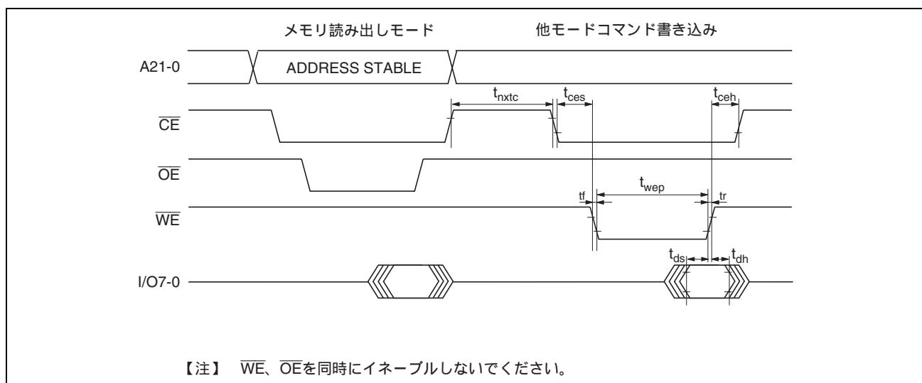
図 25.33 メモリ読み出しモードから他のモードへ遷移時のタイミング波形
