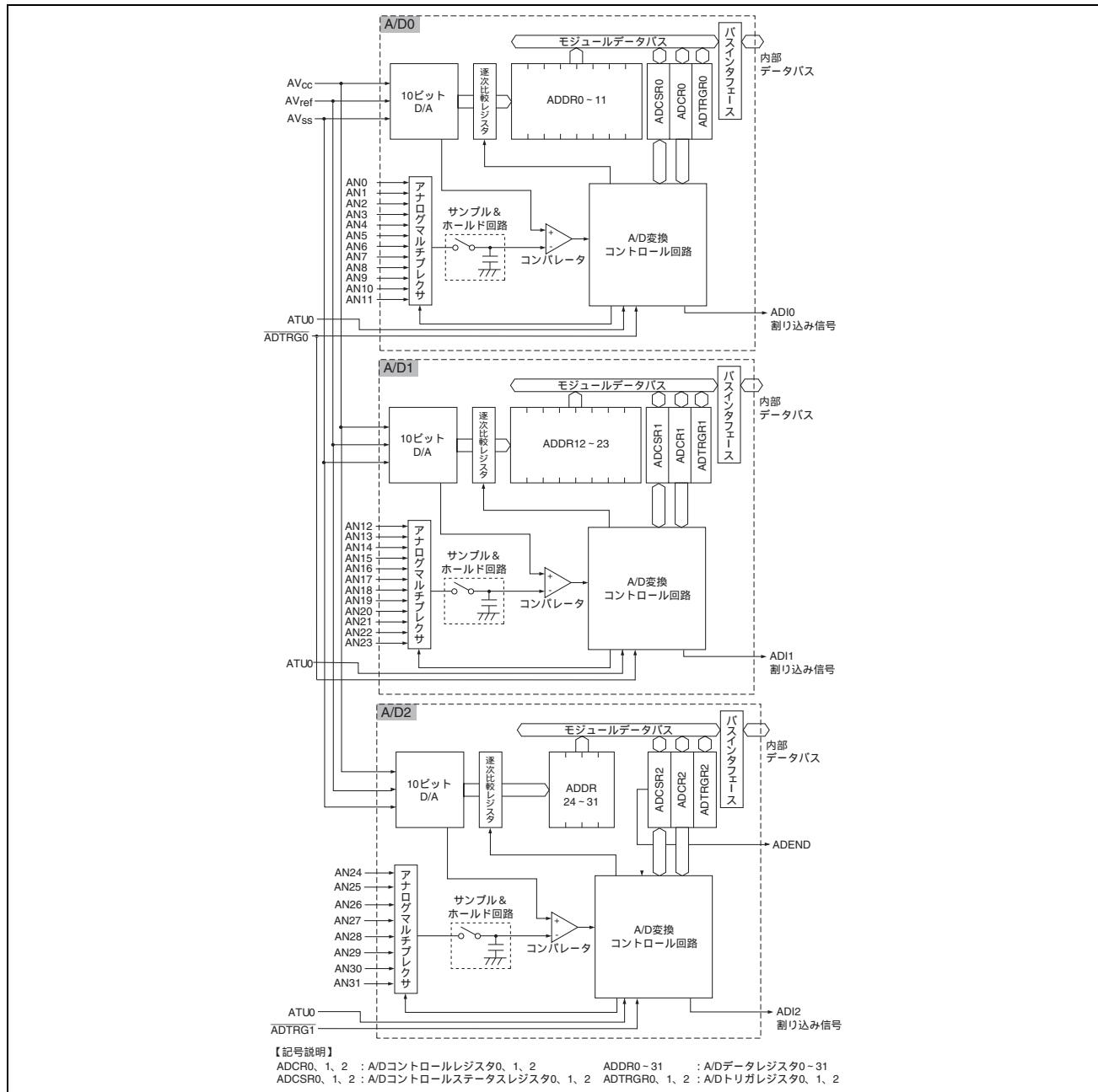
図 18.1 A/D 変換器のブロック図
