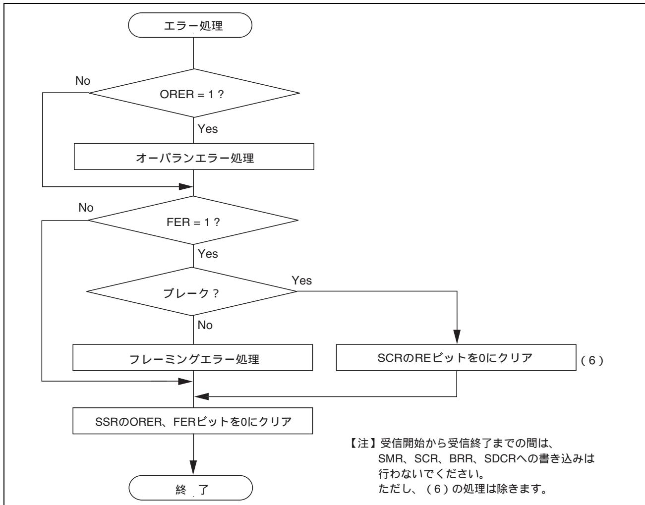
図 15.14 マルチプロセッサシリアル受信のフローチャートの例 (2)
