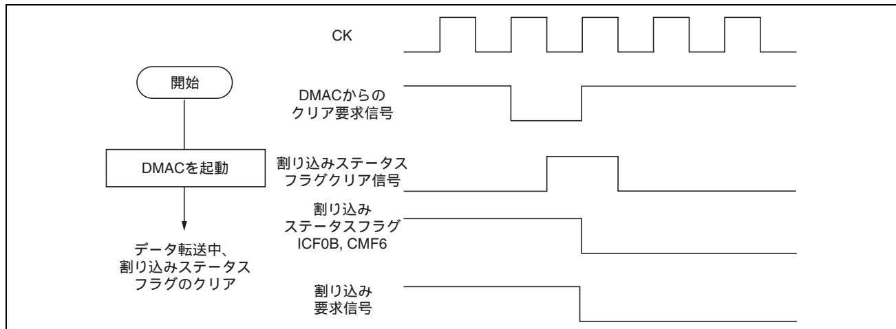
図 11.43 DMAC によるクリア手順とタイミング
