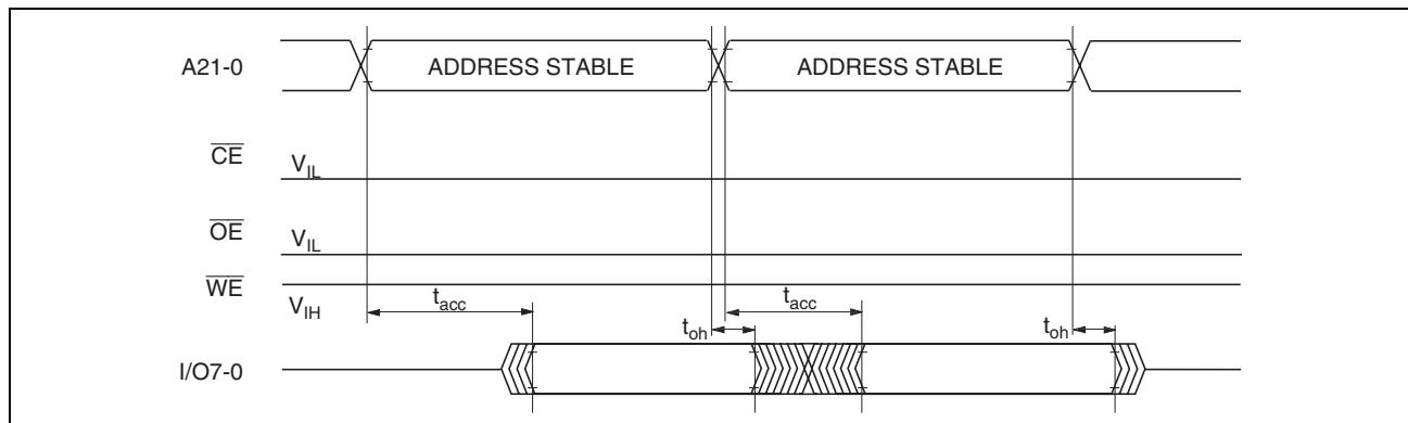
図 25.34 OE、OE イネーブル状態リード時のタイミング波形
