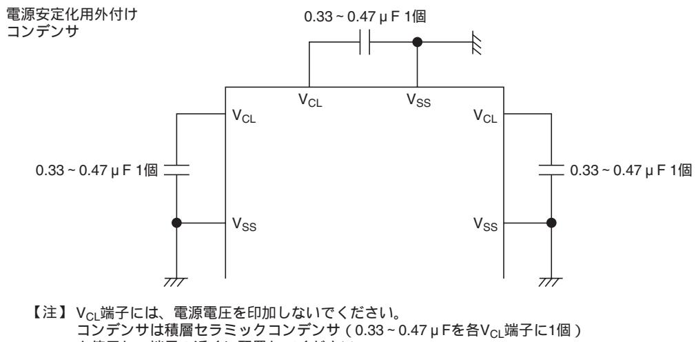
図 29.33  $V_{CL}$  コンデンサ接続方法
