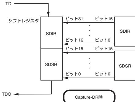
H-UDI割り込みモード時、H-UDI割り込みが発生し、TDOからSDTRF=1が読み出された後、Capture-DRでSDDRHとSDDLRLがシフトレジスタへ取り込まれ、Shift-DRでTDOよりSDDLRLのビット0からビット15、SDDRHのビット0からビット15の順に出力されます。
