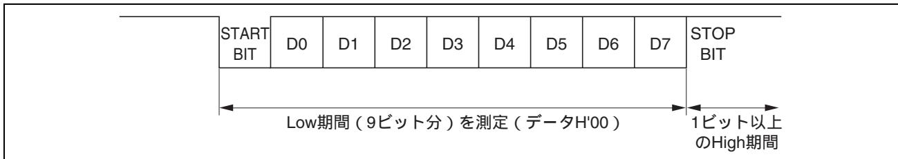
図 25.7 SCI ビットレートの自動合わせ込み動作
