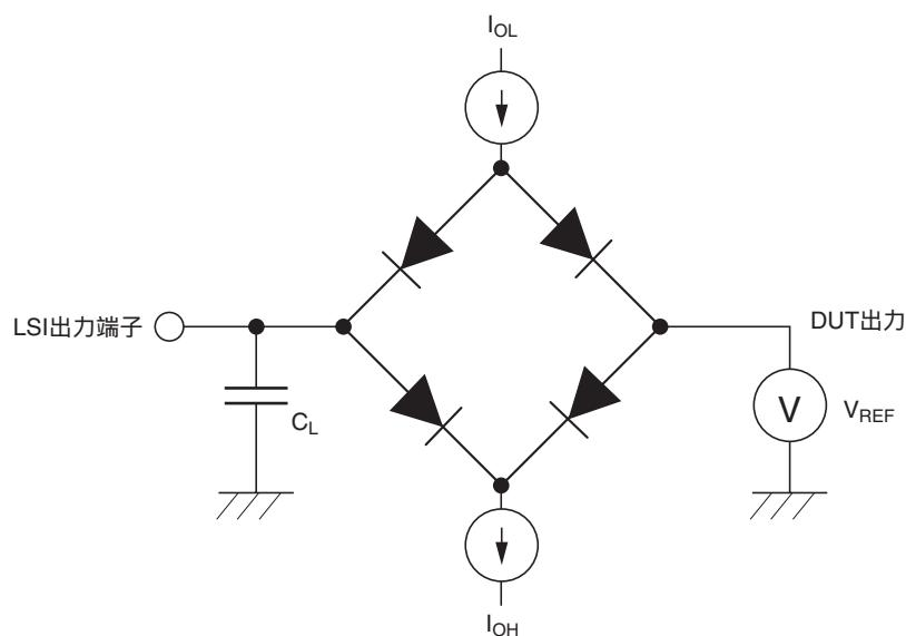
【注】 $C_L$ は測定治具等の容量も含んだ合計値で、各端子により、以下のように設定されています。
