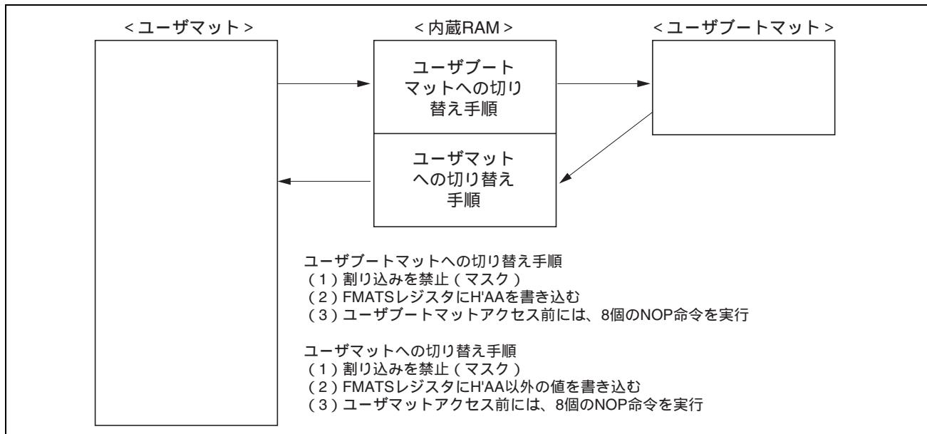
図 24.20 ユーザマット / ユーザブートマットの切り替え
