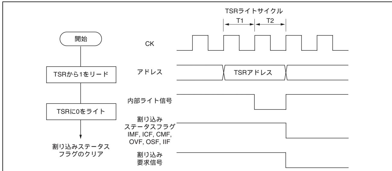
図 11.42 CPU プログラムによるクリア手順とタイミング
