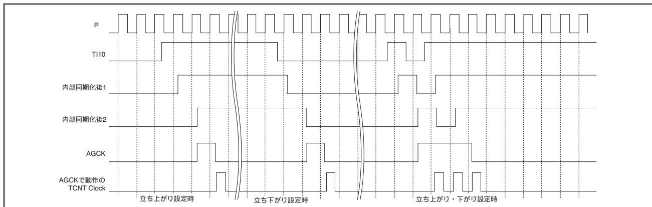
図 11.26 エッジ入力動作 (ノイズキャンセルなし)
