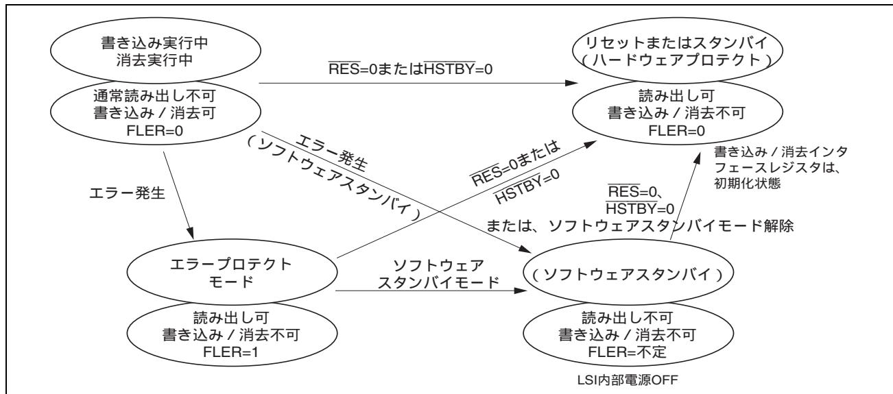
図 24.16 エラープロテクト状態への状態遷移図
