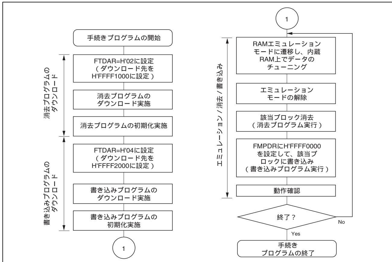
図 24.13 RAM エミュレーション、消去、書き込みの繰り返し例 ( 概要 )
