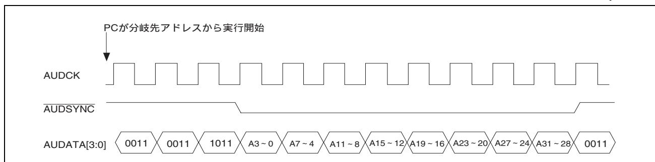
図 21.2 データ出力例 (32 ビット出力) \*
