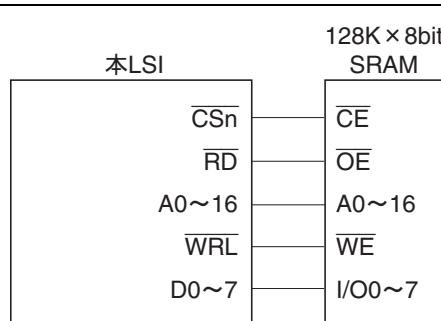
図 9.12 8 ビットデータバス幅 SRAM 接続例
