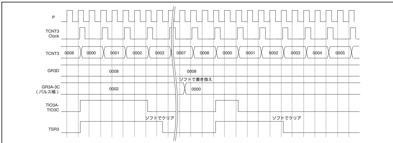
図 11.23 チャネル3~5のPWMモード動作
