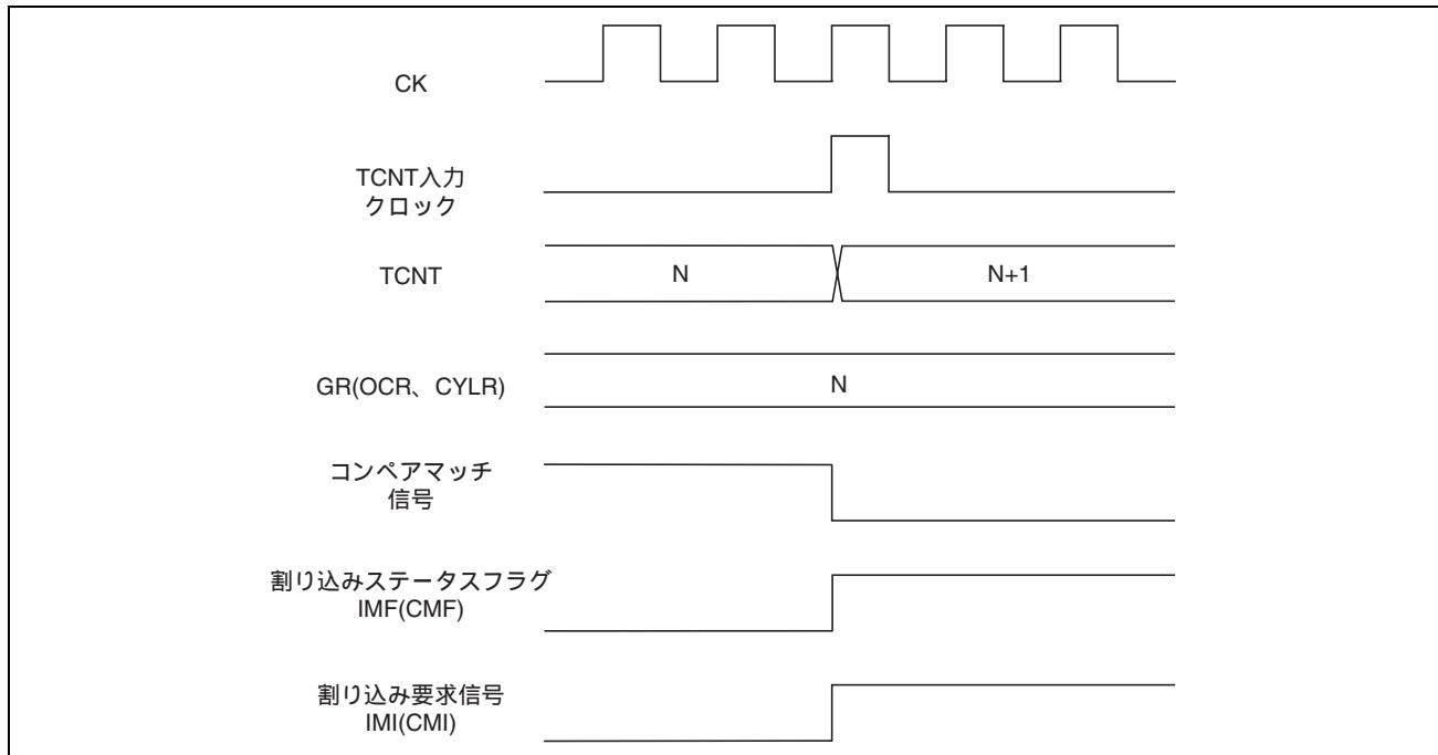
図 11.38 コンペアマッチ時の IMF ( CMF ) のセットタイミング
