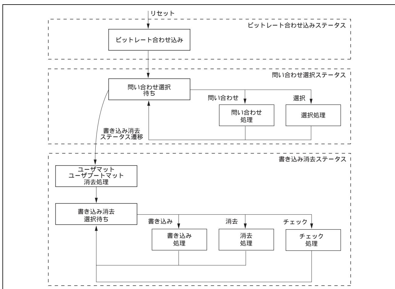
図24.26 ブートプログラムの処理フロー
