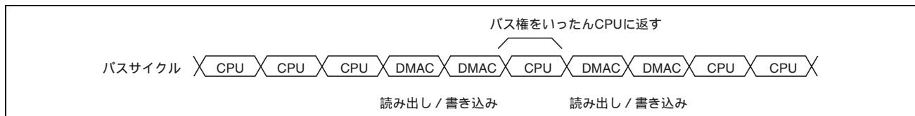
図 10.8 サイクルスチールモードでの DMA 転送例
