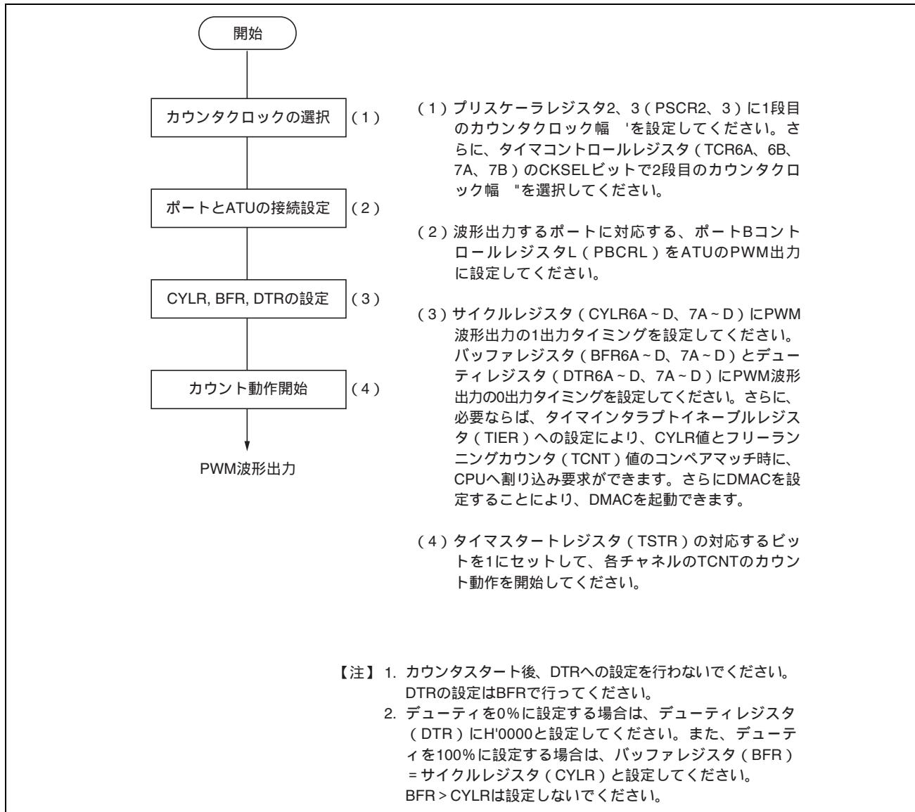
図 11.60 PWM タイマ ( ch6、7 ) 動作の設定手順例
