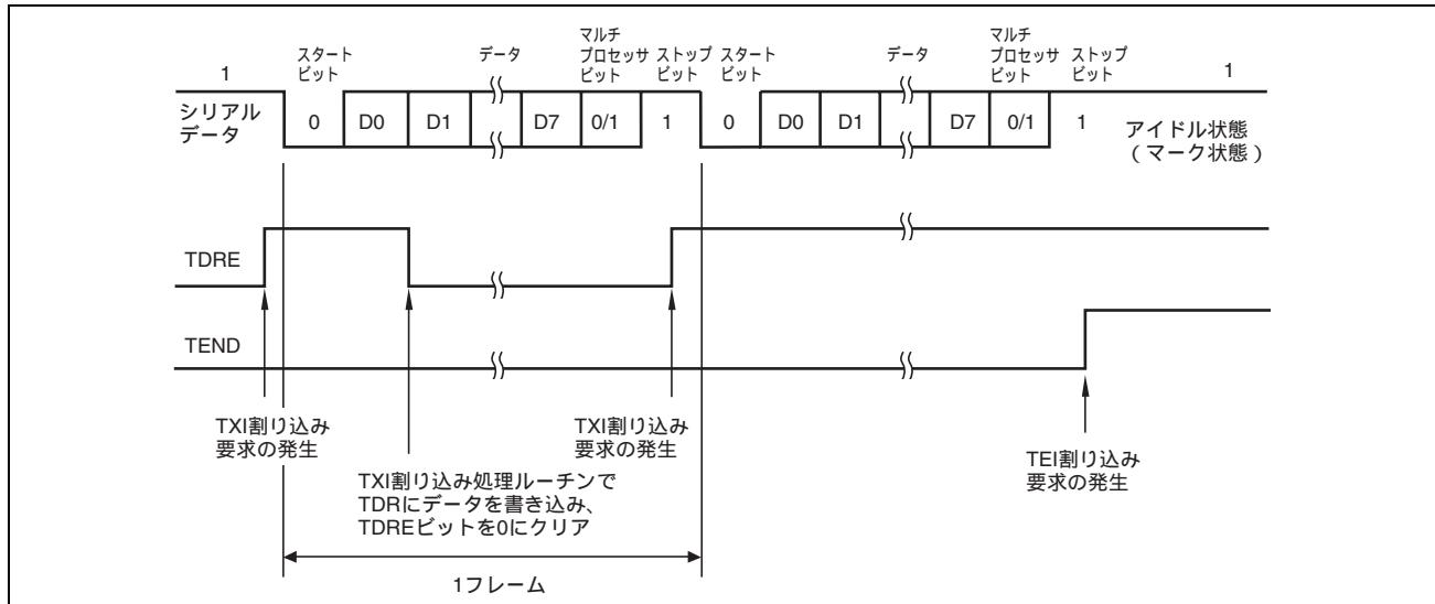
図 15.12 SCI の送信時の動作例 (8 ビットデータ / マルチプロセッサビットあり / 1 ストップビットの例)
