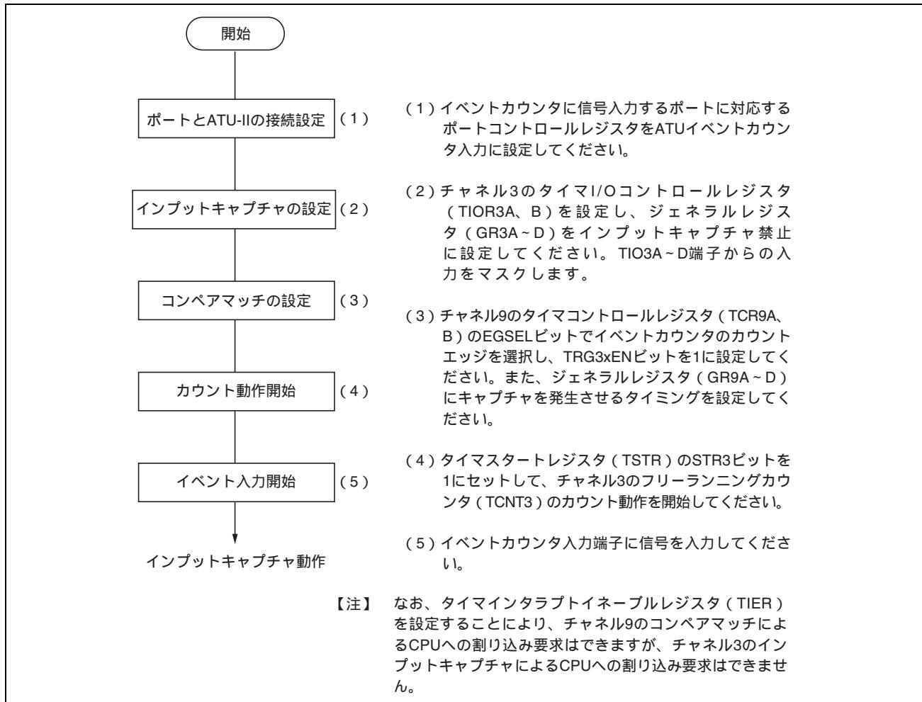
図 11.62 コンペアマッチ信号の送信動作の設定手順例
