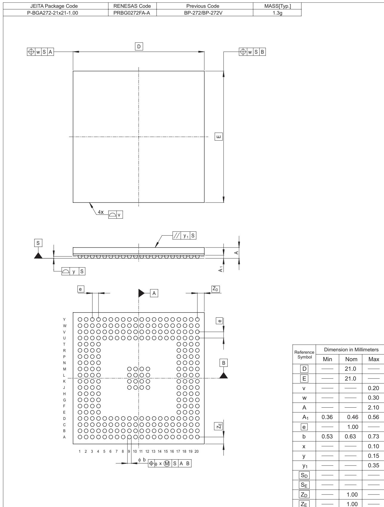
図 D.2 外形寸法図 ( BP-272 )
