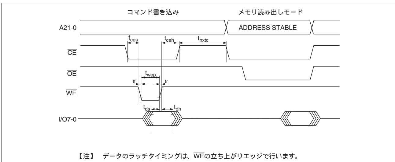
図 25.32 コマンド書き込み後メモリ読み出しタイミング図
