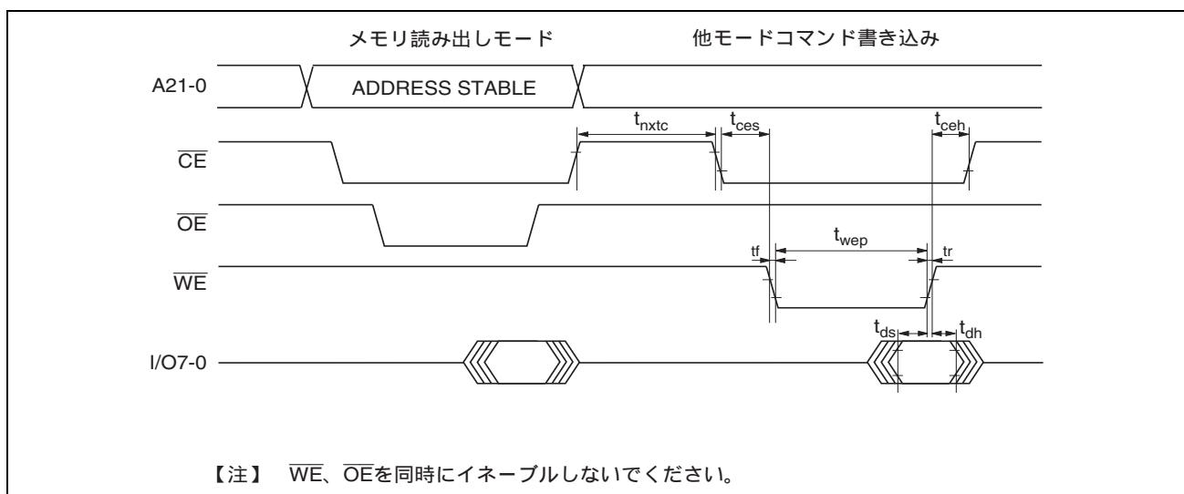
図 24.33 メモリ読み出しモードから他のモードへ遷移時のタイミング波形
