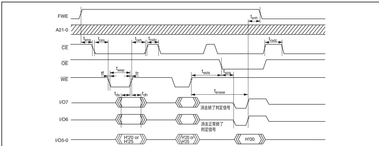
図 25.37 自動消去モードのタイミング波形
