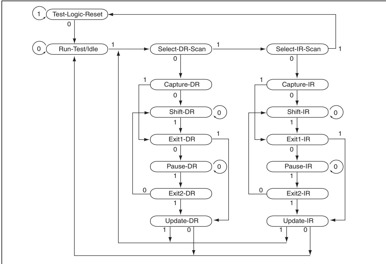
図 20.2 TAP コントローラ状態遷移図
