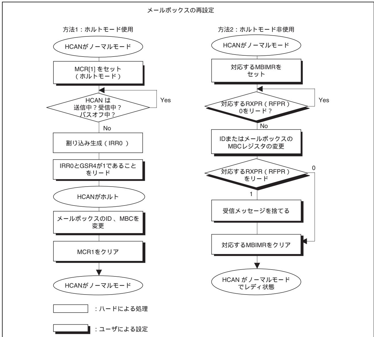
図 17.12 受信ボックスの ID 変更 / 送信ボックスから受信ボックスへの変更
