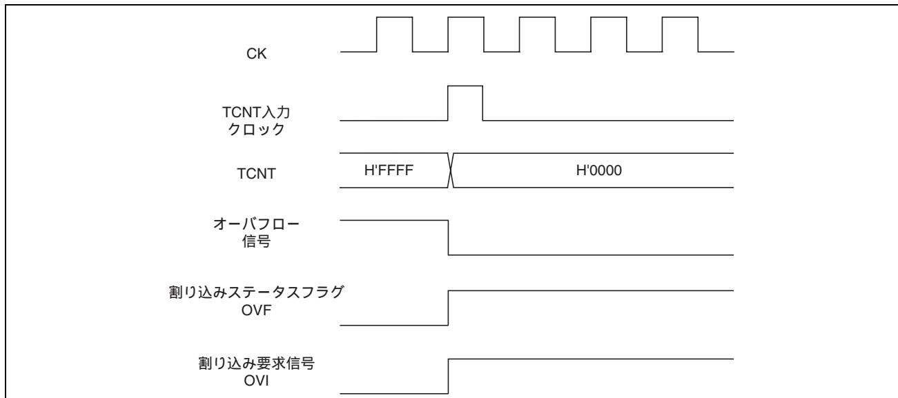
図 11.39 オーバフロー時の OVF のセットタイミング
