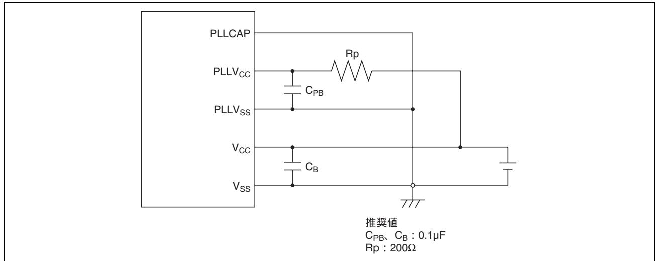
図 5.7 PLL 用電源接続時の注意
