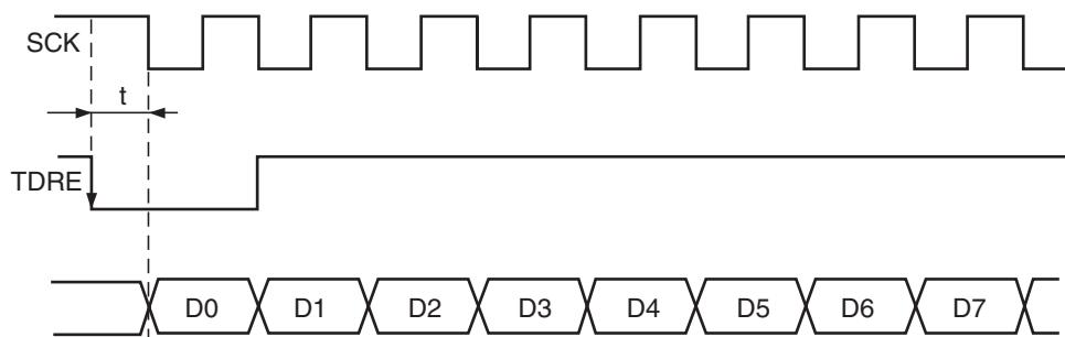
外部クロック動作時には、上図の  $t = 4P$  クロックのとき誤動作が発生します。
