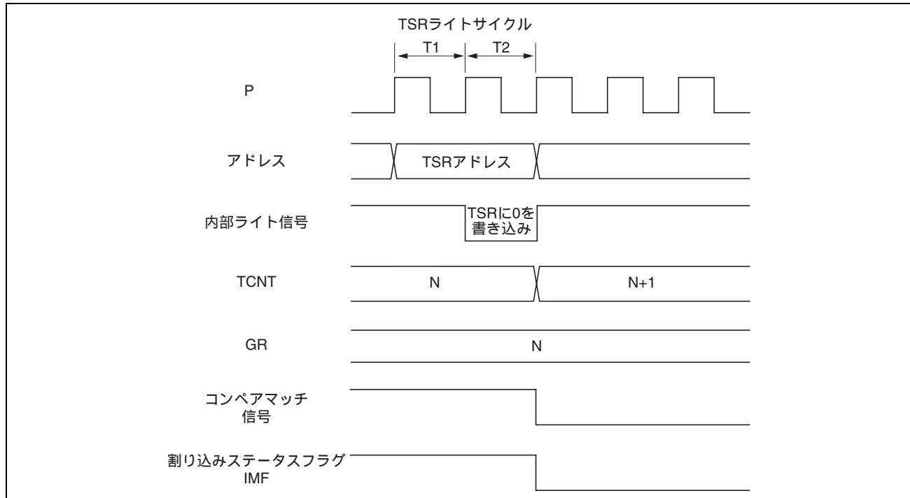
図 11.67 コンペアマッチによる割り込みステータスフラグのセットとクリアの競合
