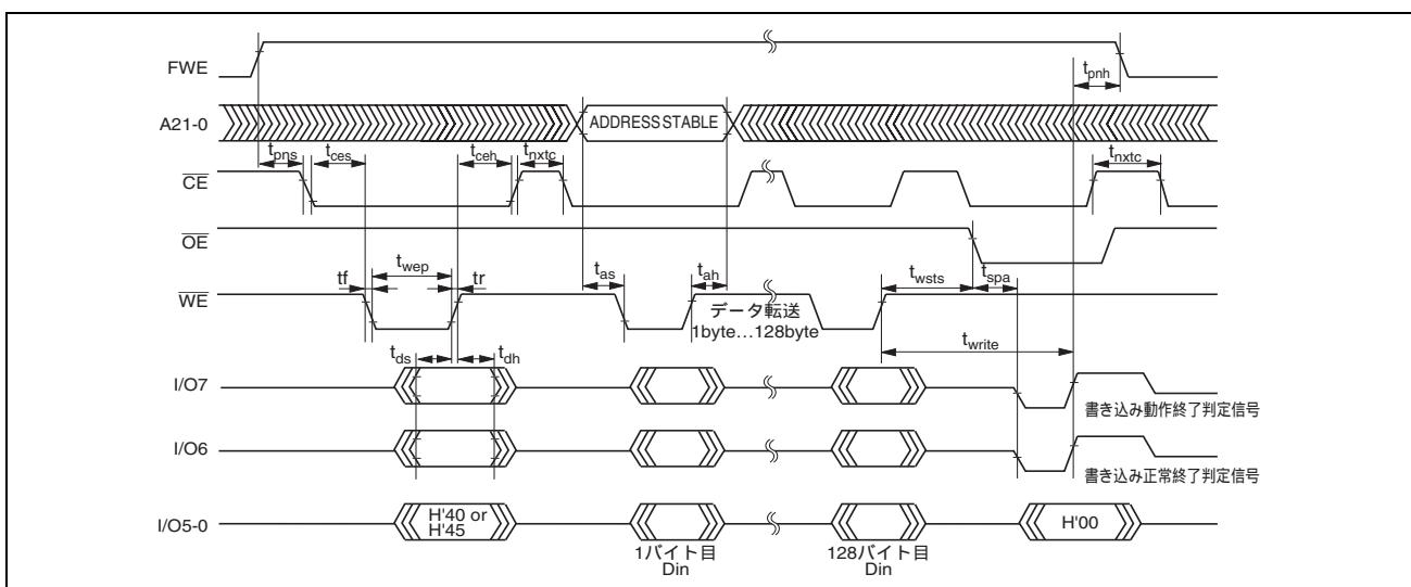
図 24.36 自動書き込みモードのタイミング波形
