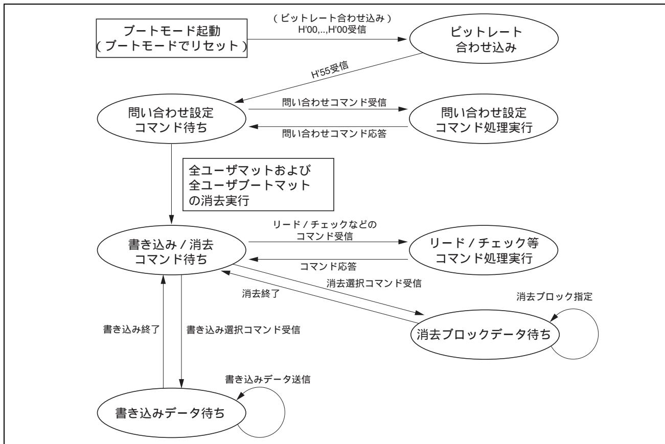
図 25.8 ブートモードの状態遷移の概略図
