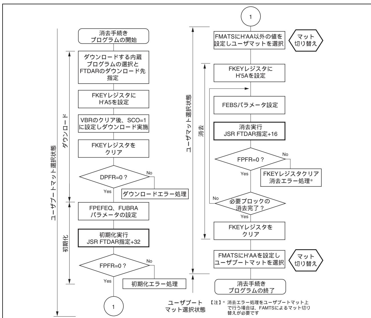
図 25.15 ユーザブートモードでのユーザマットの消去手順
