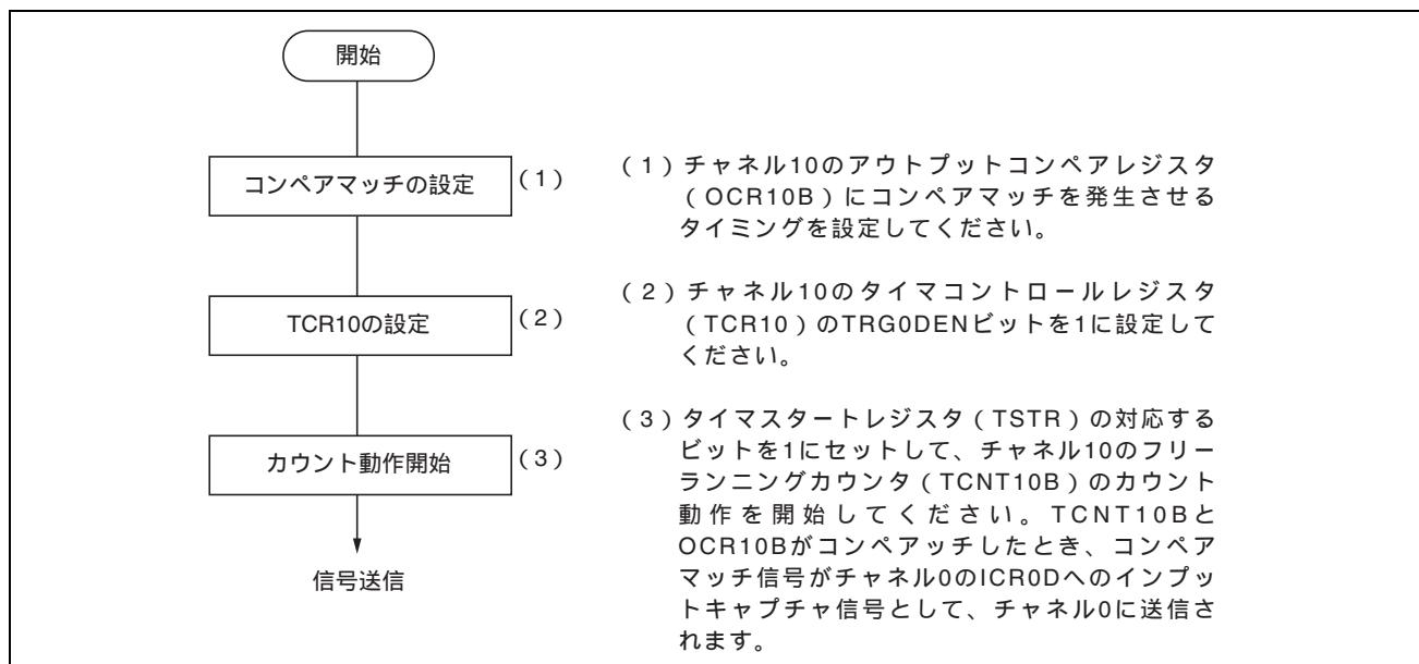
図 11.55 コンペアマッチ信号の送信動作の設定手順例
