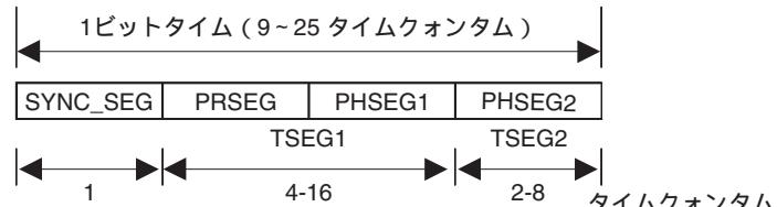
SYNC\_SEG : CAN バス上のノードの同期を確立するセグメント (通常のビットエッジ遷移がこのセグメントで発生します。)
