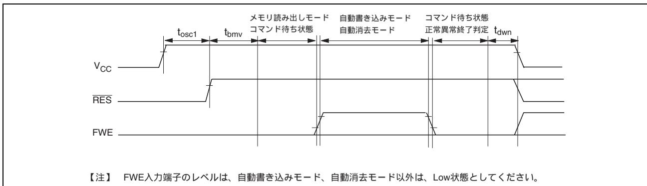
図 25.39 発振安定時間、ライタモードセットアップ時間、電源立ち下げシーケンス
