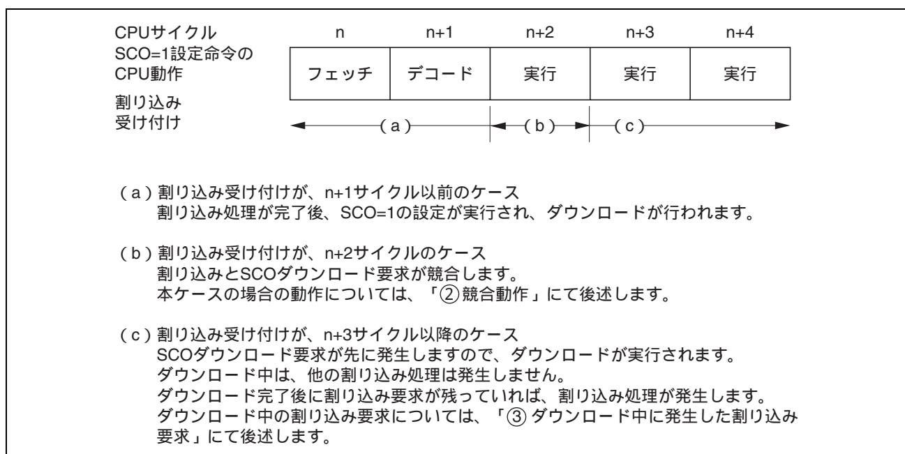
図 25.21 SCO ダウンロード要求と割り込み要求の競合タイミング
