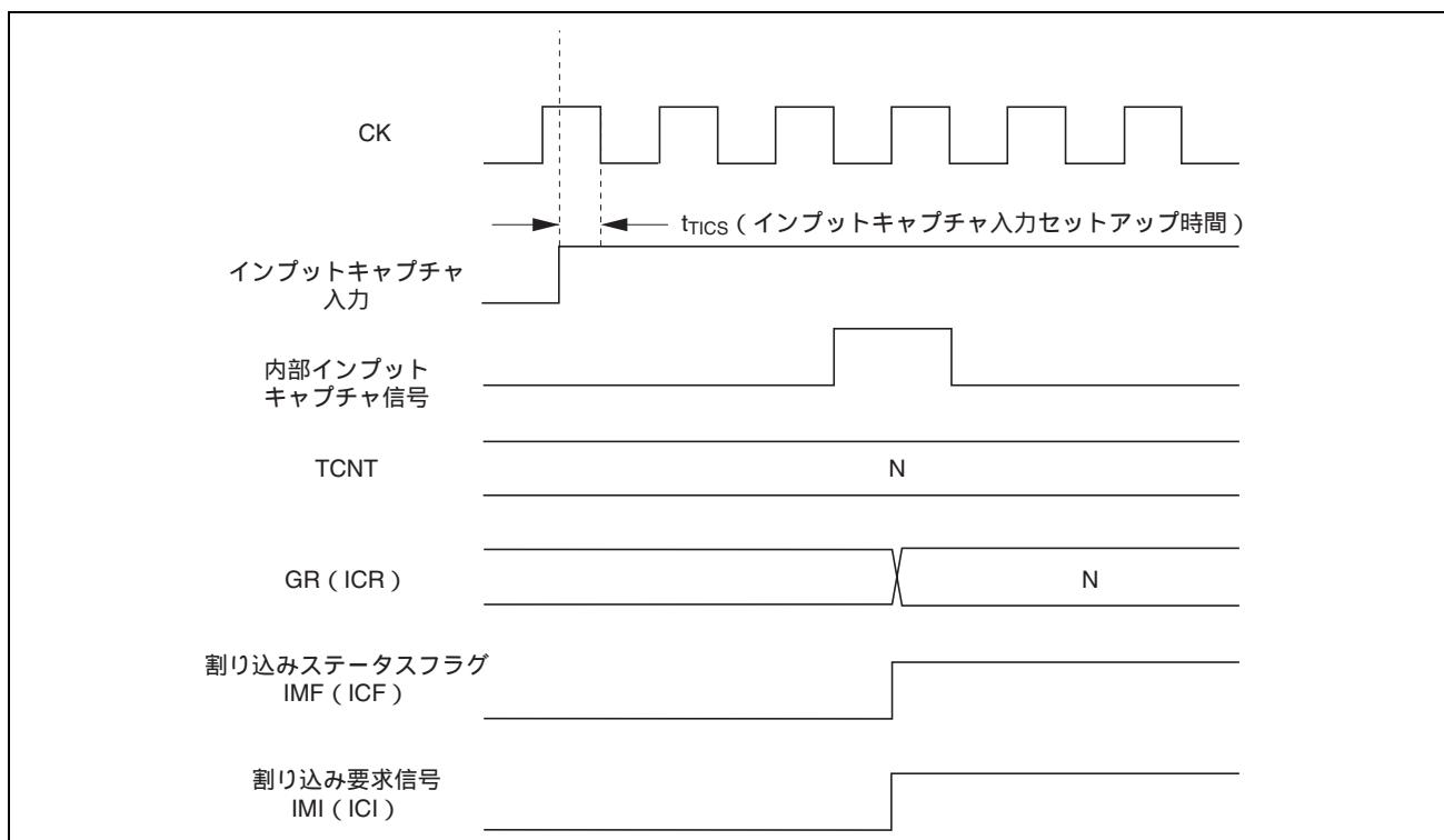
図 11.37 インプットキャプチャ時の IMF ( ICF ) のセットタイミング
