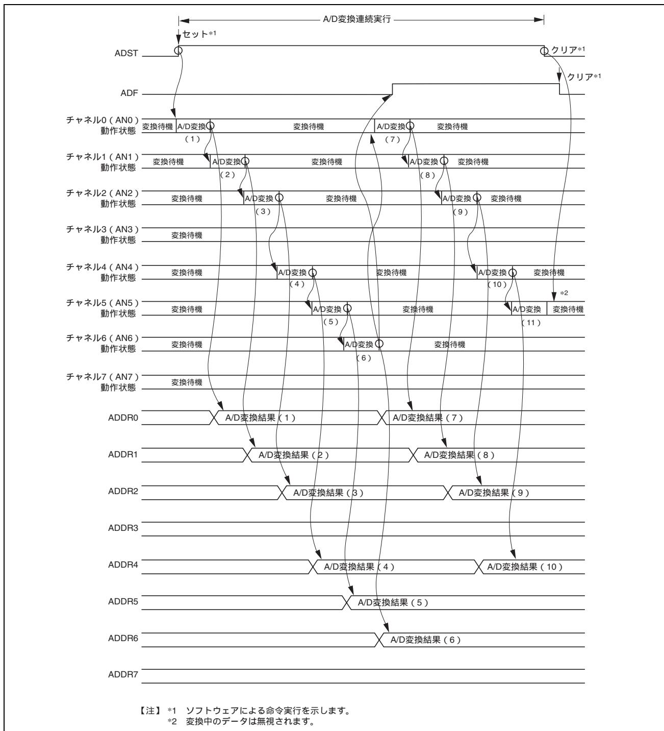
図 18.5 A/D 変換器の動作例 (スキャンモード (連続スキャン) チャネル AN0~2、AN4~6 の選択時 )
