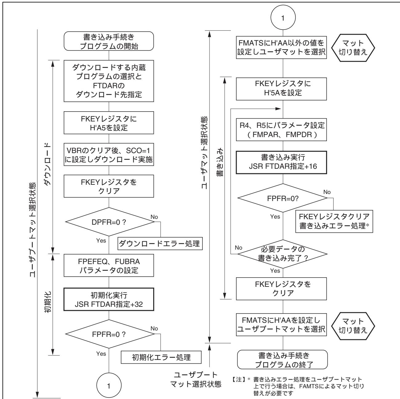
図 25.14 に示したように、ユーザプログラムモードとユーザブートモードでの書き込み手続きの違いは、マット切り替えを行うか否かです。
