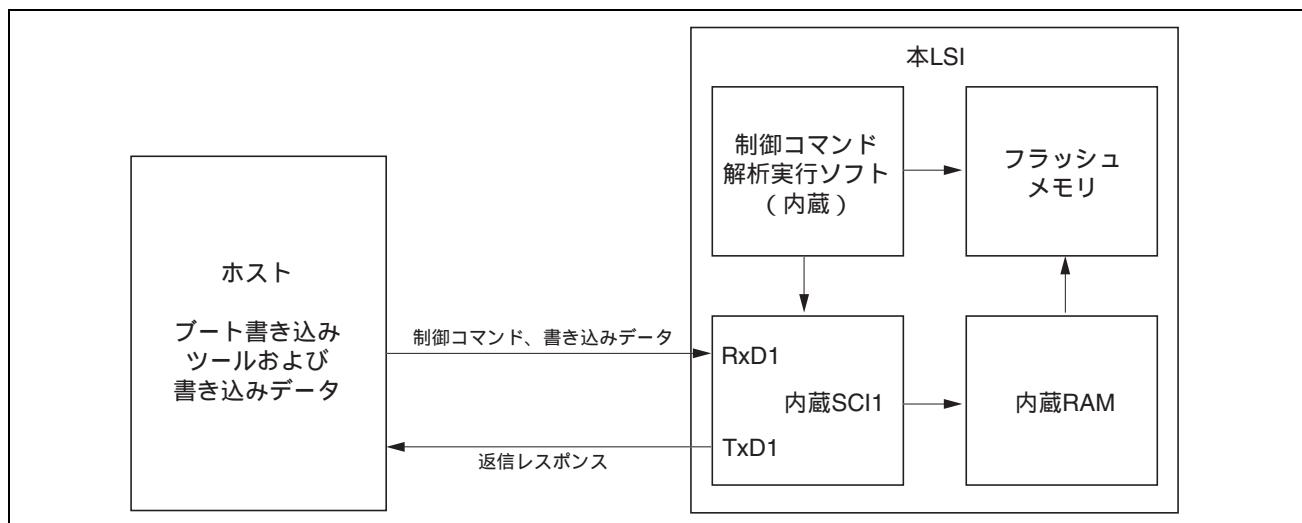
図25.6 ブートモード時のシステム構成図
