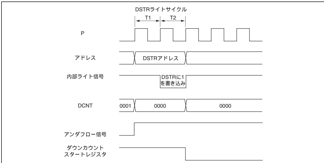
図 11.73 CPU からの DSTR の 1 セットとアンダフローによる 0 クリア競合
