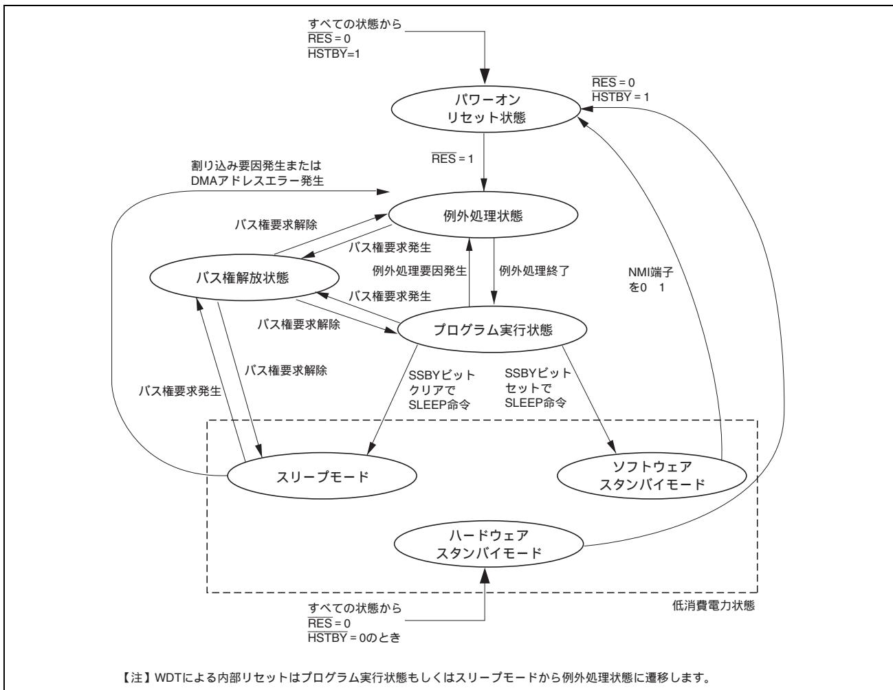
図2.8 処理状態の状態遷移図
