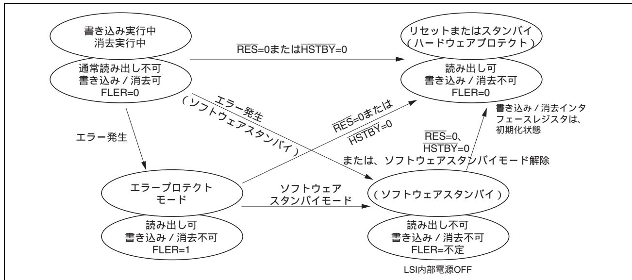
図 25.16 エラープロテクト状態への状態遷移図
