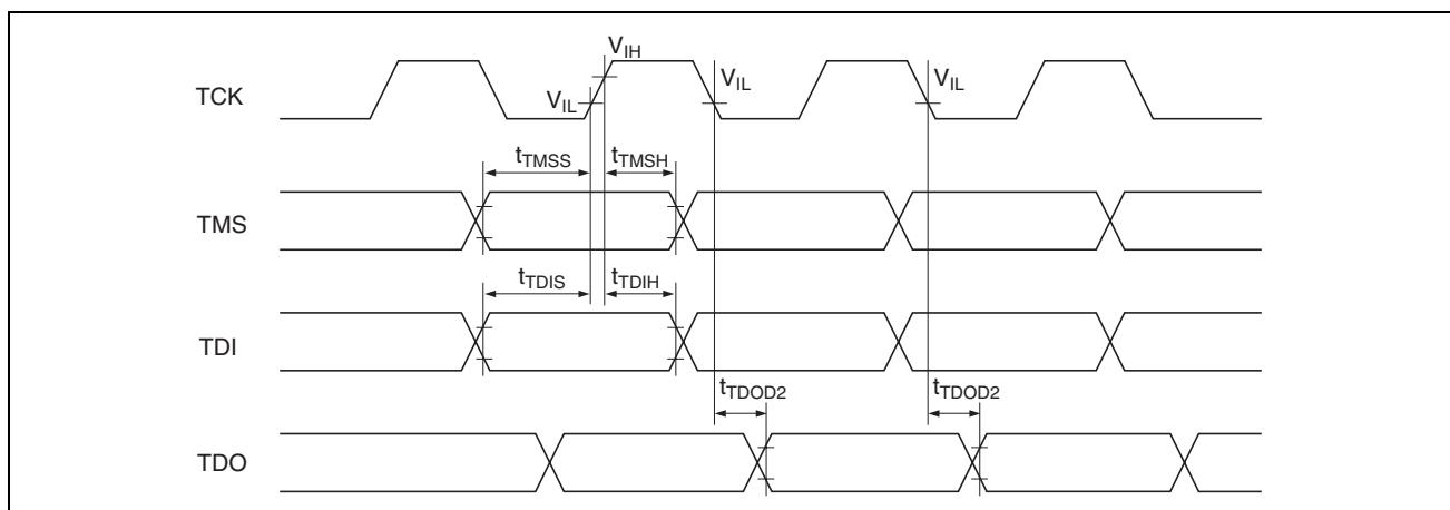
図 29.25 H-UDI 入出力タイミング (IEEE1149.1 対応のインストラクション実行時)
