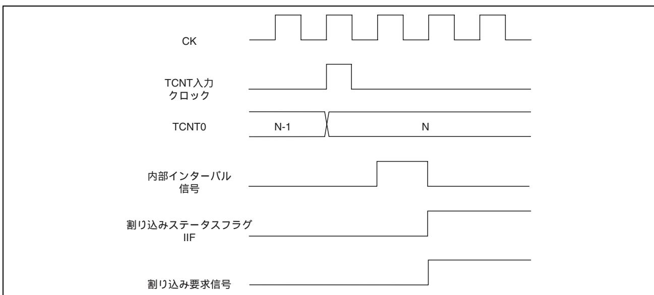
図 11.41 インターバルタイマによる IIF のセットタイミング
