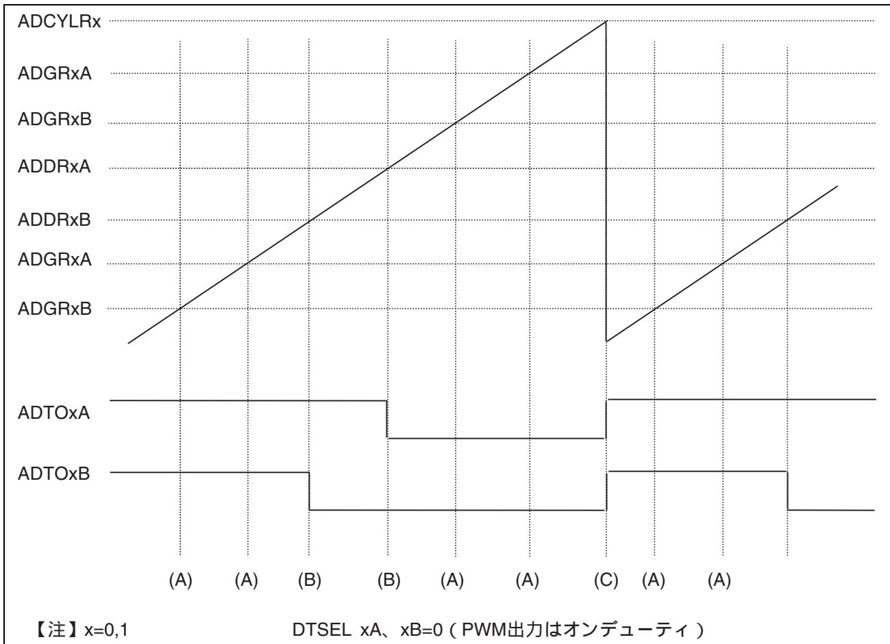
図 19.4 MTAD PWM 波形出力例
