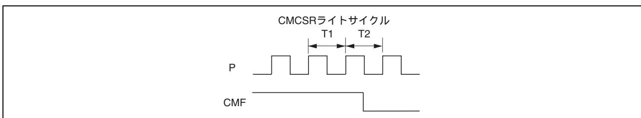
図 14.5 CPU による CMF のクリアタイミング
