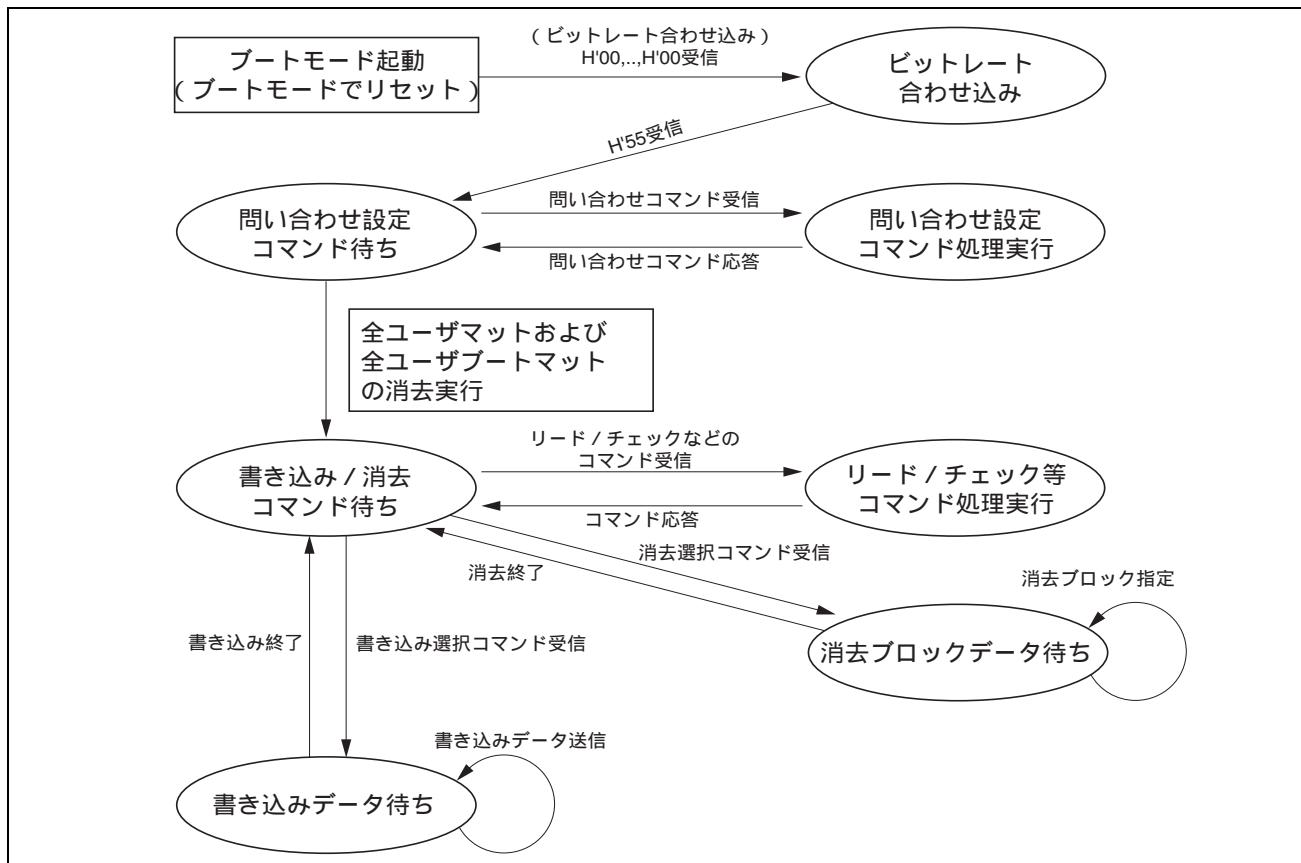
図 24.8 ブートモードの状態遷移の概略図
