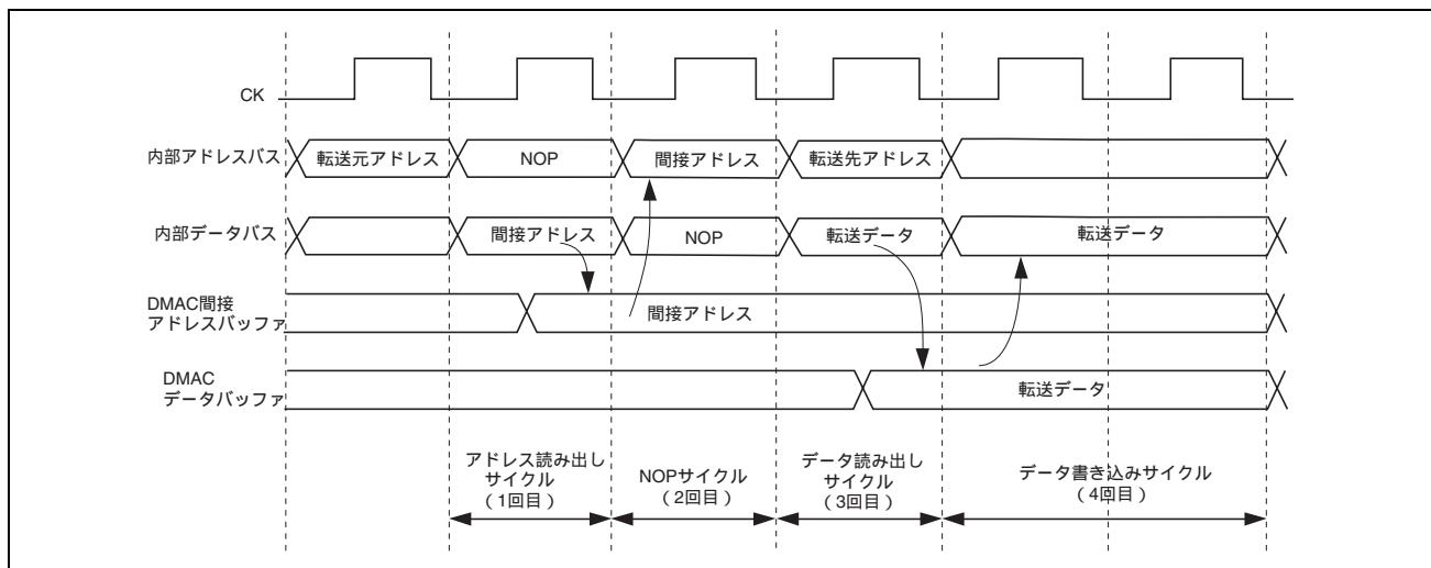
図 10.7 デュアルアドレスモード、間接アドレスでの転送タイミング例(2)
