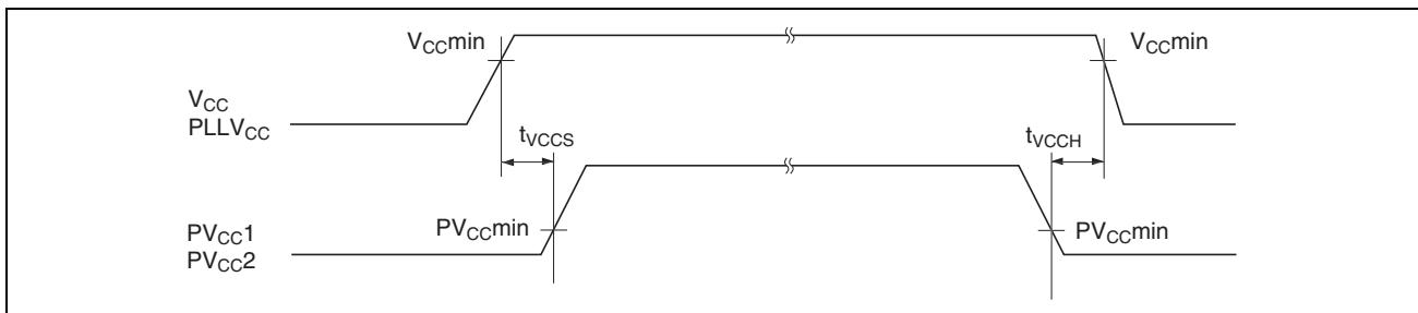
図 29.1 電源投入・切断タイミング
