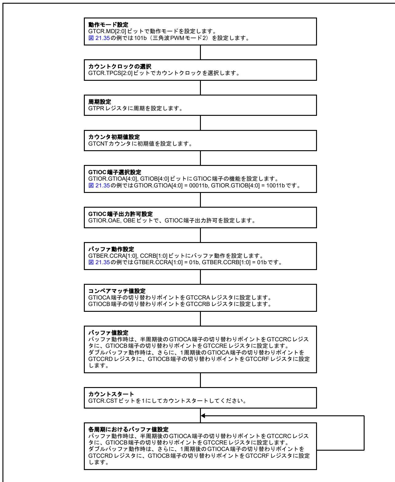
図 21.36 三角波 PWM モード 2 設定例
