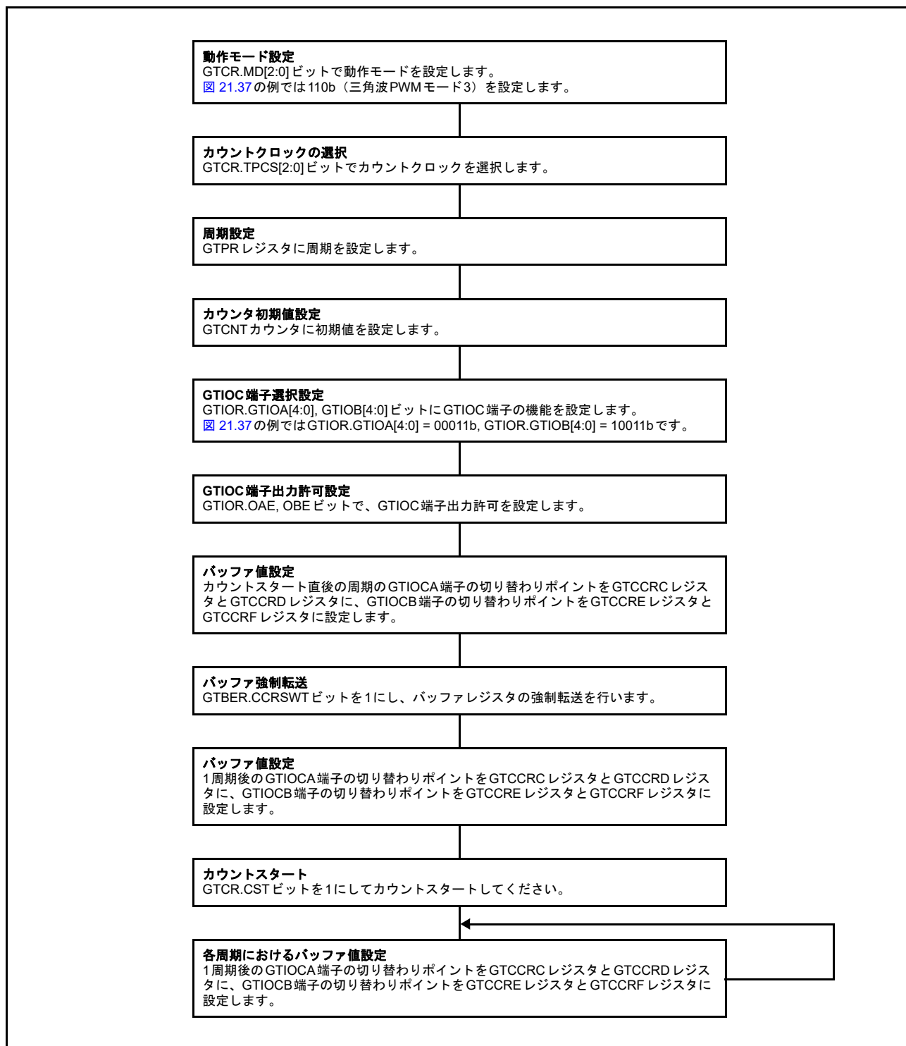
図 21.38 三角波 PWM モード 3 設定例
