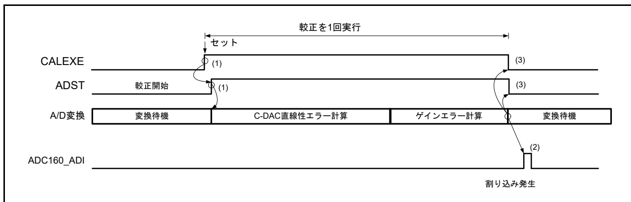
図 32.34 キャリブレーション動作例 (C-DAC 直線性誤差計算およびゲイン誤差計算)
