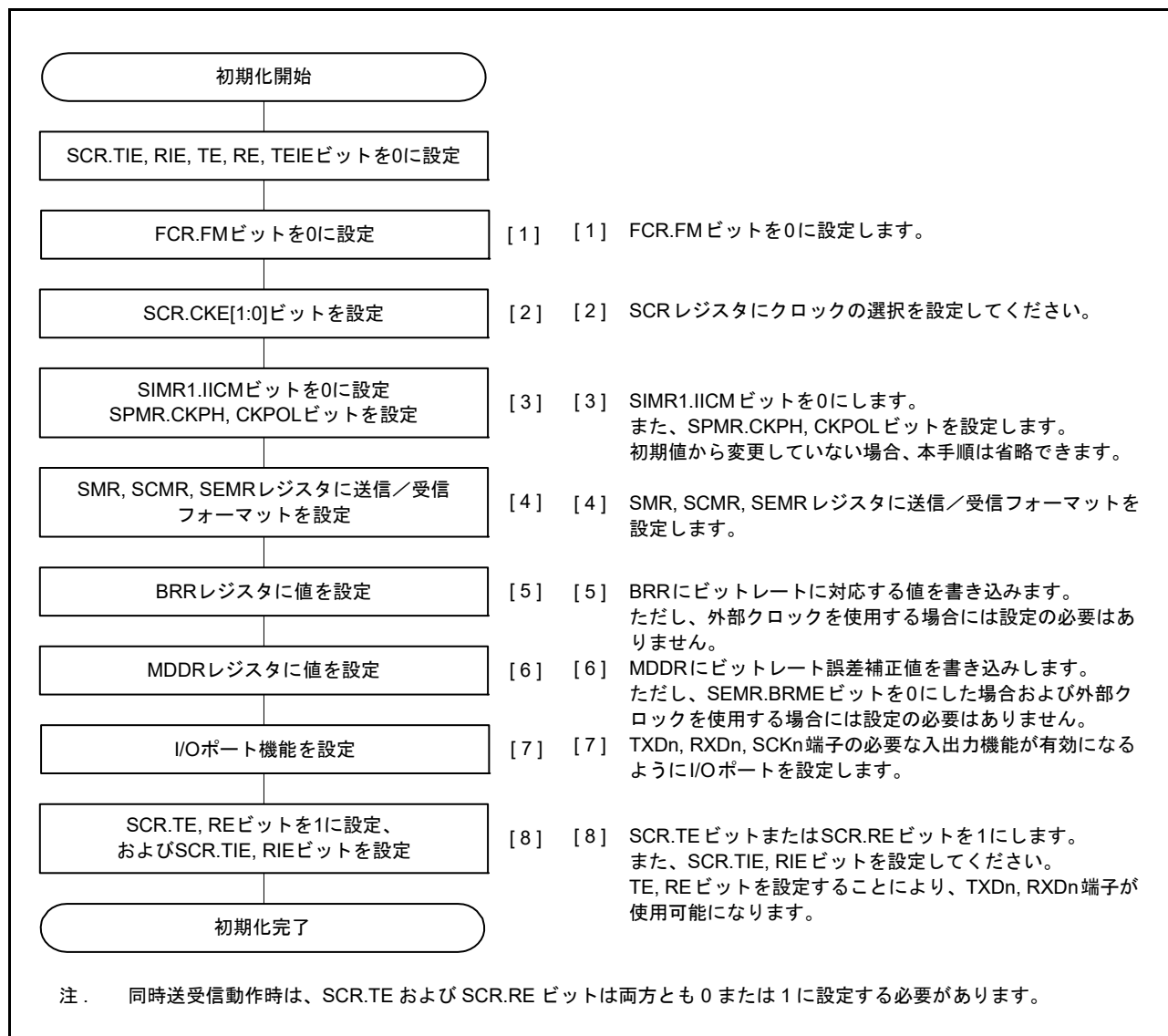
図 27.32 クロック同期式モードにおける SCI の初期化フローチャート例 (非 FIFO 選択時)
