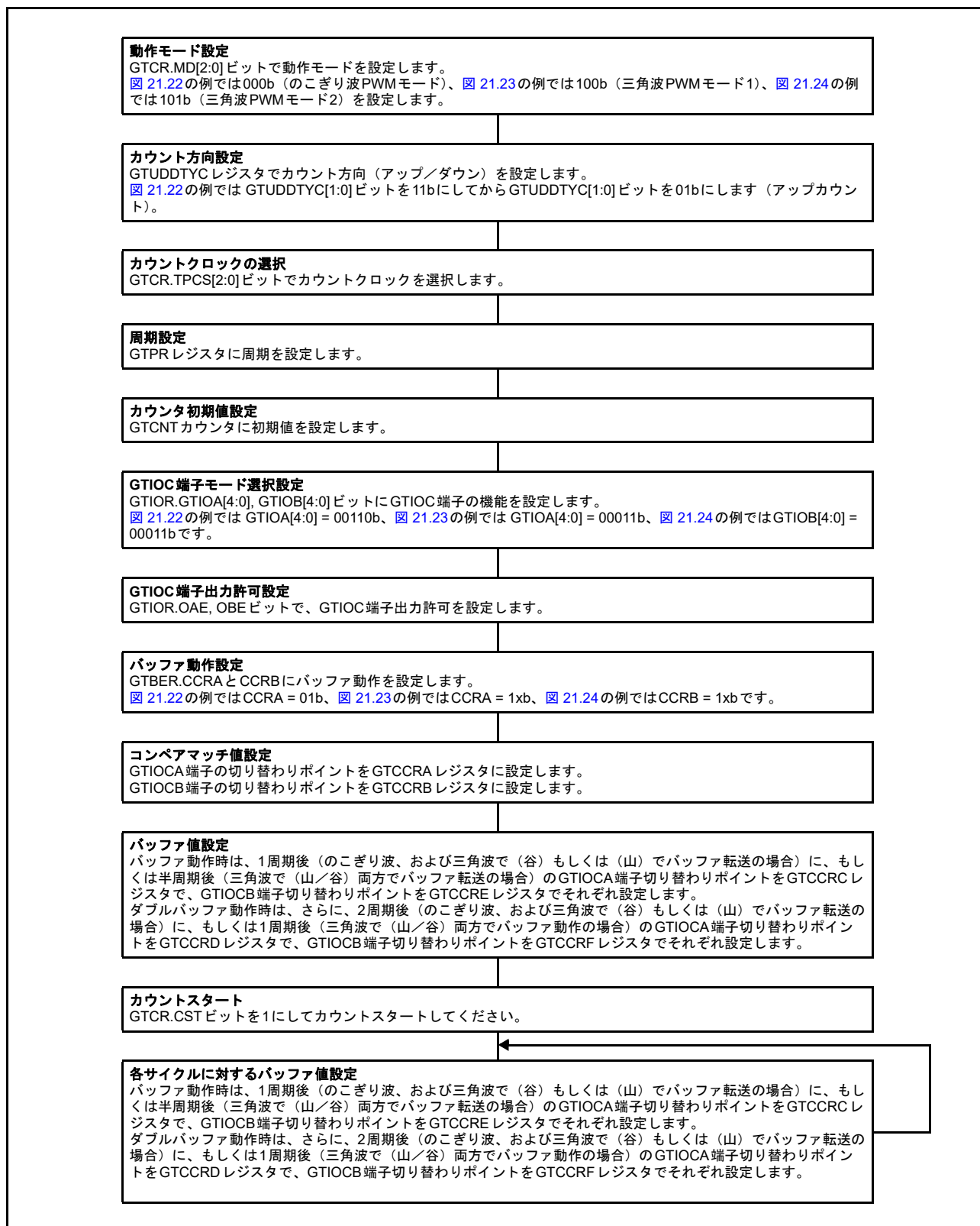
図 21.25 GTCRA、GTCCRB レジスタのバッファ動作設定例 (アウトプットコンペア時)
