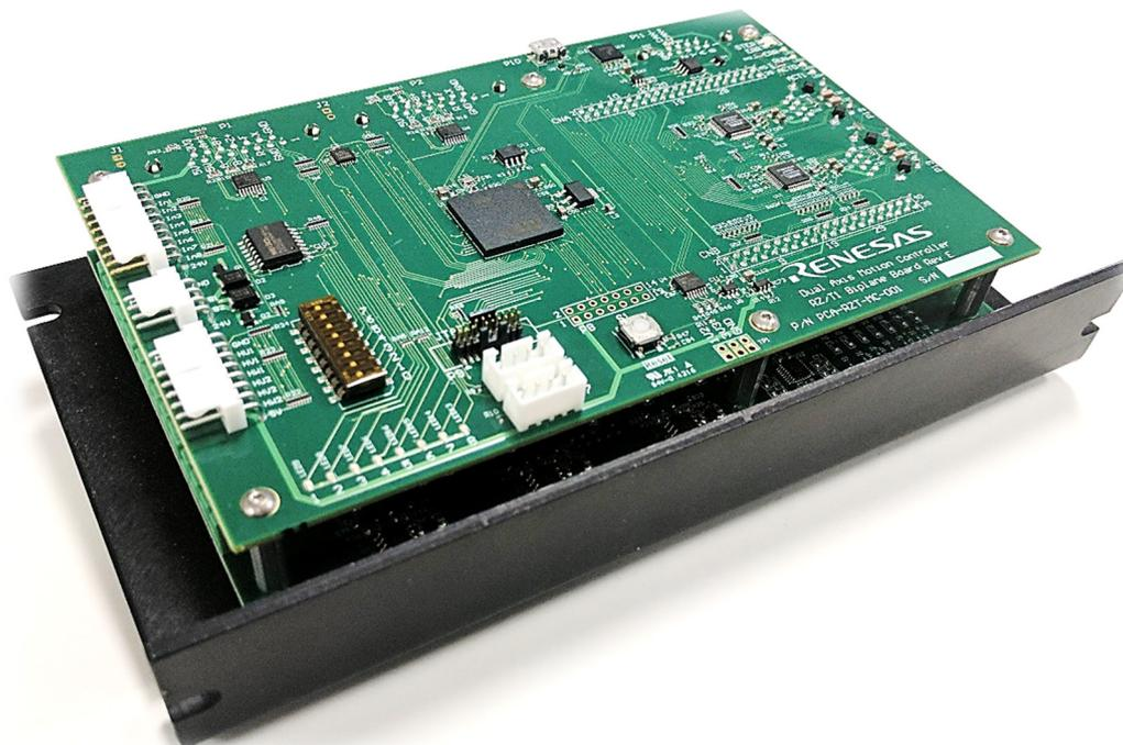
コントローラは、2枚のボードで構成されています。上段のボードは、RZ/T1 を搭載するモーションコントローラで、2つの 40 ピンヘッダを介してデュアルチャネルのインバータと接続しています。コントローラボードは、デュアルユニバーサルエンコーダインタフェース、USB/RS232/RS422/CAN バス用シリアルインタフェース、EtherCAT<sup>®</sup>(\*1)、PROFINET、EtherNet/IP<sup>™</sup>(\*2)、Ethernet (\*3) 接続インタフェース、デジタル入出力および JTAG デバッグポートを搭載しています。
