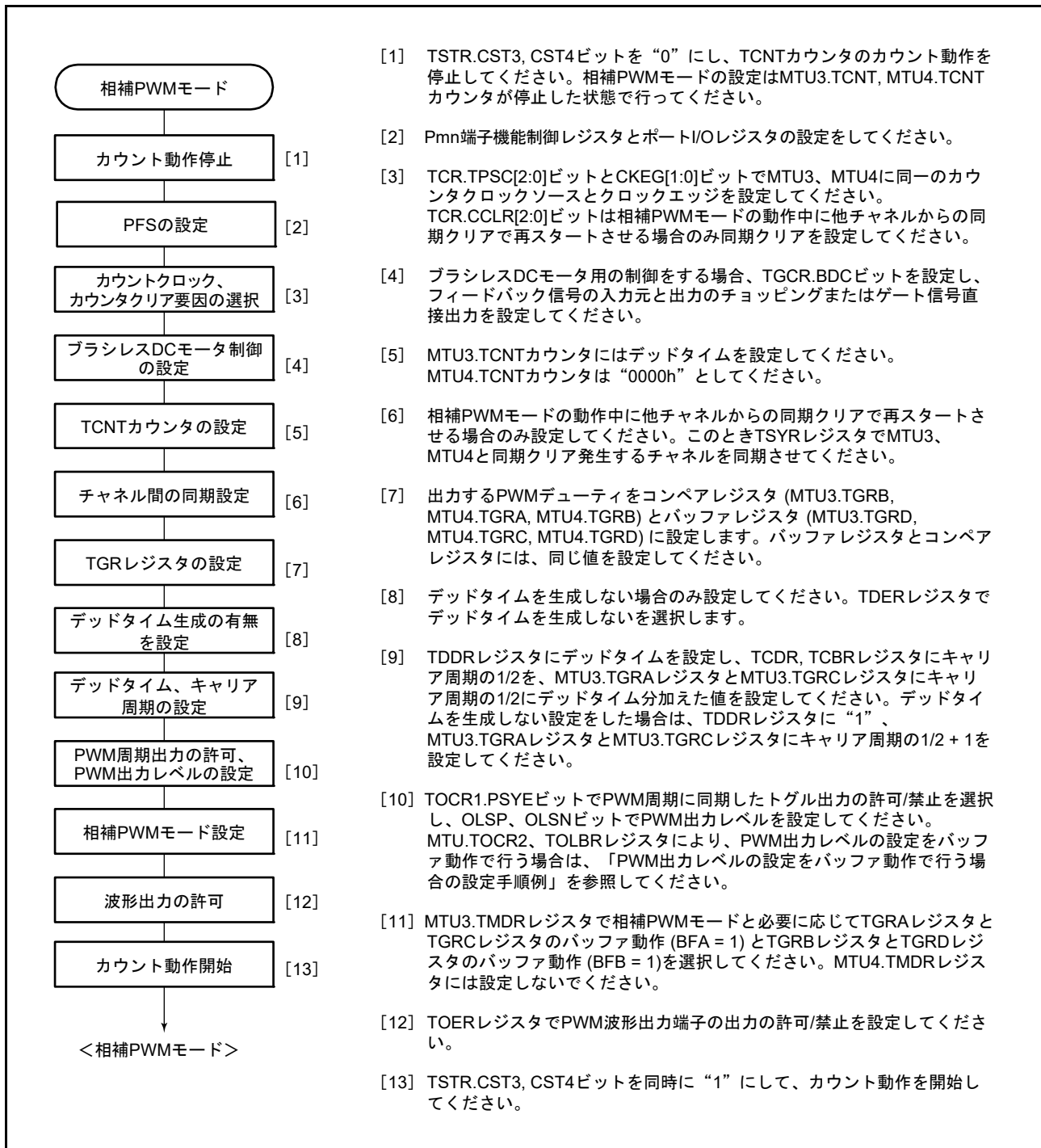
図 20.38 相補 PWM モードの設定手順例
