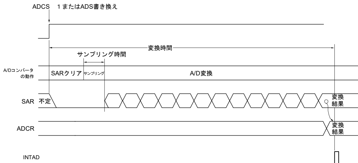
図12-16 A/Dコンバータの変換動作(ソフトウェア・トリガ・モードの場合)
