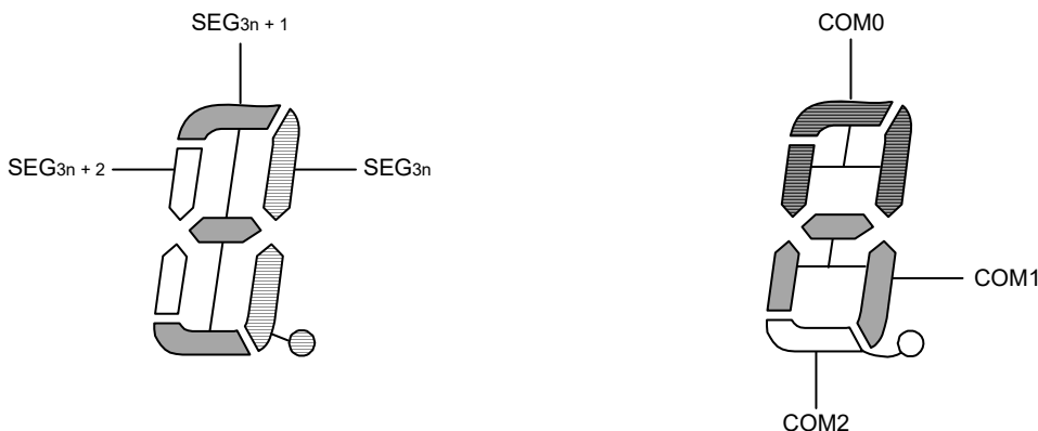
図18-36 3時分割LCD表示パターンと電極結線
