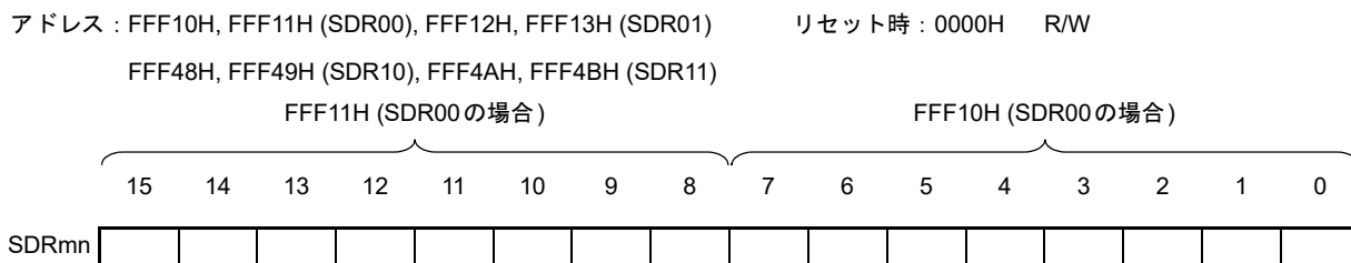
図15-11 シリアル・データ・レジスタ mn (SDRmn)のフォーマット
