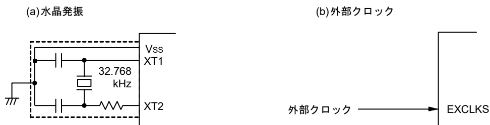
図5 - 20 XT1発振回路の外付け回路例
