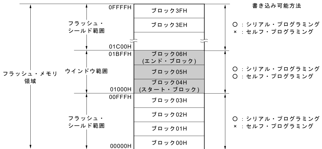
図30-11 フラッシュ・シールド・ウインドウの設定例 (対象デバイス：R5F110PE, スタート・ブロック：04H, エンド・ブロック：06Hの場合)
