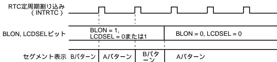
図14-17 点滅表示からAパターン表示への切り替え動作
