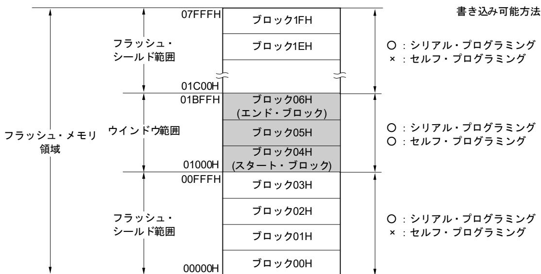
図30-11 フラッシュ・シールド・ウインドウの設定例 (対象デバイス：R5F11CBC, スタート・ブロック：04H, エンド・ブロック：06Hの場合)
