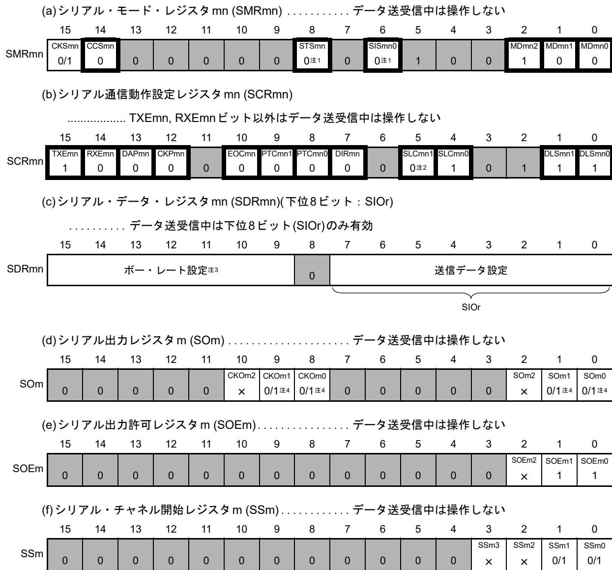
図 19 - 138 簡易 I 2 C (IIC00, IIC01) のデータ送信時のレジスタ設定内容例
