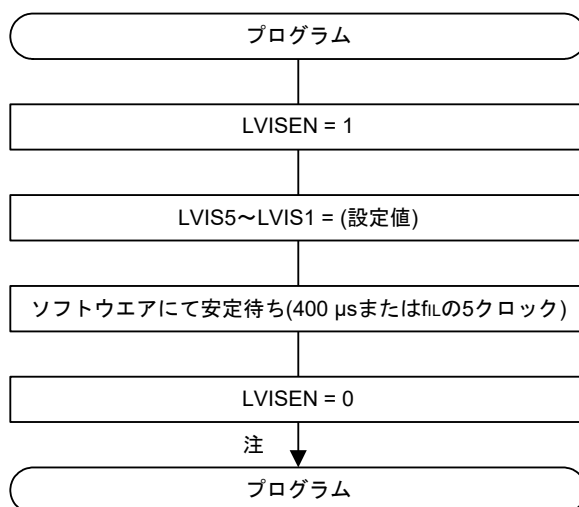
図29-25 LVD検出電圧設定変更
