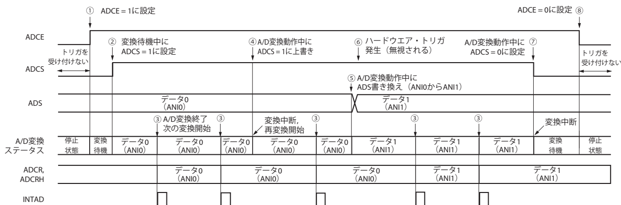
図11-17 ソフトウェア・トリガ・モード（セレクト・モード，連続変換モード）動作タイミング例
