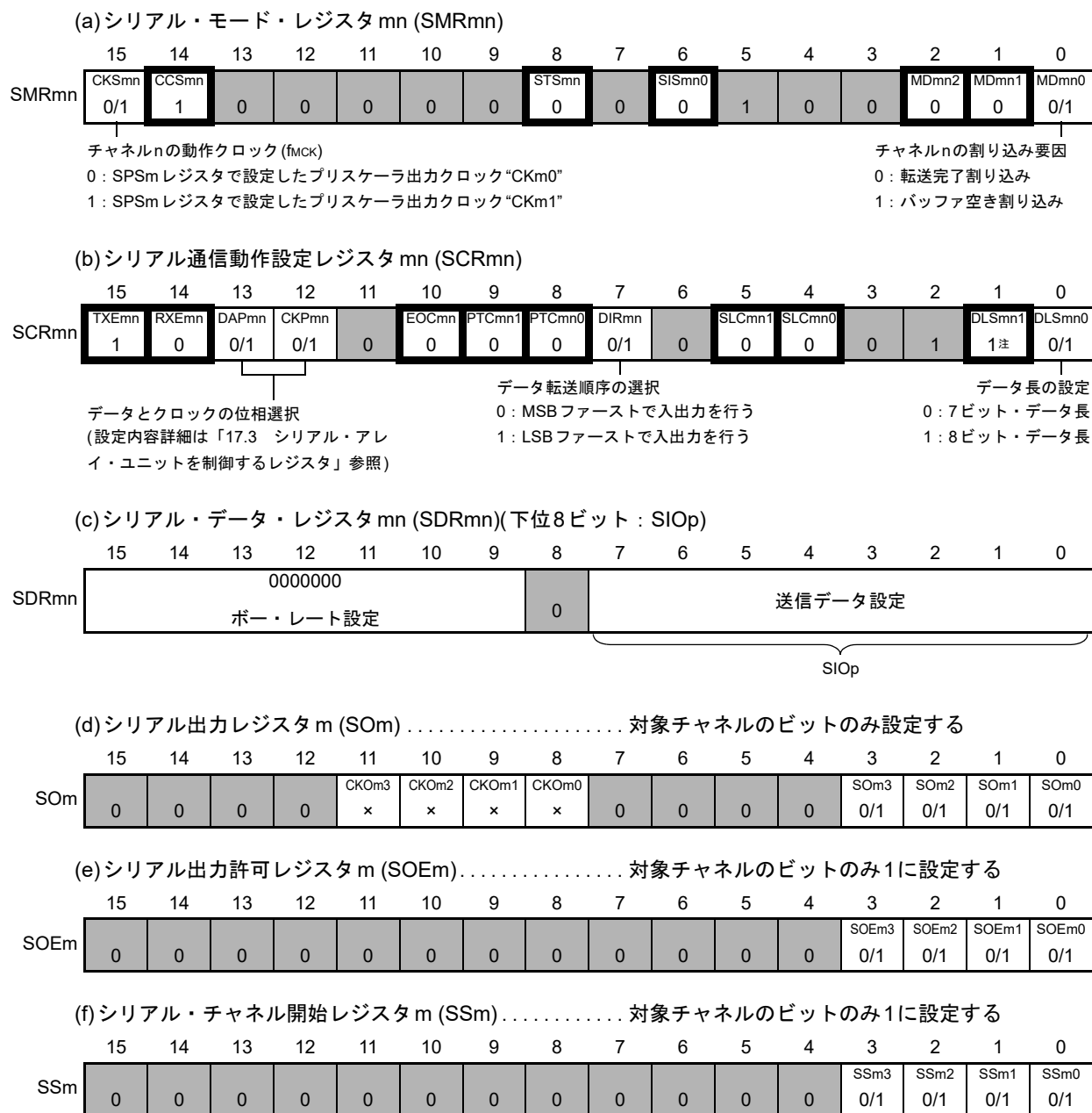
図 17 - 52 簡易 SPI (CSI00, CSI01, CSI10, CSI11, CSI20, CSI21, CSI30, CSI31)のスレーブ送信時のレジスタ設定内容例
