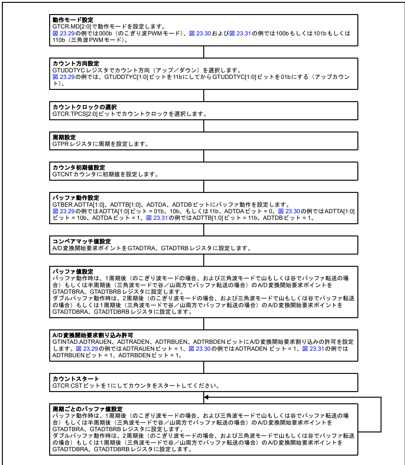
図 23.32 GTADTRA、GTADTRB レジスタのバッファ動作設定例
