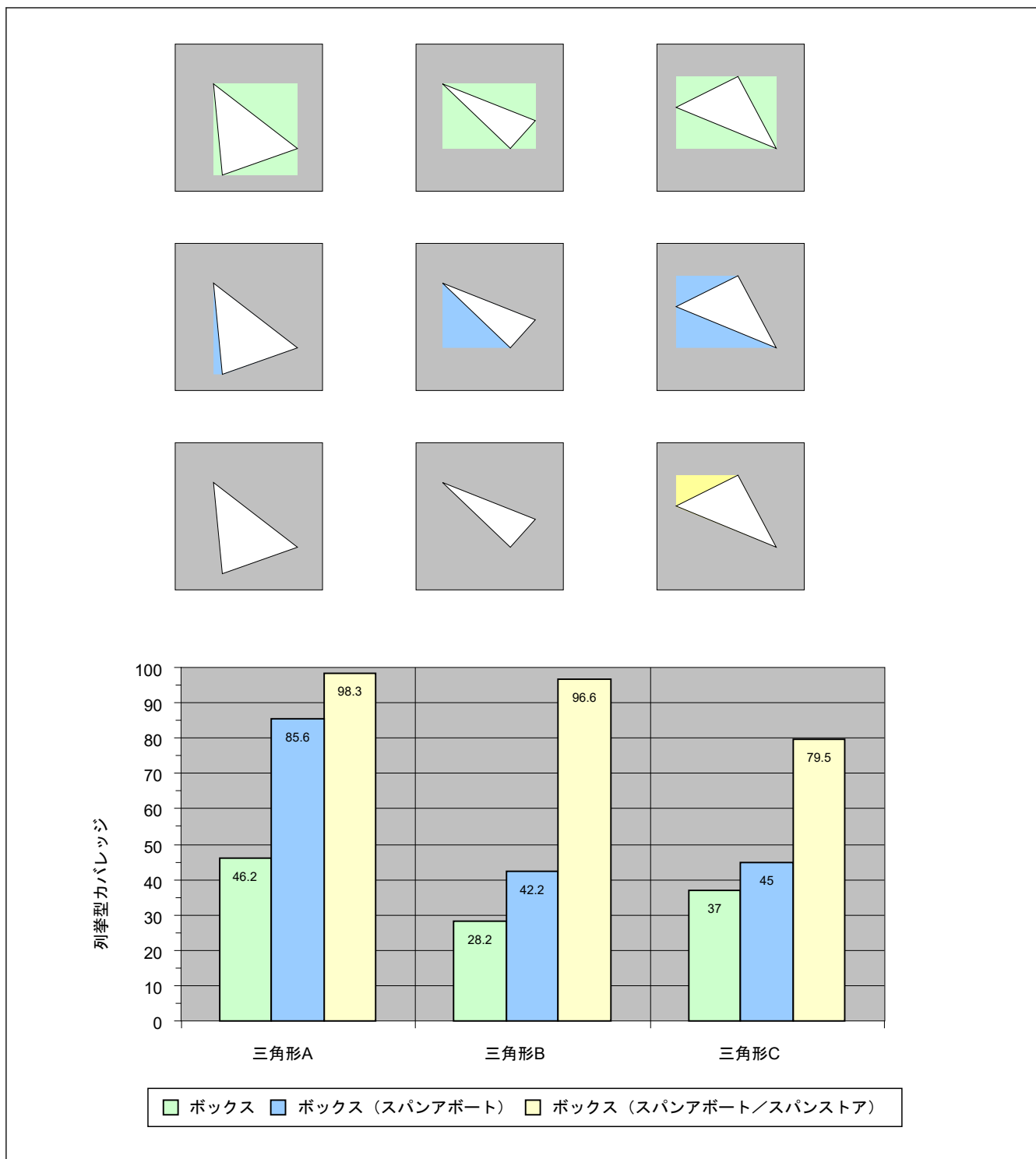
図 55.19 列挙型カバレッジ = {プリミティブのピクセル数 ÷ バウンディングボックスのピクセル数} の場合の スパンストアおよびスパンサポート最適化の効率
