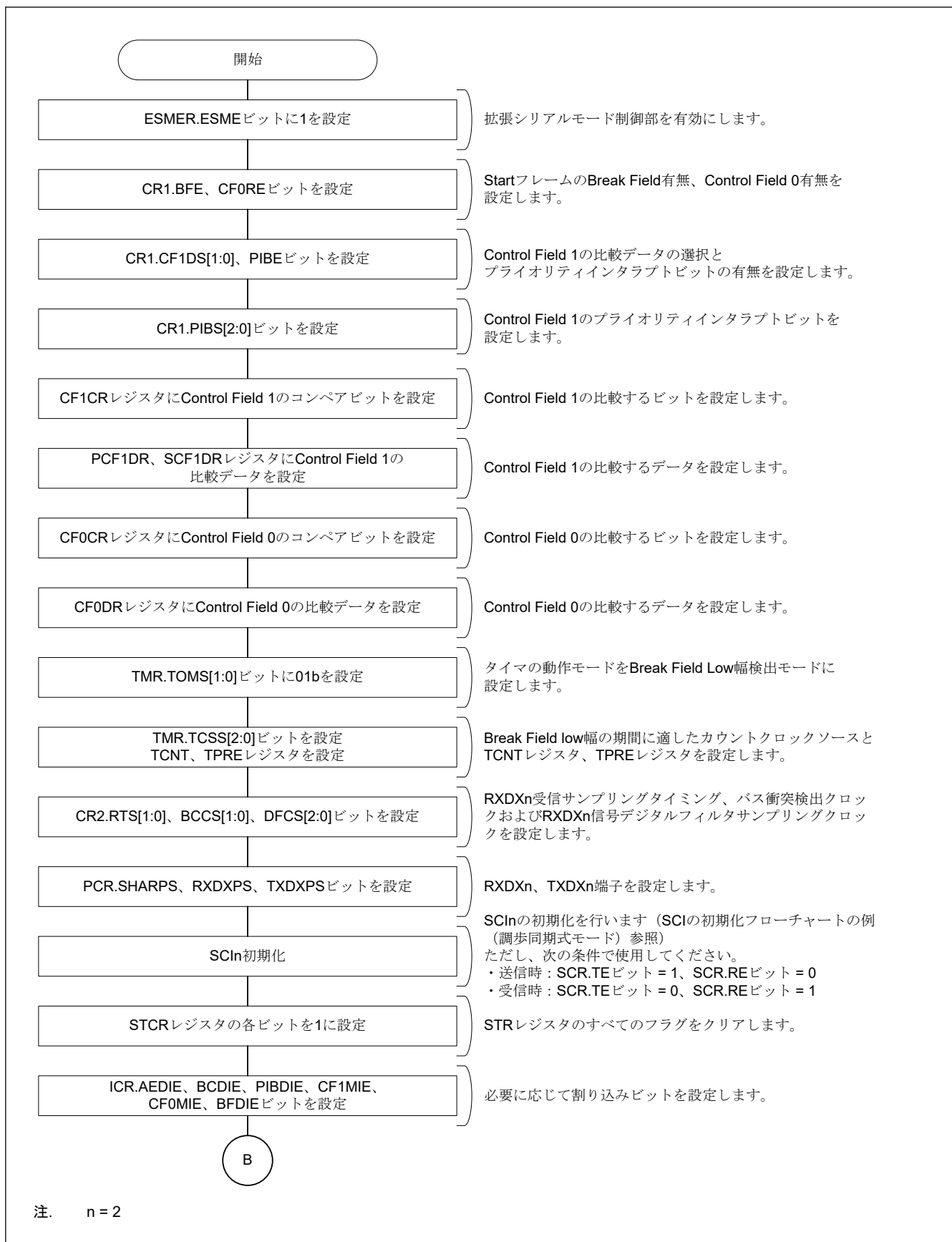
図 29.107 Start Frame 受信フローチャート例 (1)
