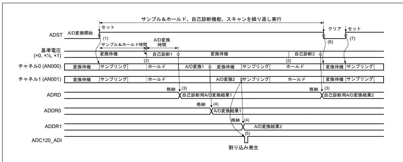
図 29.17 連続スキャンモードの動作例（チャンネル専用サンプル&ホールド回路を使用し、自己診断で AN000 と AN001 を選択した場合）
