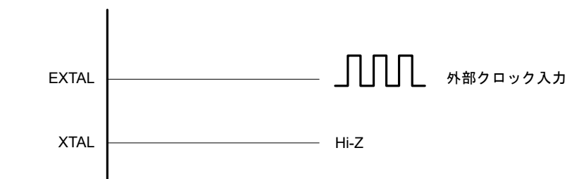
図 8.7 外部クロックの等価回路
