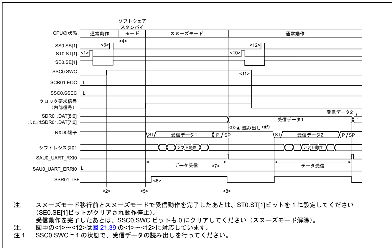
図 21.37 スヌーズモード動作のタイミング (SCR01.EOC = 0, SSC0.SSEC = 0/1)
