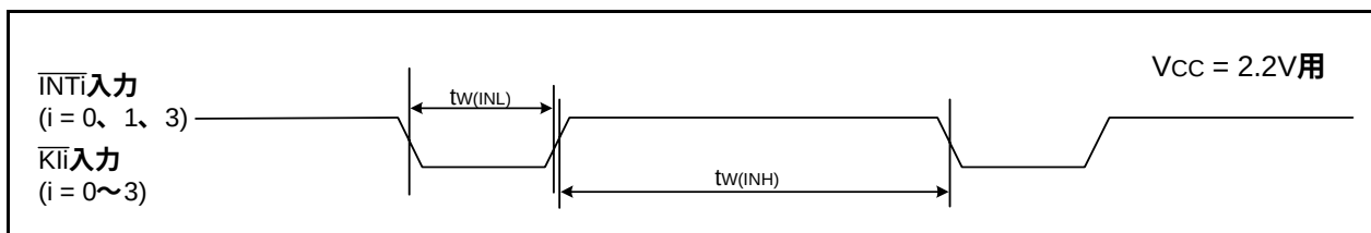
図32.19 Vcc = 2.2V時の外部割り込みINTiおよびキー入力割り込みKLi入力タイミング
