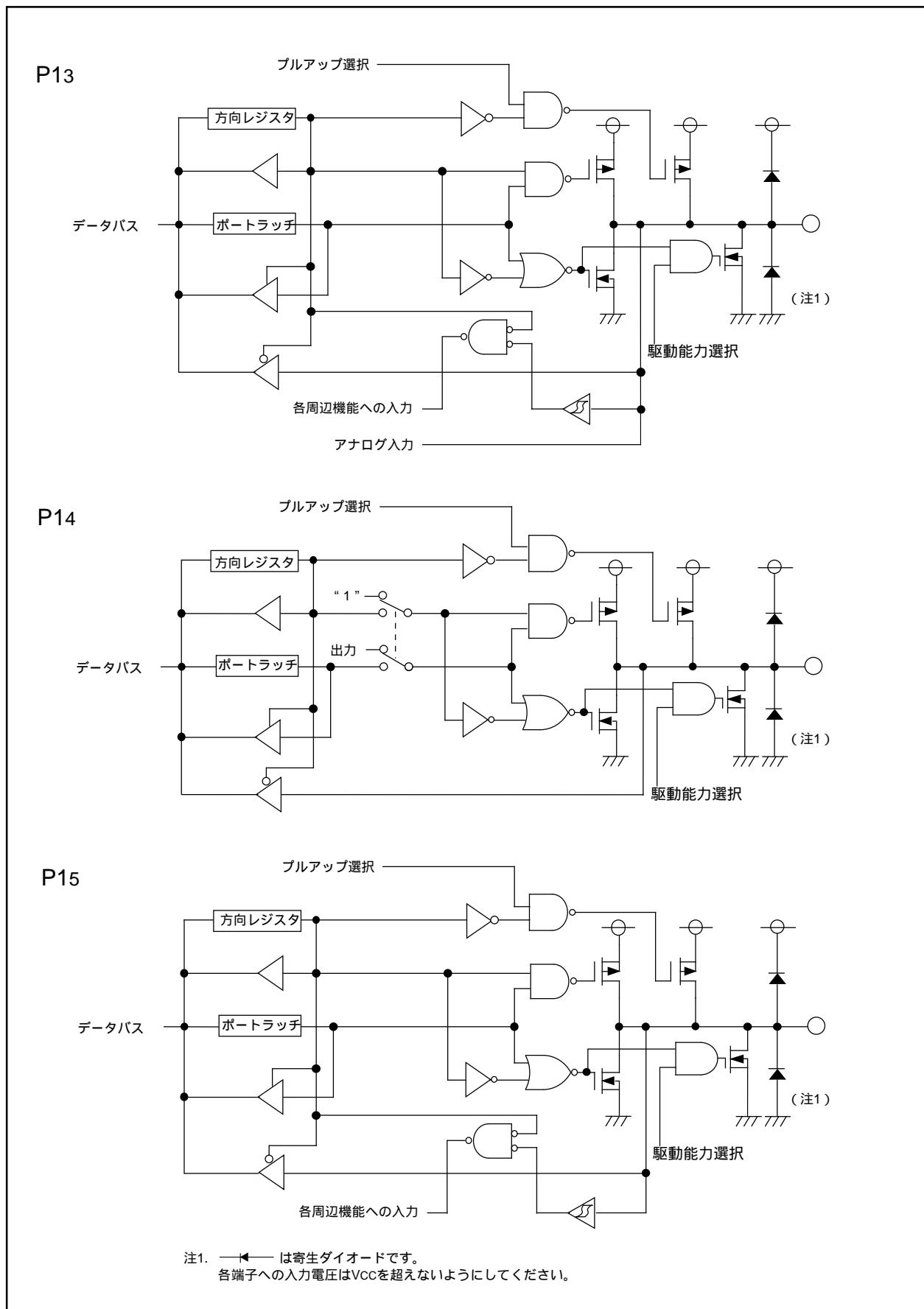
図15.2 プログラマブル入出力ポートの構成(2)
