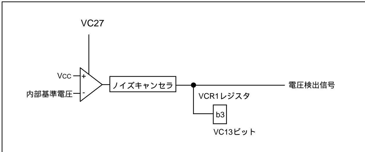
図5.7 電圧検出回路ブロック図
