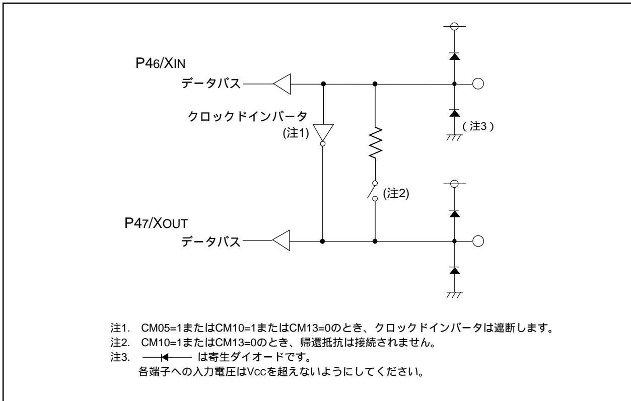
図15.5 プログラマブル入出力ポートの構成(5)
