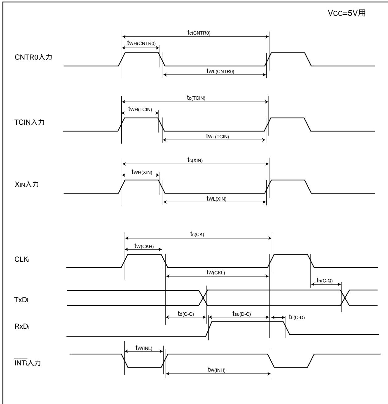
図16.4  $V_{CC}=5V$ 時のタイミング
