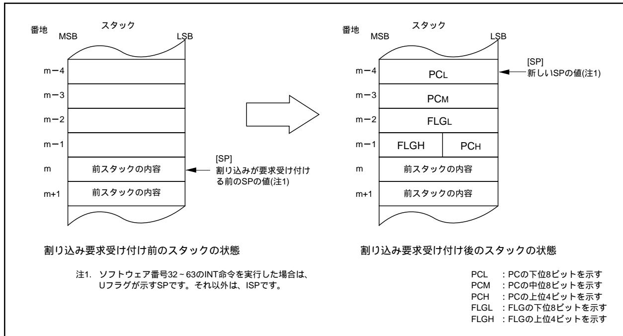
図10.6 割り込み要求受け付け前と後のスタックの状態
