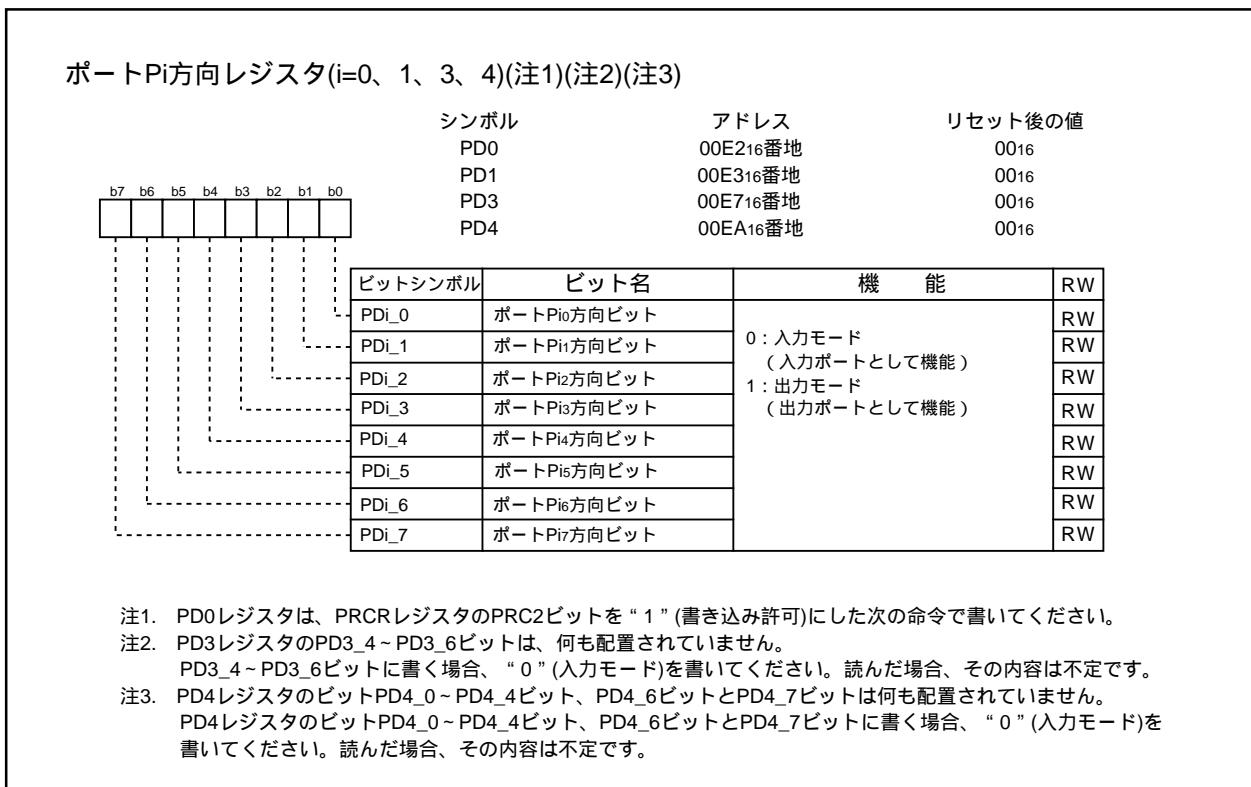
図15.7 PD0、PD1、PD3、PD4レジスタの構成
