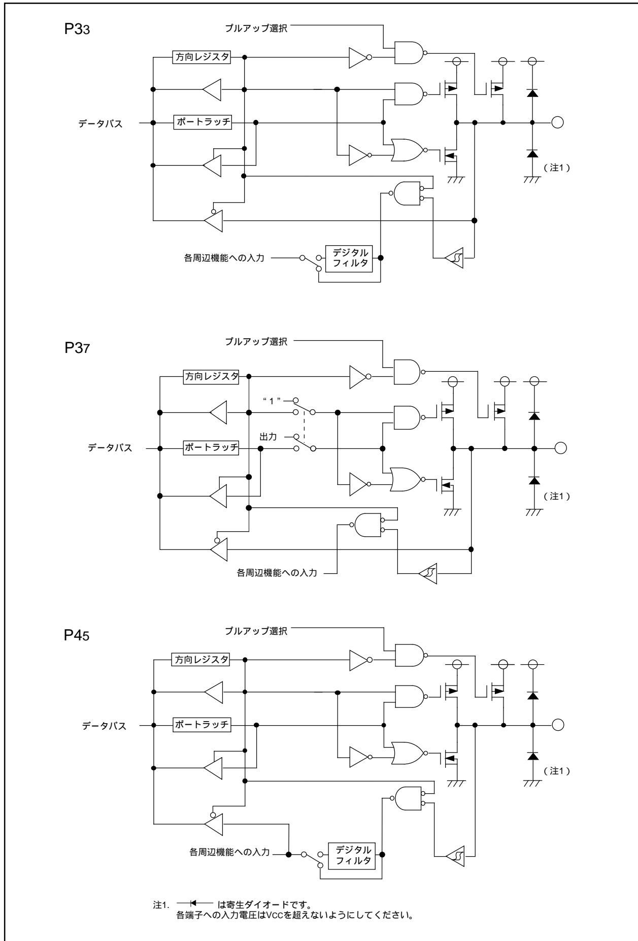
図15.4 プログラマブル入出力ポートの構成(4)
