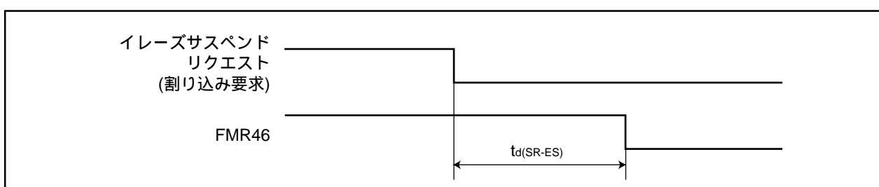
図16.2 消去動作からイレーズサスペンドへの遷移時間
