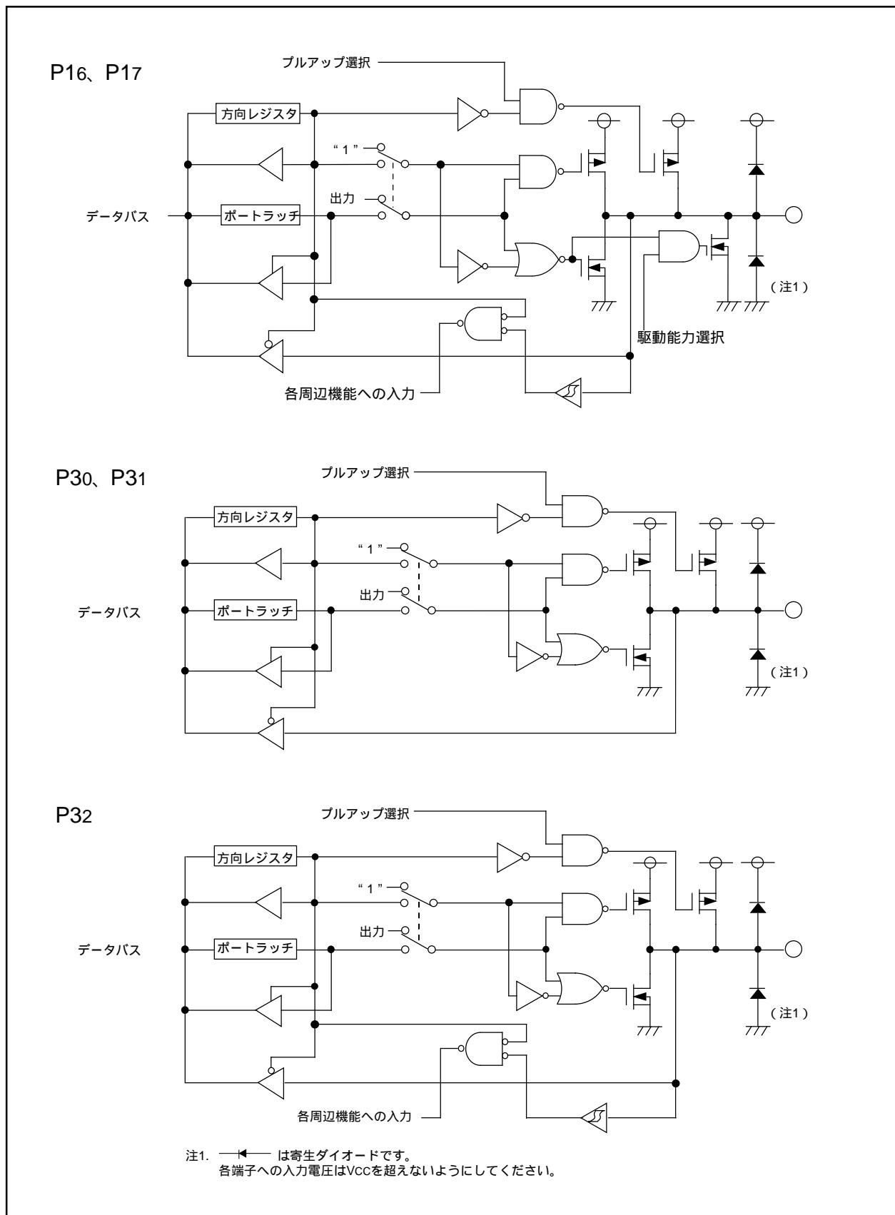
図15.3 プログラマブル入出力ポートの構成(3)
