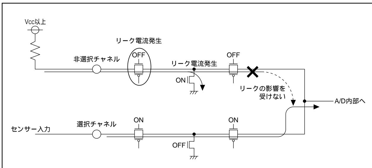
図14.10 注入電流バイパス回路へVcc以上印加例
