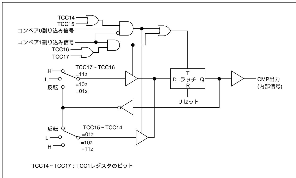
図12.29 CMP波形生成部ブロック図
