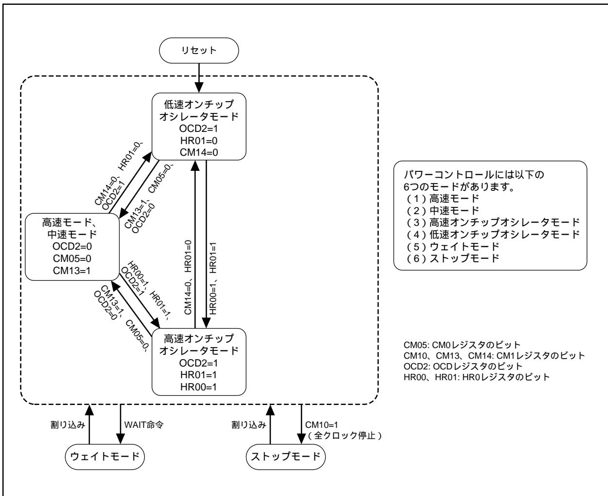
図6.6 パワーコントロールの状態遷移
