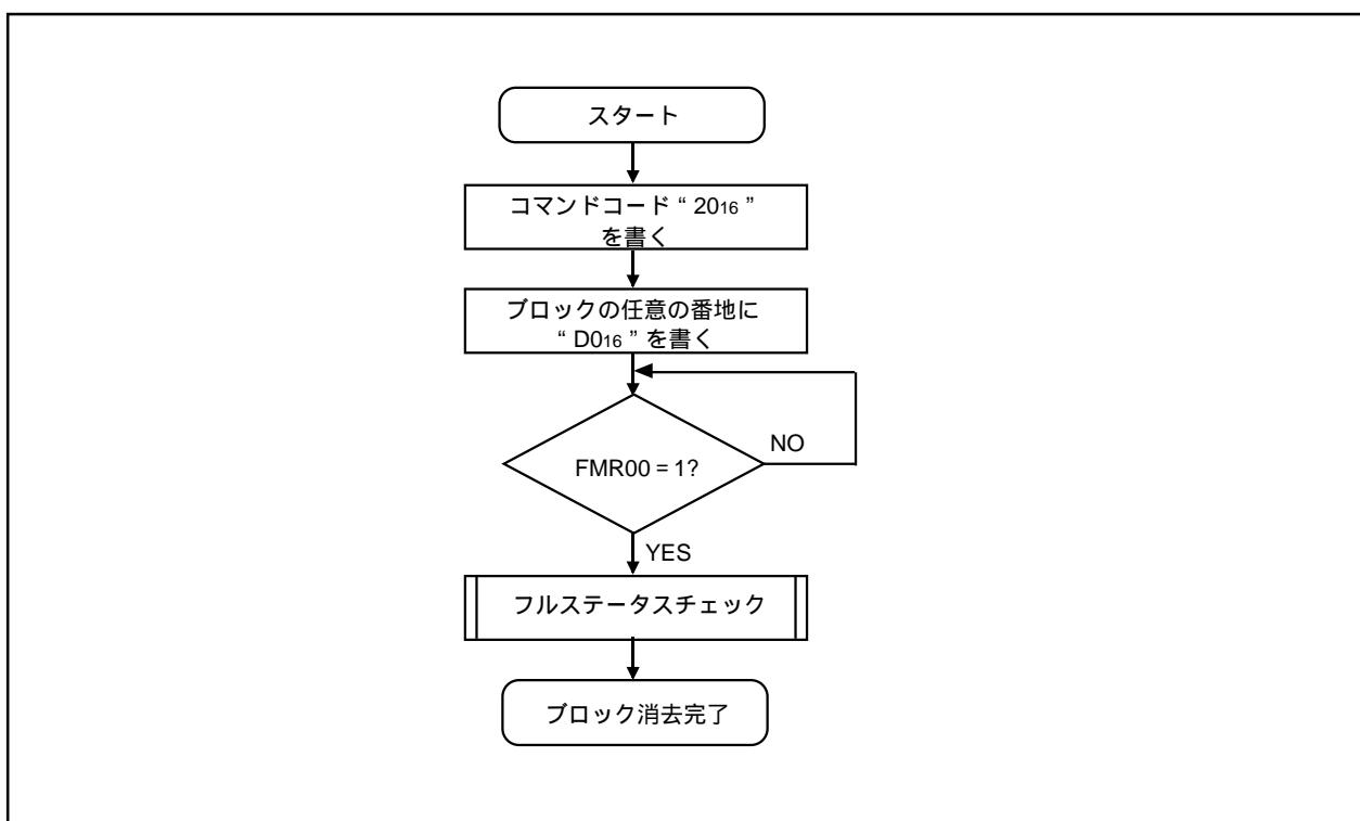
図17.10 ブロックイレーズフローチャート(イレーズサスペンド機能不使用時)
