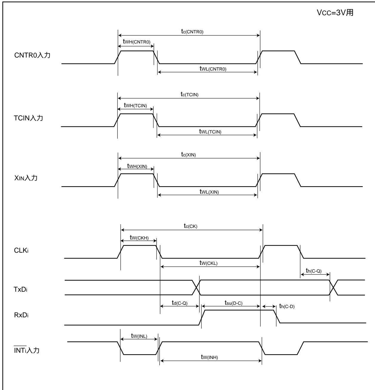
図16.5  $V_{CC}=3V$ 時のタイミング
