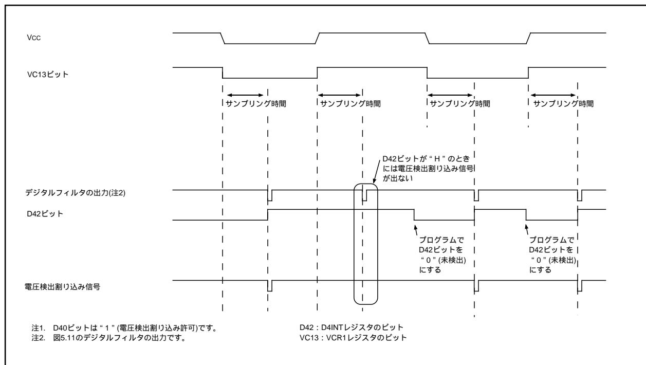
図5.14 電圧検出割り込み発生回路の動作例
