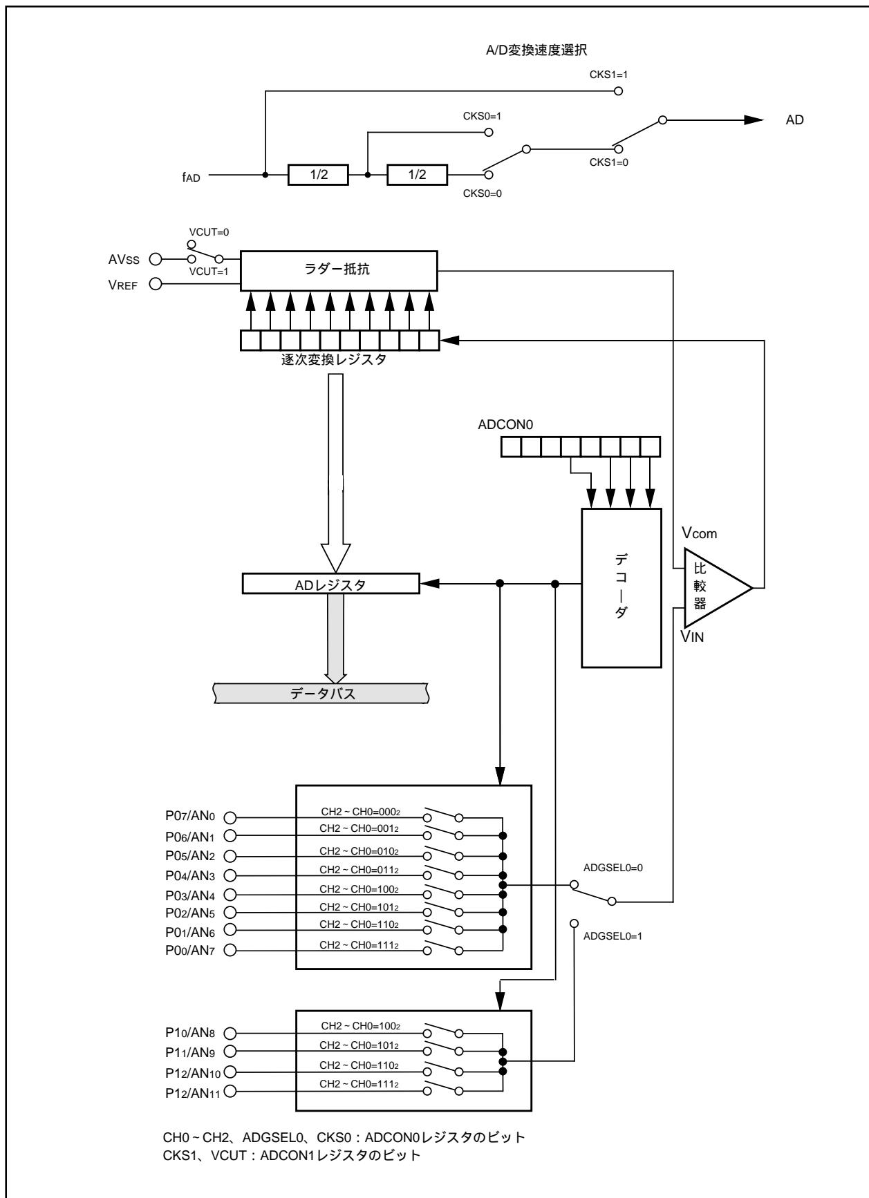
図14.1 A/Dコンバータのブロック図
