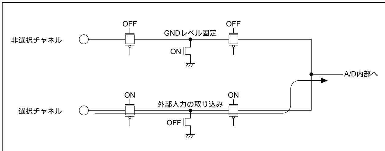
図14.9 注入電流バイパス回路構成図
