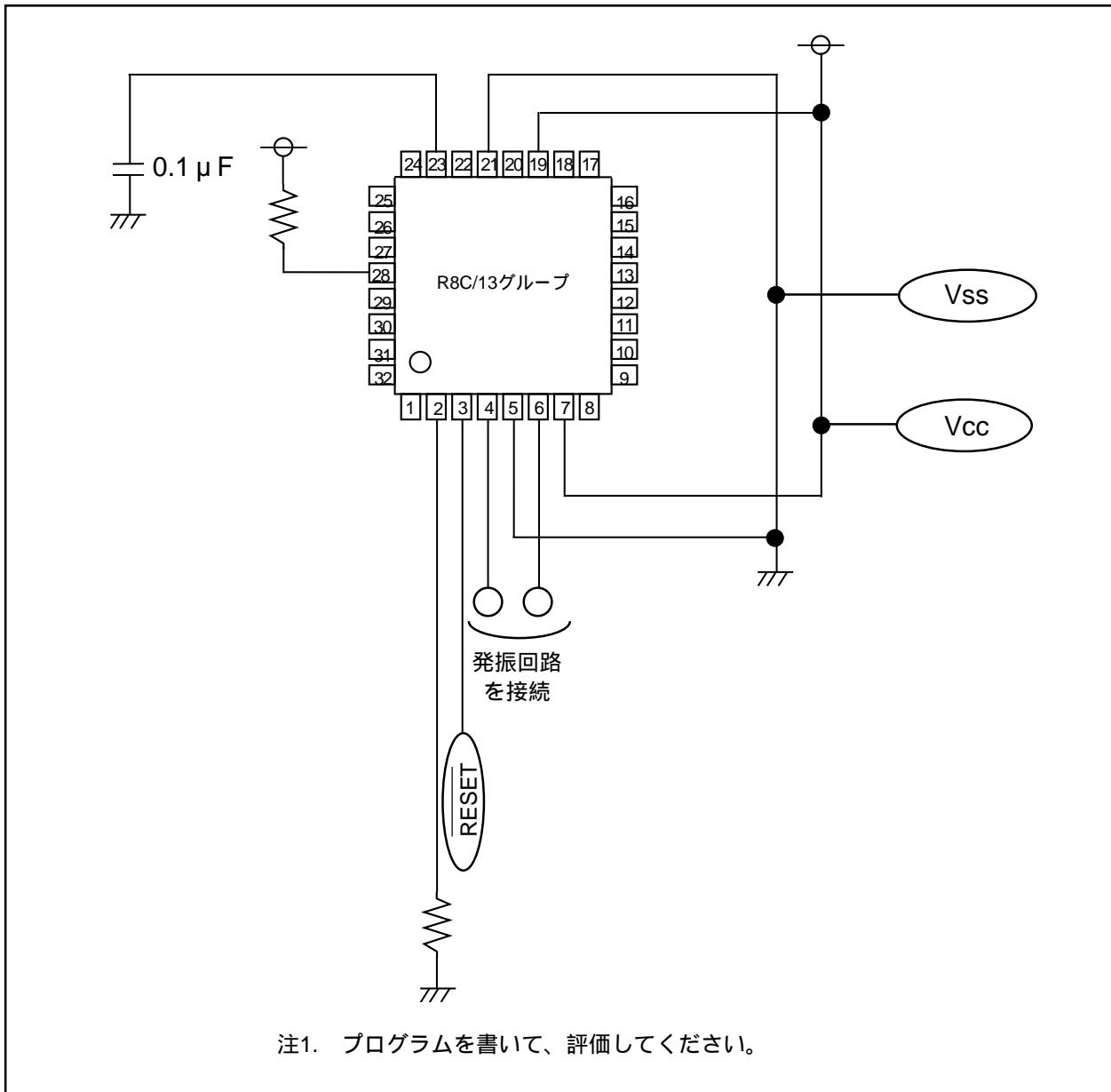
付図3.1 発振評価回路例
