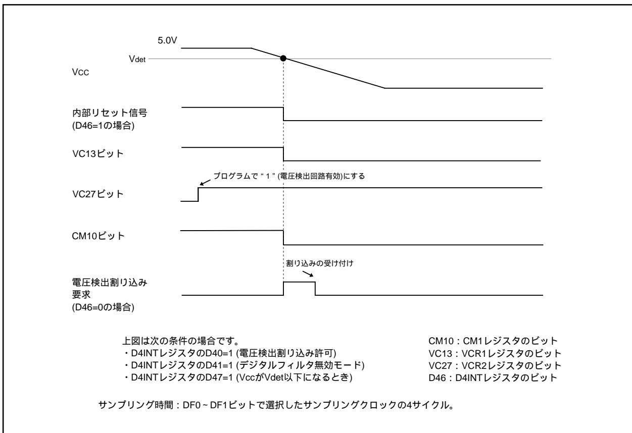
図5.11 ストップモードからの復帰に使用した場合の電圧検出回路の動作例(1)
