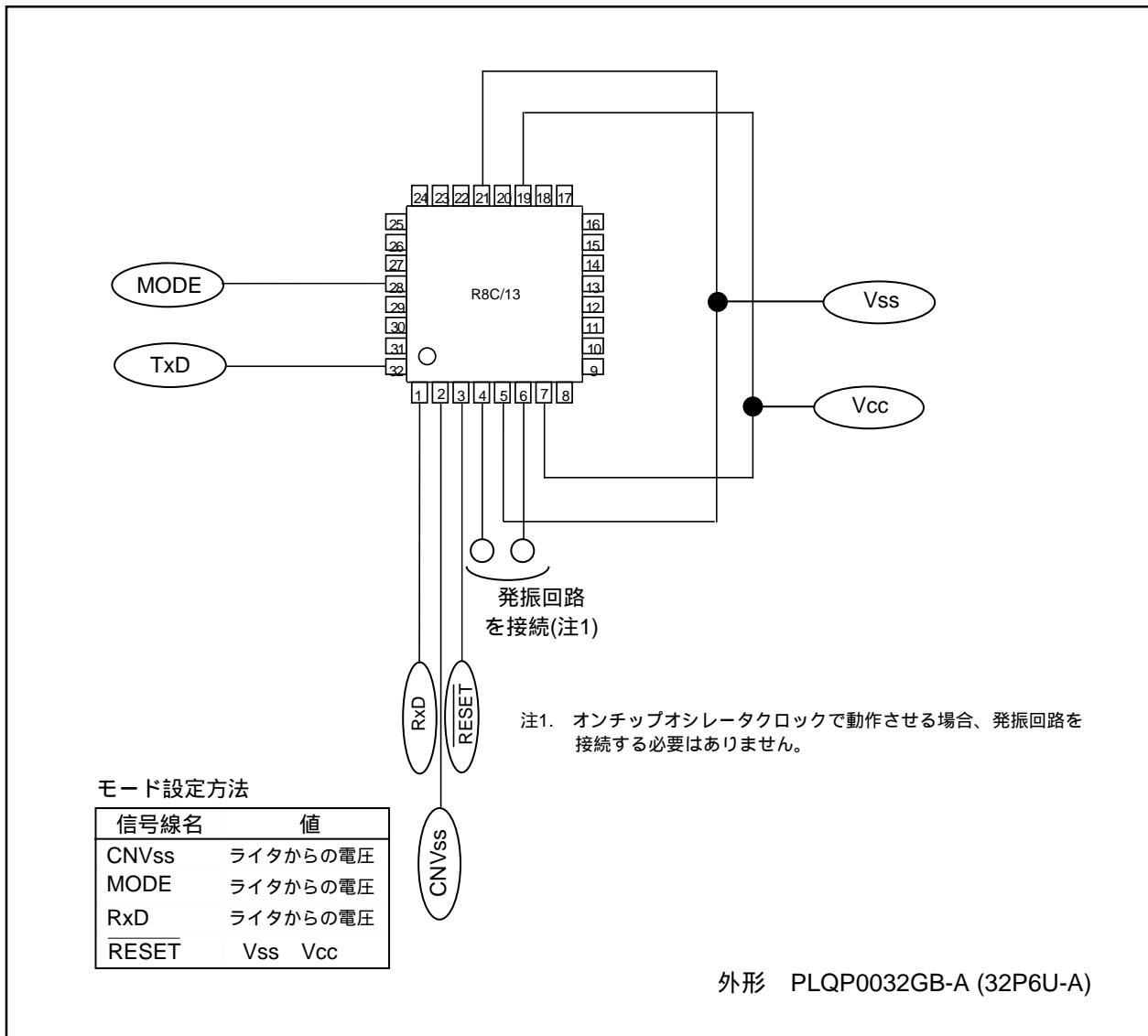
図17.13 標準シリアル入出力モード時の端子結線図
