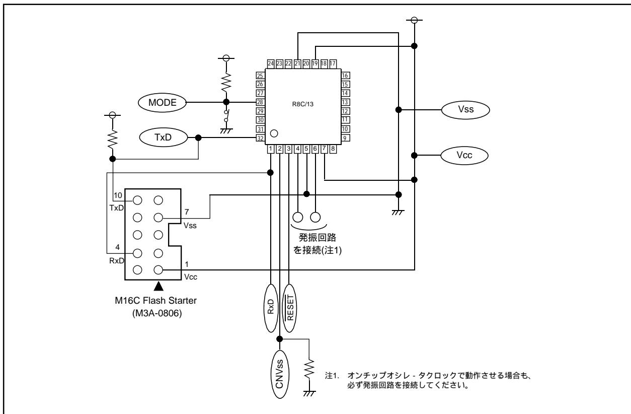
付図2.2 M16C Flash Starter (M3A-0806)との接続例
