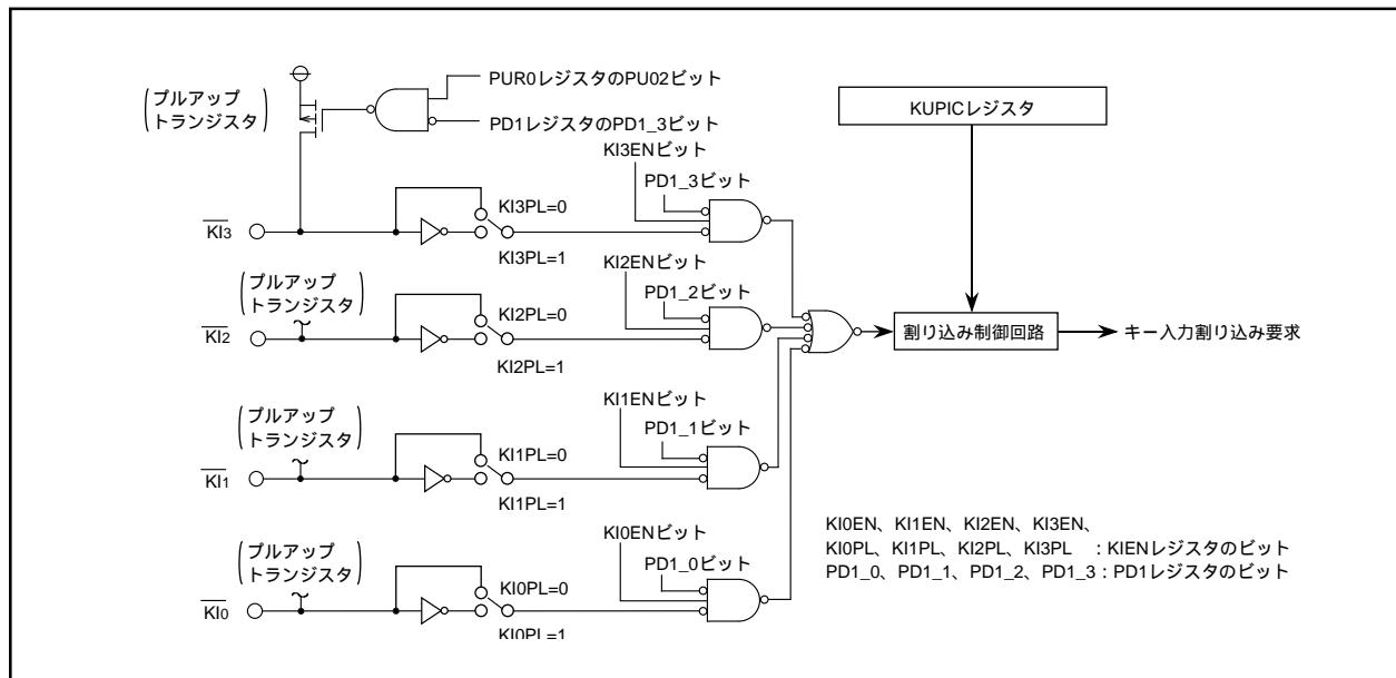
図10.15 キー入力割り込みのブロック図
