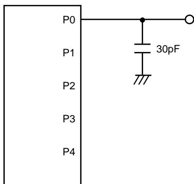
図16.1 ポートP0～P4の測定回路
