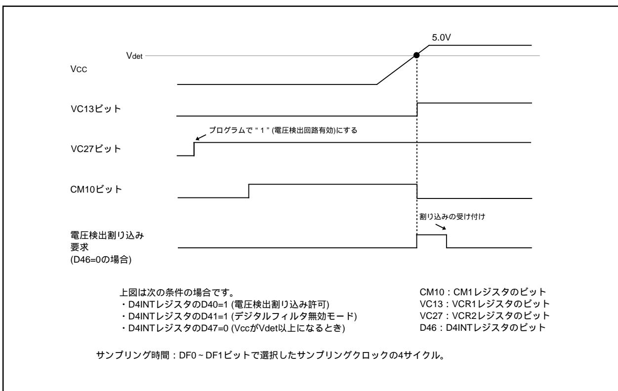
図5.12 ストップモードからの復帰に使用した場合の電圧検出回路の動作例(2)
