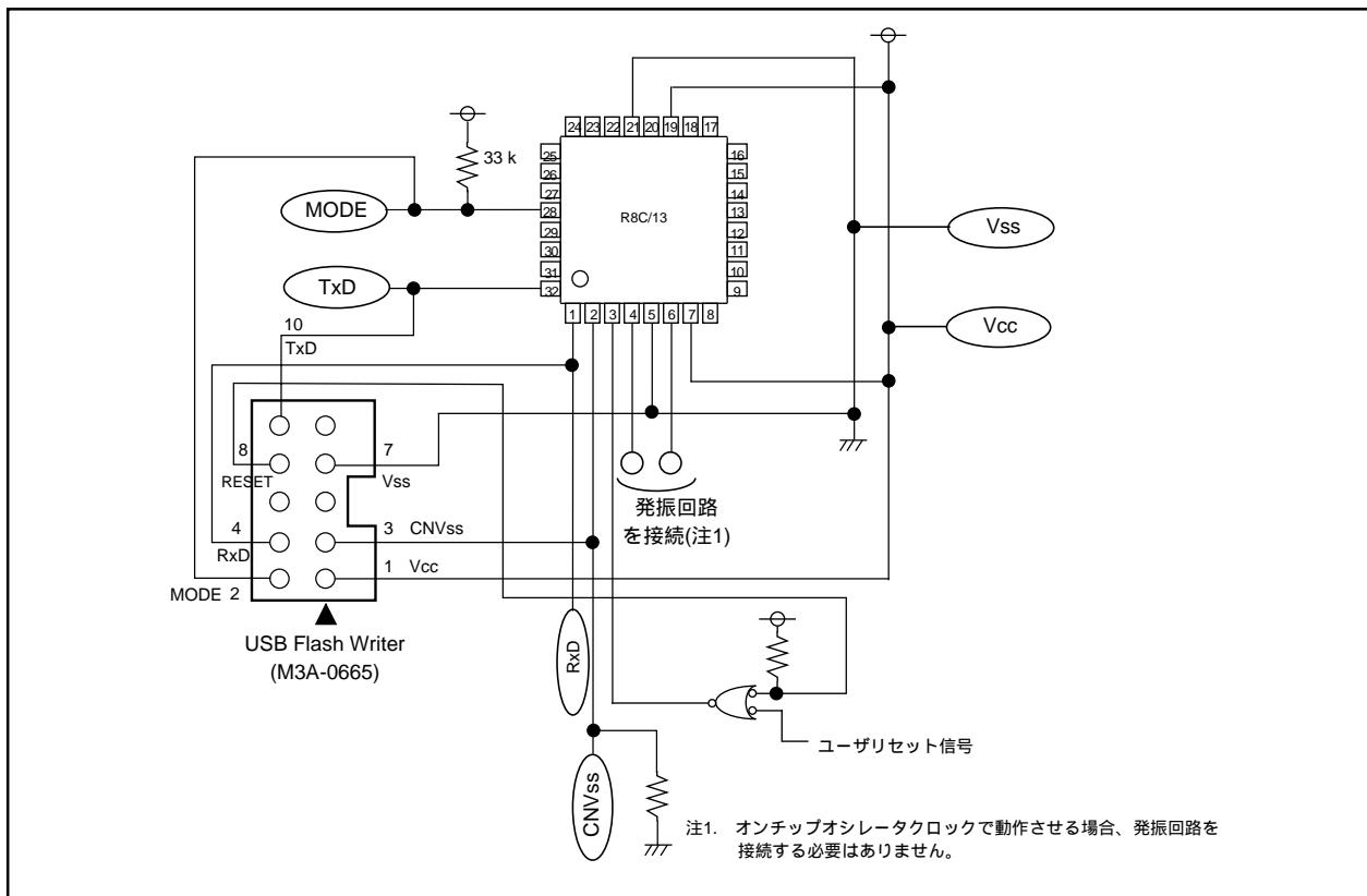
付図2.1 USB Flash Writer (M3A-0665)との接続例
