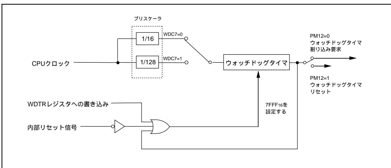
図11.1 ウォッチドッグタイマのブロック図
