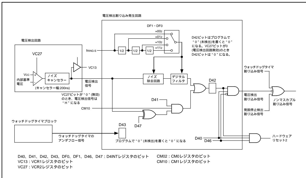
図5.13 電圧検出割り込み発生回路ブロック図
