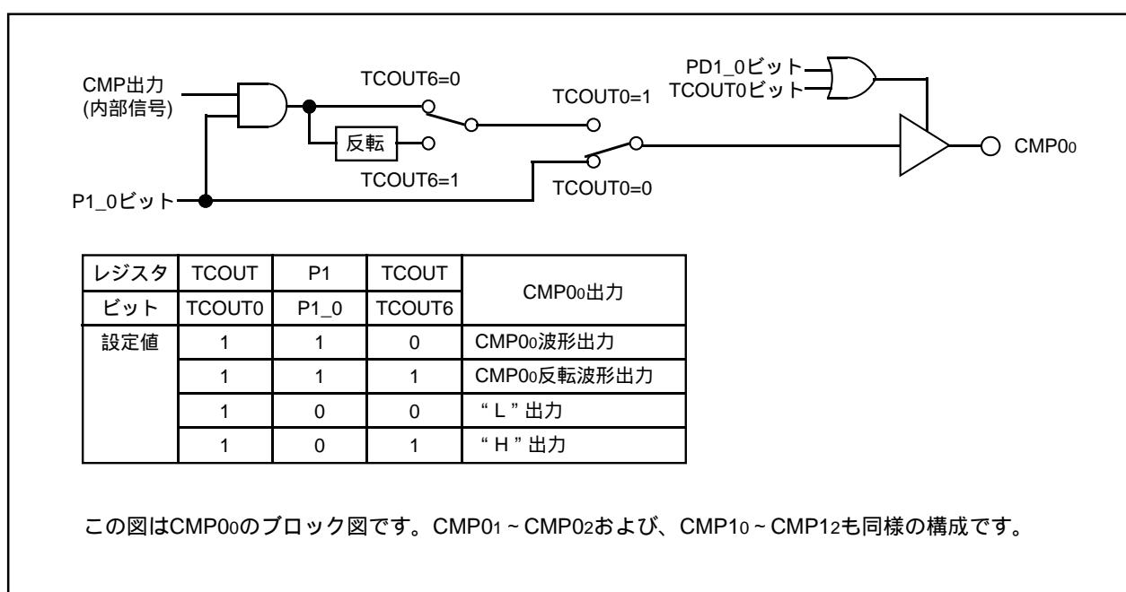
図12.30 CMP波形出力部ブロック図
