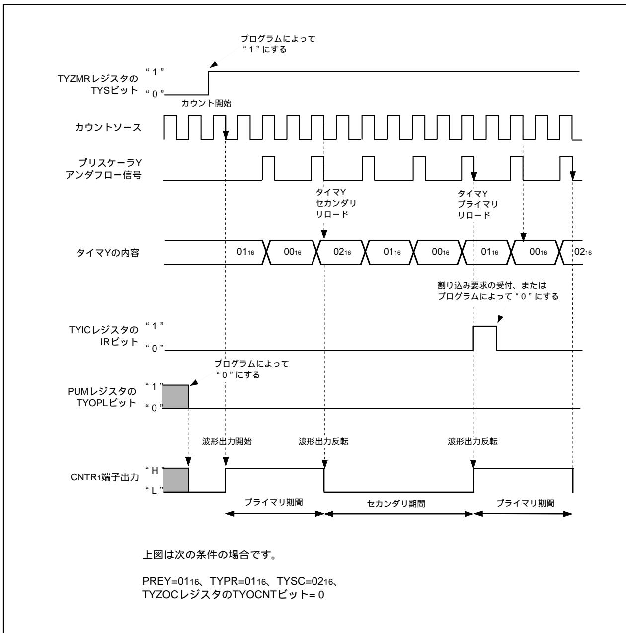
図12.17 プログラマブル波形発生モード時のタイマYの動作例
