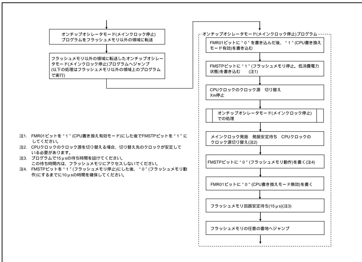
図17.8 オンチップオシレータモード(メインクロック停止)でさらに低消費電力にする処理
