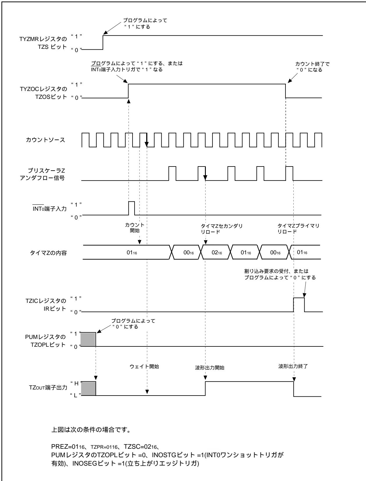
図12.27 プログラマブルウェイトワンショット発生モード時の動作例
