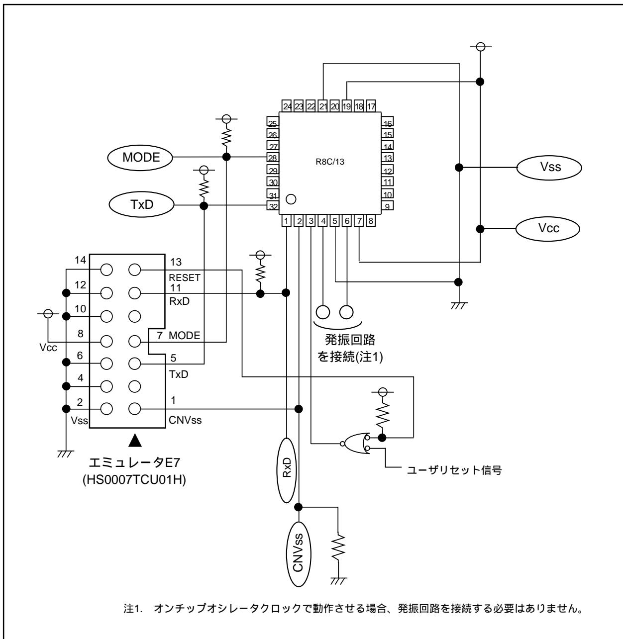
付図2.3 エミュレータE7 (HS0007TCU01H)との接続例
