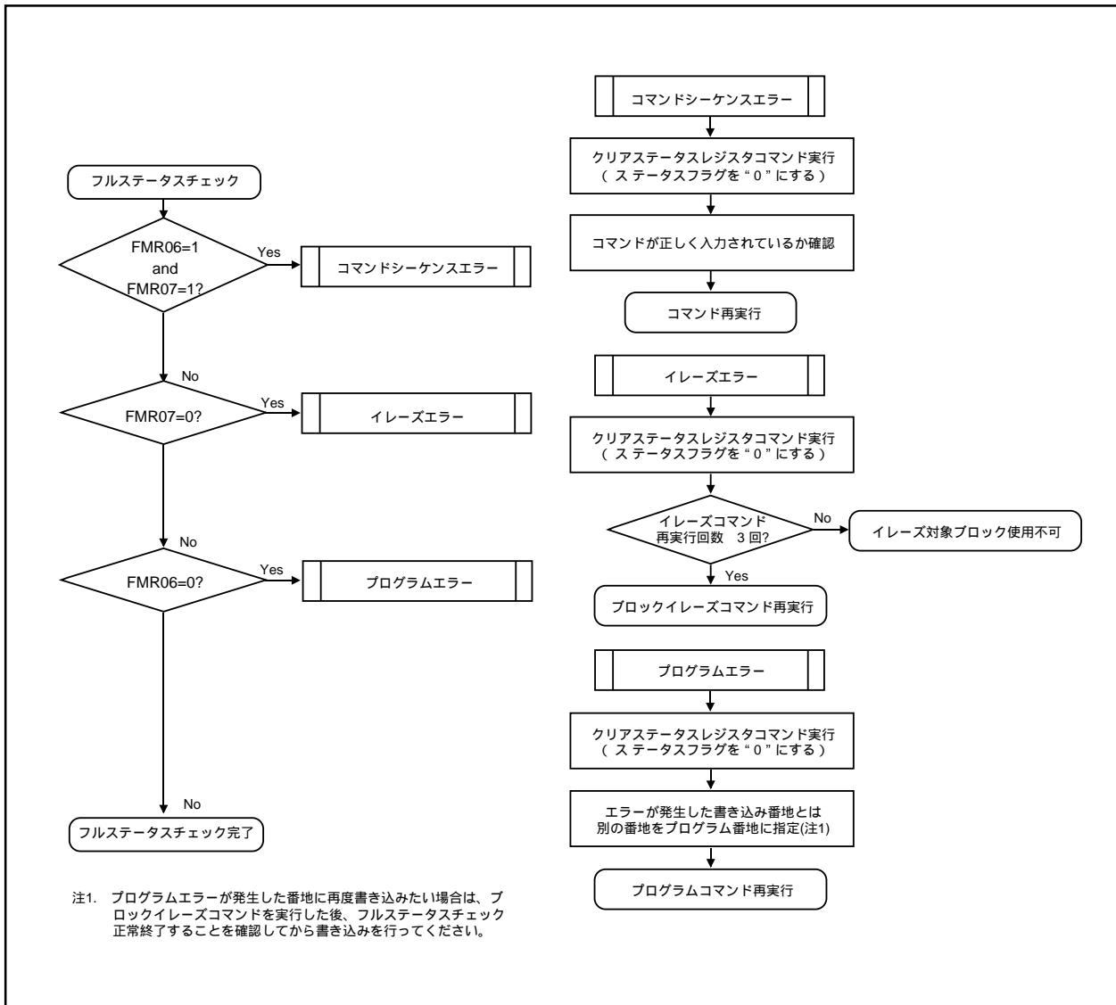
図17.12 フルステータスチェックフロチャート、各エラー発生時の対処方法
