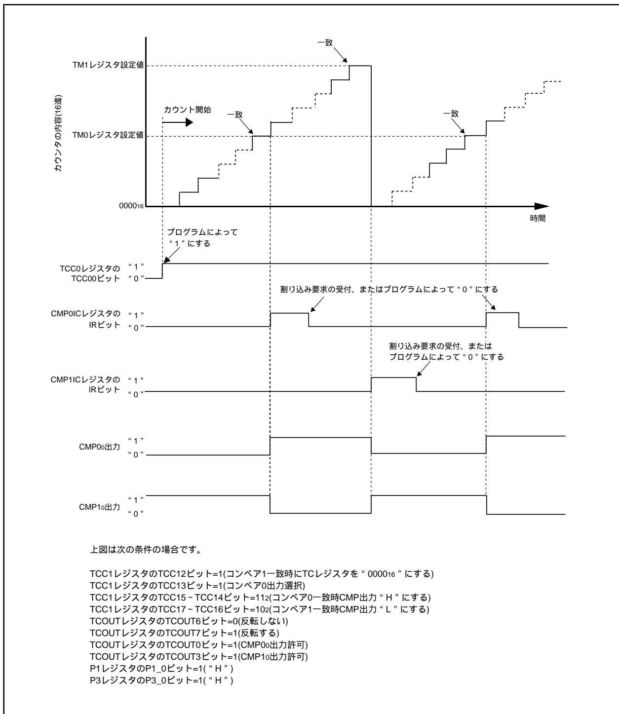
図12.34 アウトプットコンペアモード時のタイマCの動作例
