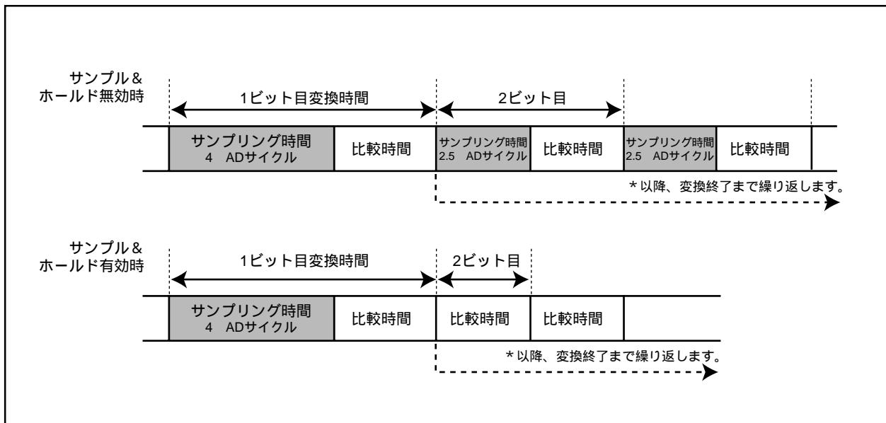
図14.6 A/D変換タイミング図
