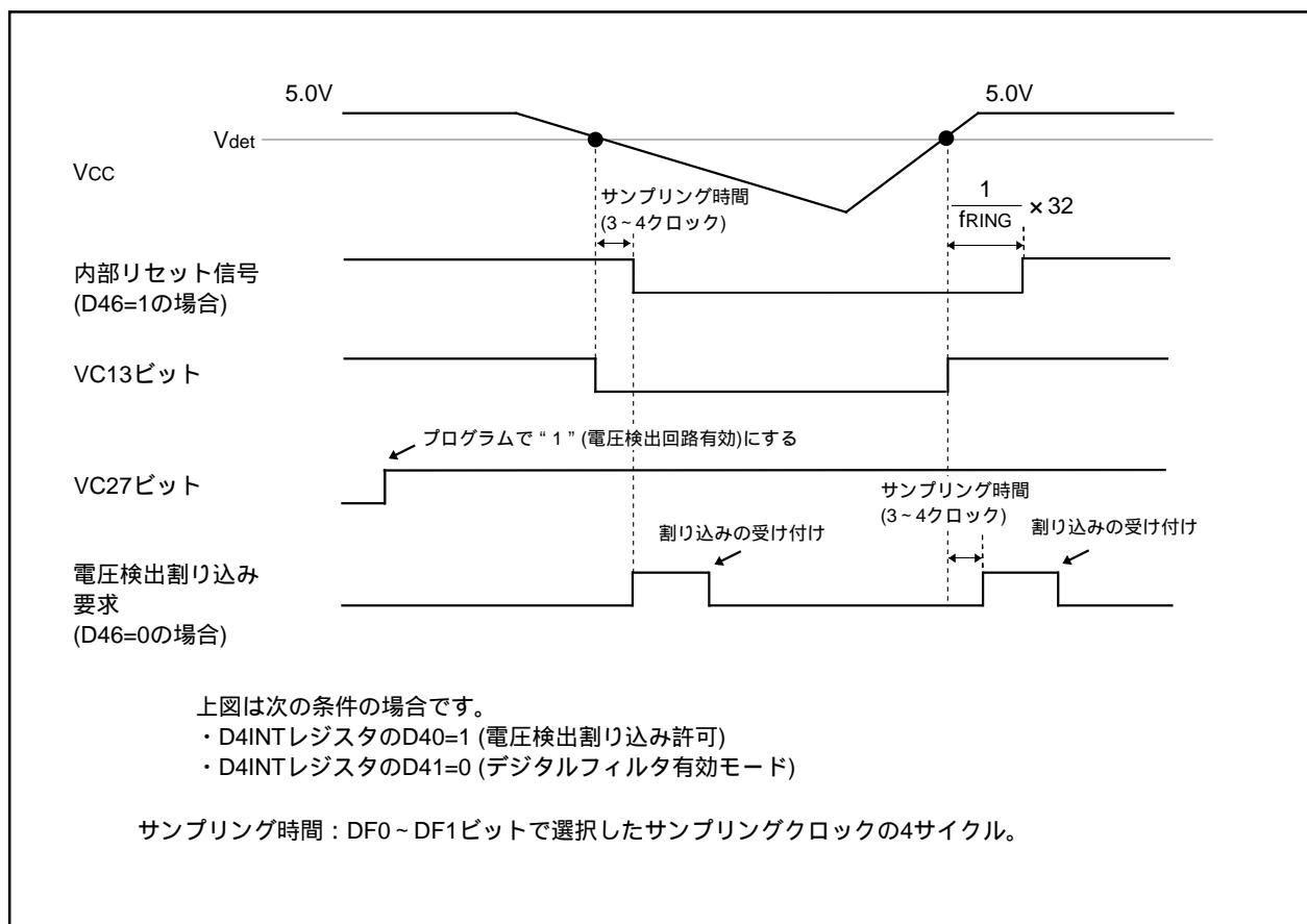
図5.10 電圧検出回路の動作例
