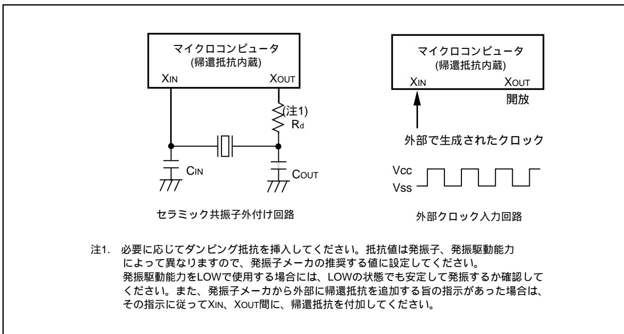
図6.5 メインクロックの接続回路例
