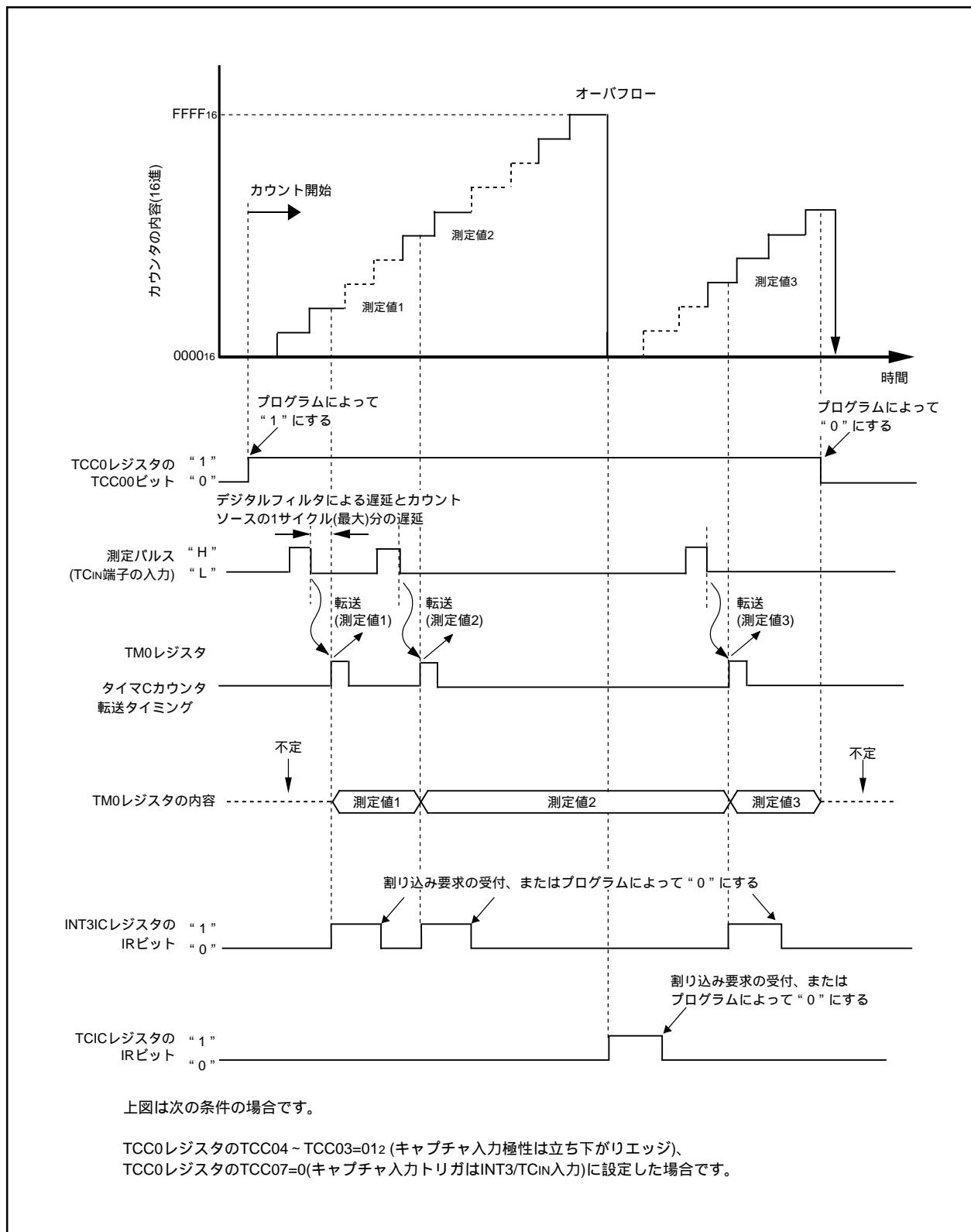
図12.33 インプットキャプチャモード時のタイマCの動作例
