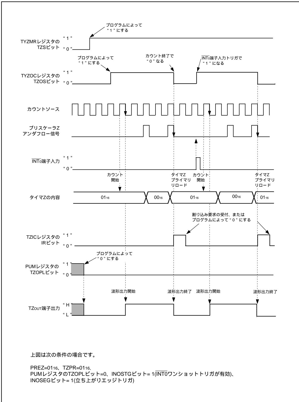
図12.25 プログラマブルワンショット発生モード時の動作例
