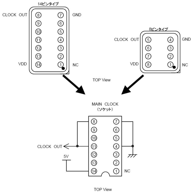
8ピンタイプの水晶発振器を実装する際は、発振器の1番ピンとMAIN CLOCKのソケット部の1番ピン、発振器の8番ピンとMAIN CLOCKのソケット部の14番ピンがそれぞれ合うように実装してください。
