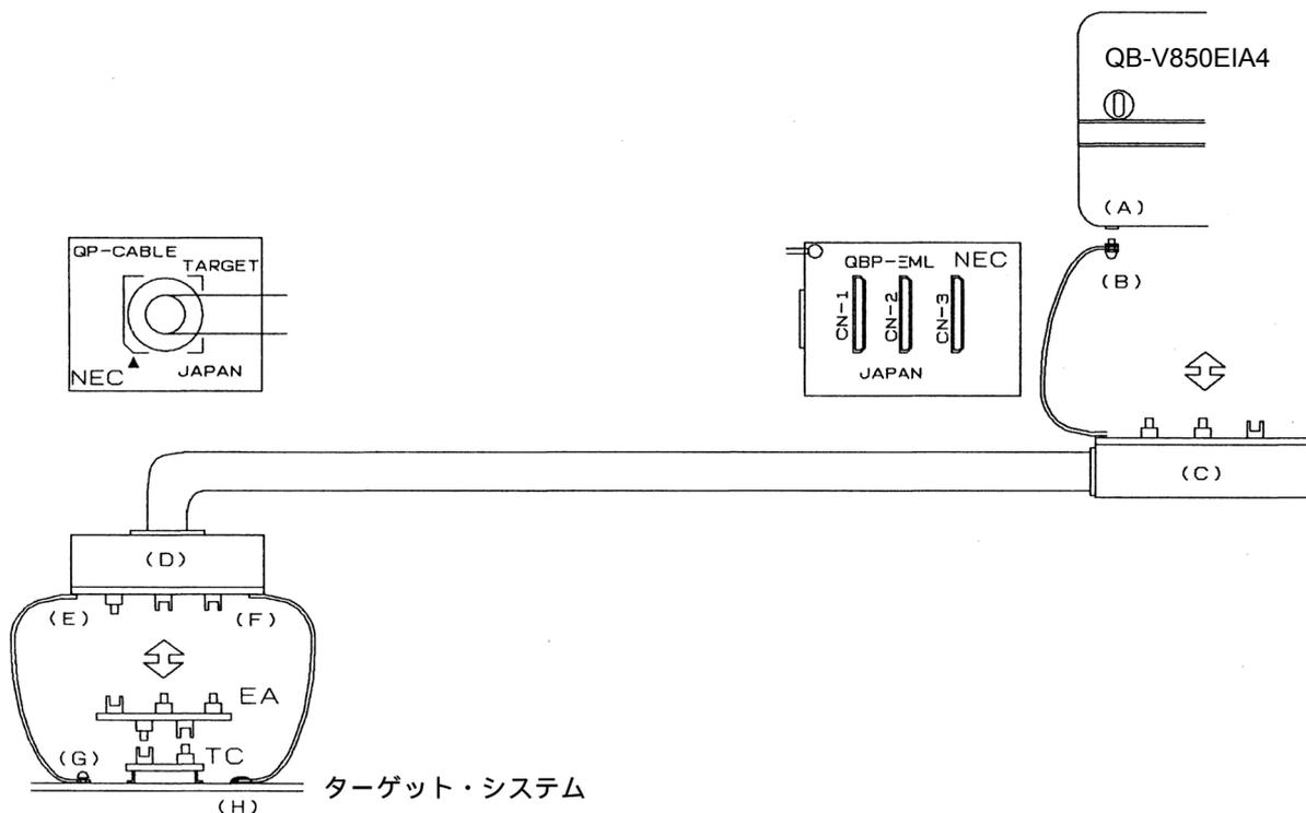
ターゲット・コネクタに、エキステンジ・アダプタ、延長プローブを接続します。
