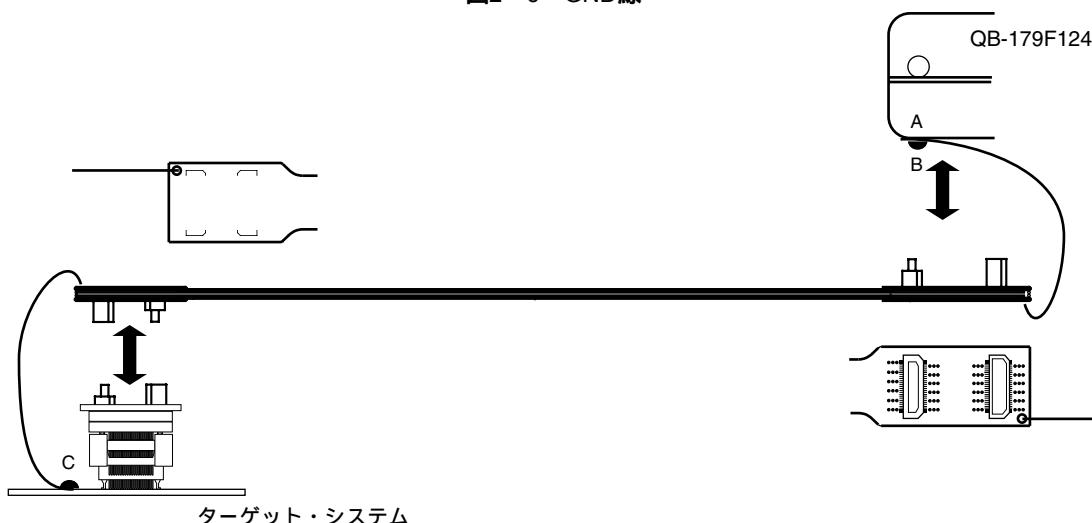
ターゲット・コネクタに, エクスチェンジ・アダプタ, エミュレーション・プローブを接続します。
