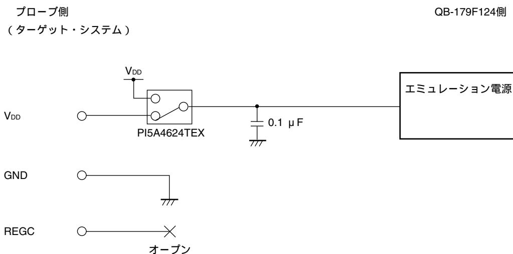
図4-2 エミュレーション回路の等価回路2(2/2)
