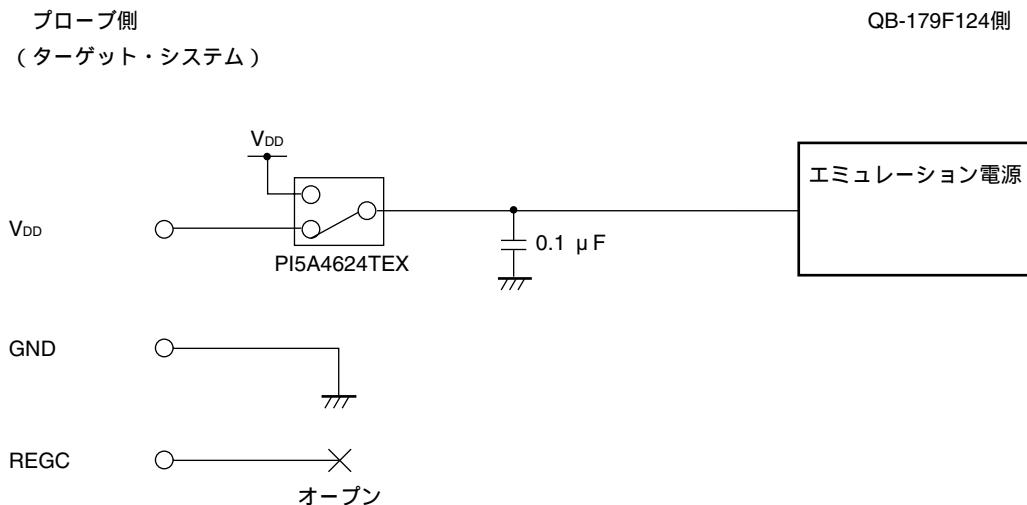
図4-1 エミュレーション回路の等価回路1(2/2)
