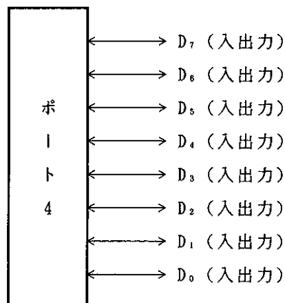
図9.3 16ビットバスモードの端子機能（ポート4）
