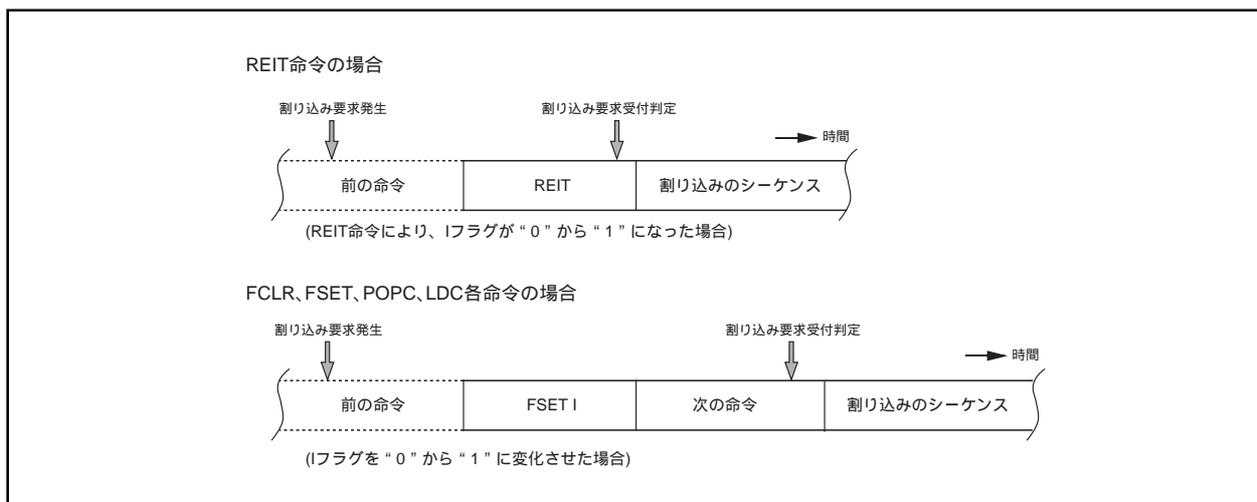
図4.2.3. Iフラグを変化させたときの割り込みへの反映のタイミング
