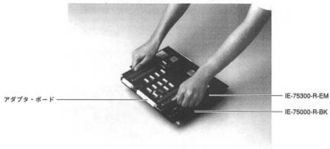
図2 - 5 IE-75300-R-EMとIE-75000-R-BKとアダプタ・ボードの接続
