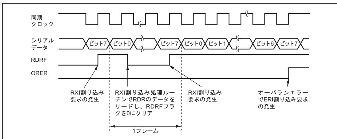
図 14.18 SCI の受信時の動作例
