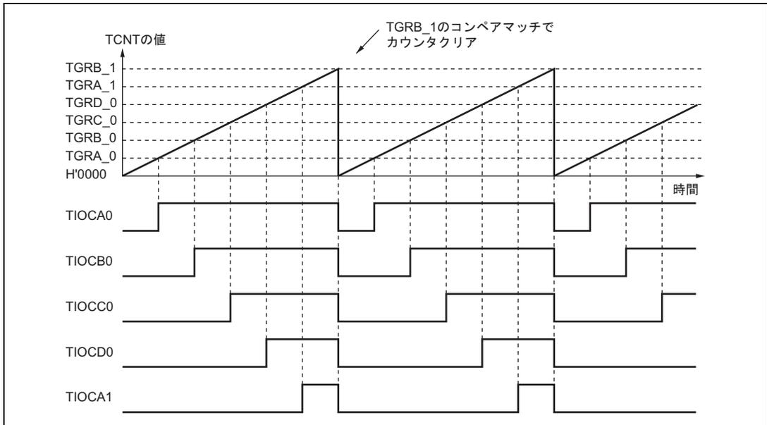
図 10.22 PWM モードの動作例 (2)
