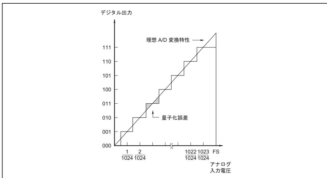
図 16.4 A/D 変換精度の定義
