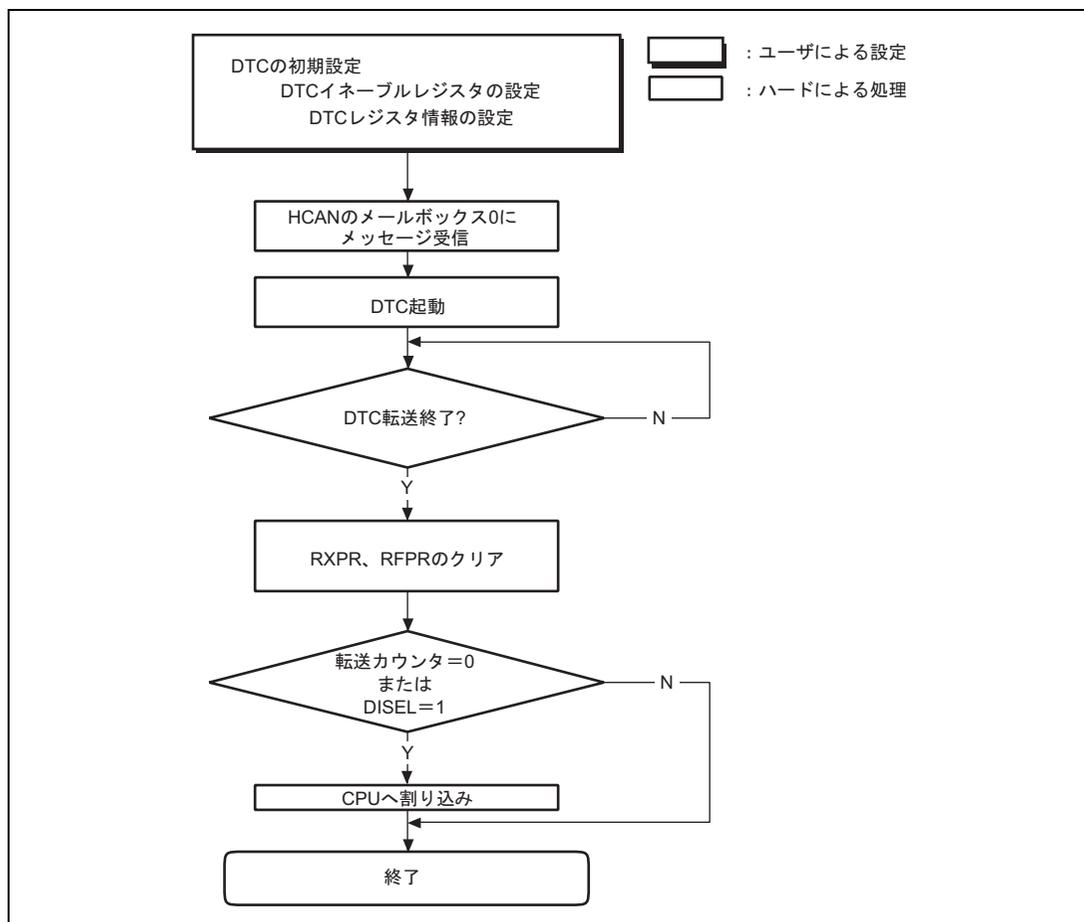
図 15.15 DTC の転送フローチャート
