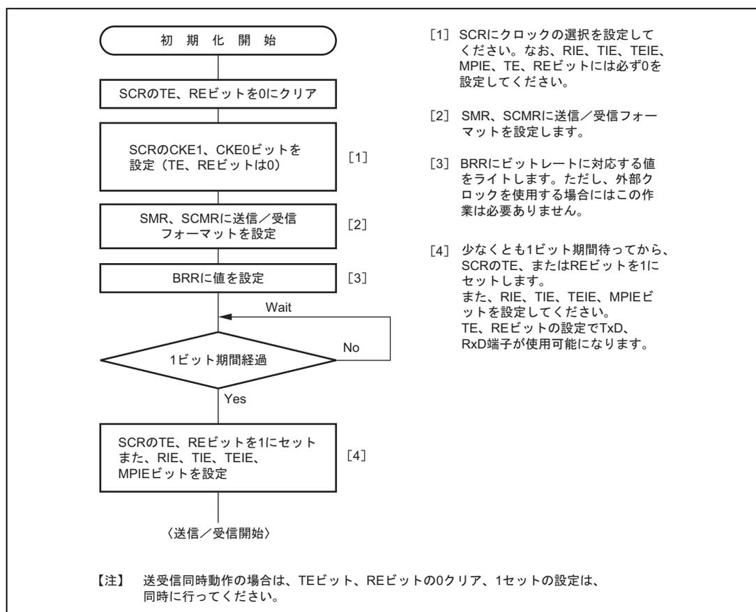
図 14.15 SCIの初期化フローチャートの例
