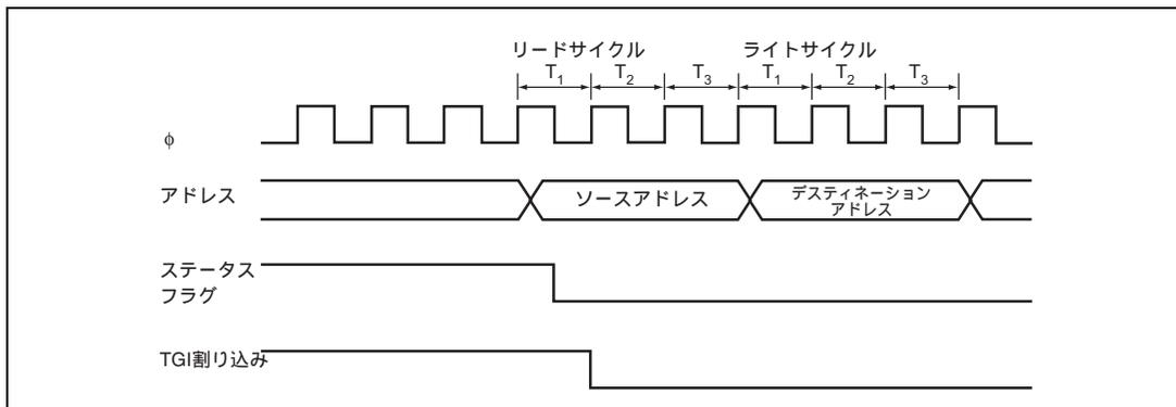
図 11.16 DTC によるステータスフラグのクリアタイミング
