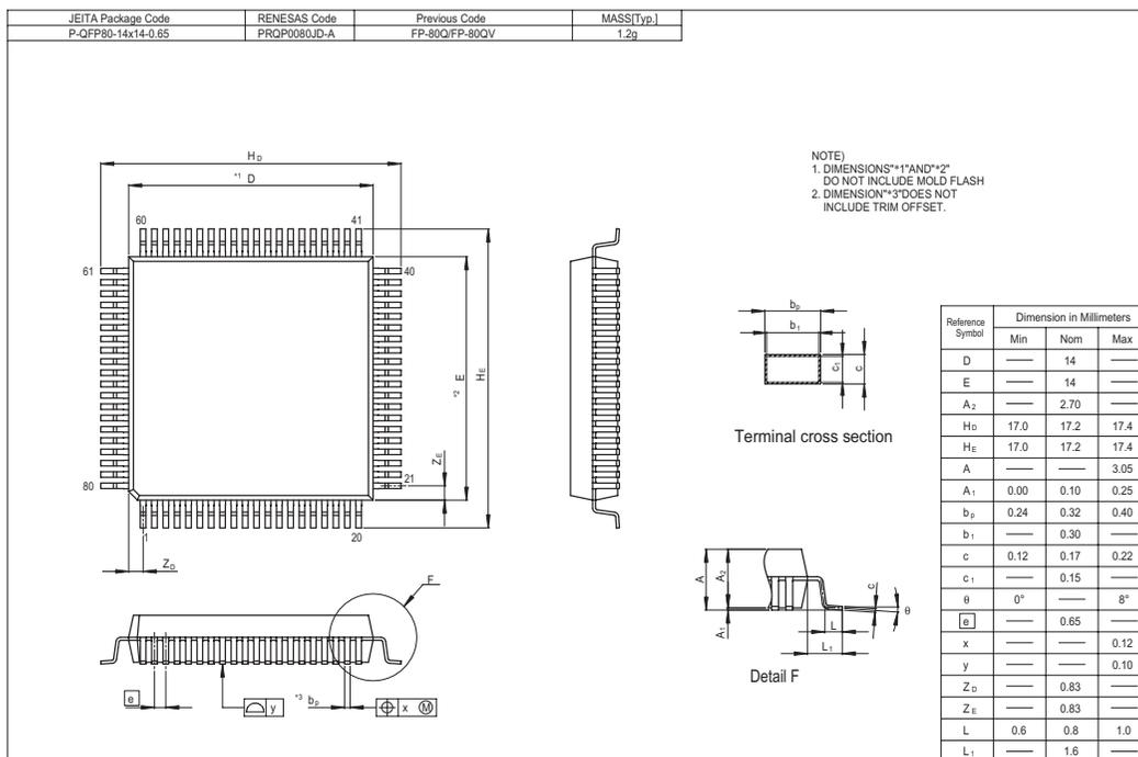
図 D.1 FP-80Q、FP-80QV 外形寸法図
