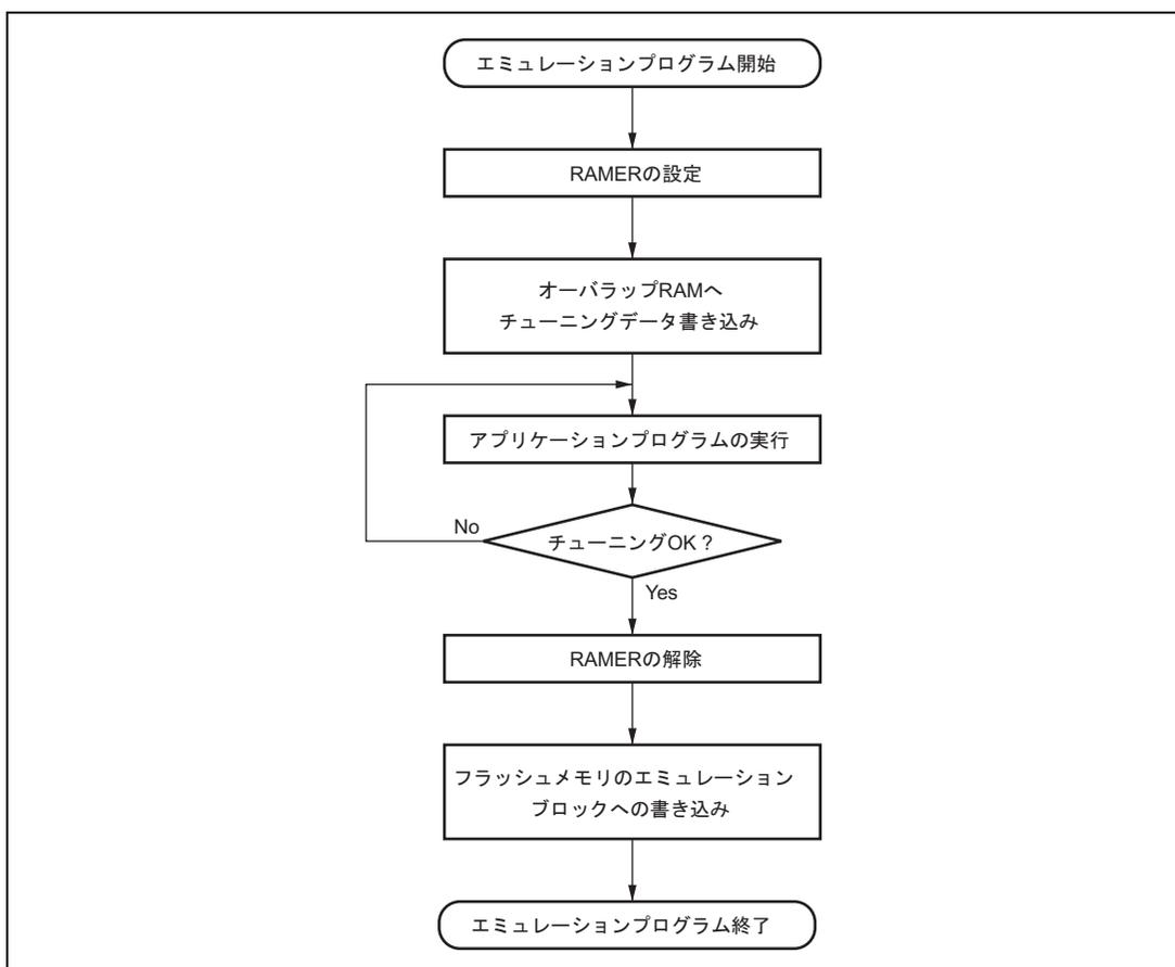
図 18.7 RAMによるエミュレーションフロー
