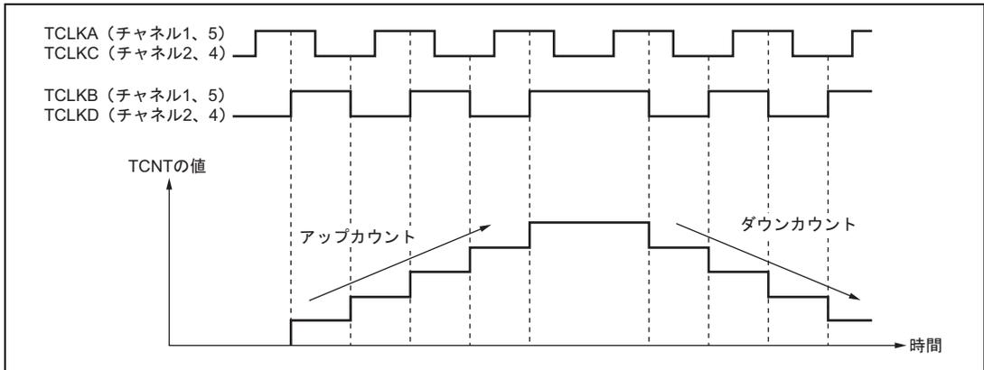
図 10.28 位相計数モード4の動作例
