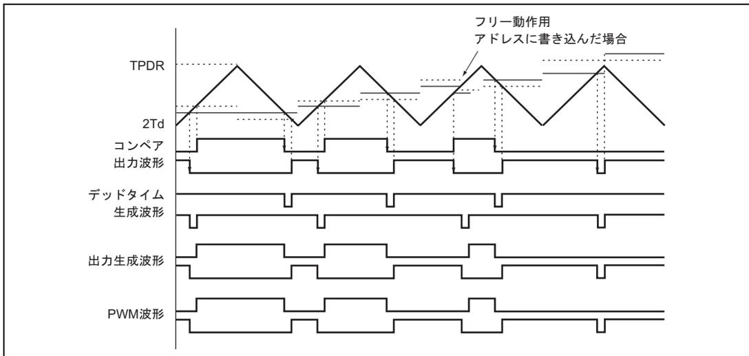
図 11.6 PWM 波形生成例
