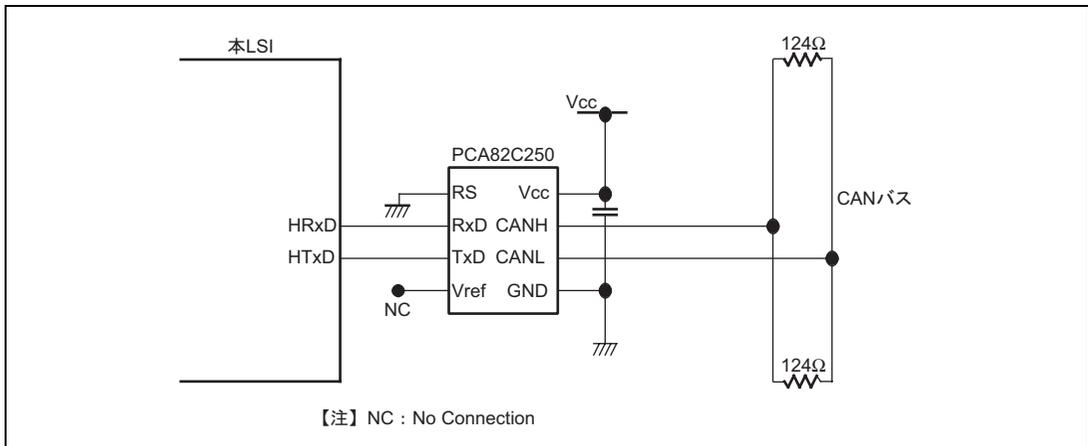
図 15.16 PCA82C250 を用いた高速インタフェース
