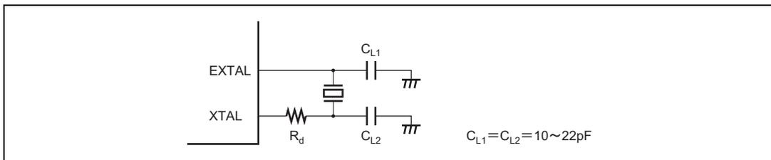
図 19.2 水晶発振子の接続例
