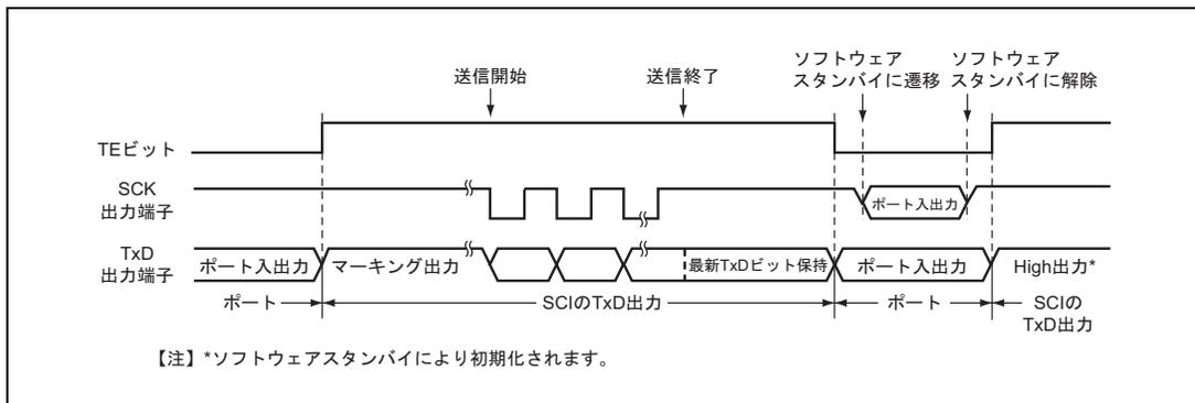
図 14.36 クロック同期式モード送信時 (内部クロック) の端子状態
