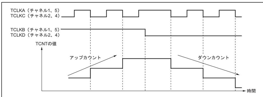
図 10.26 位相計数モード2の動作例
