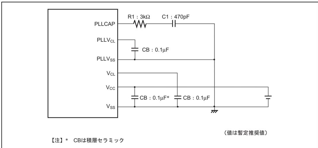
図 19.7 PLL 回路の外付け推奨回路
