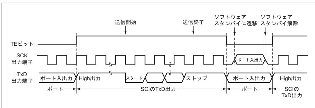
図 14.35 調歩同期式モード送信時（内部クロック）の端子状態
