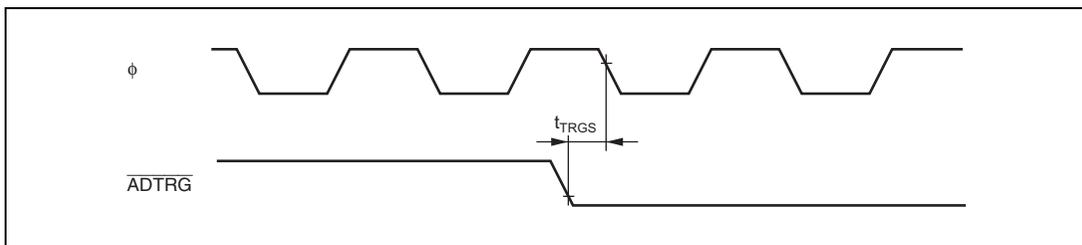
図 21.11 A/D 変換器外部トリガ入力タイミング
