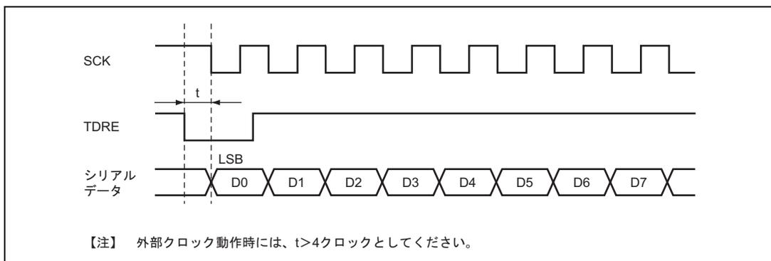
図 14.33 DTC によるクロック同期式送信時の例
