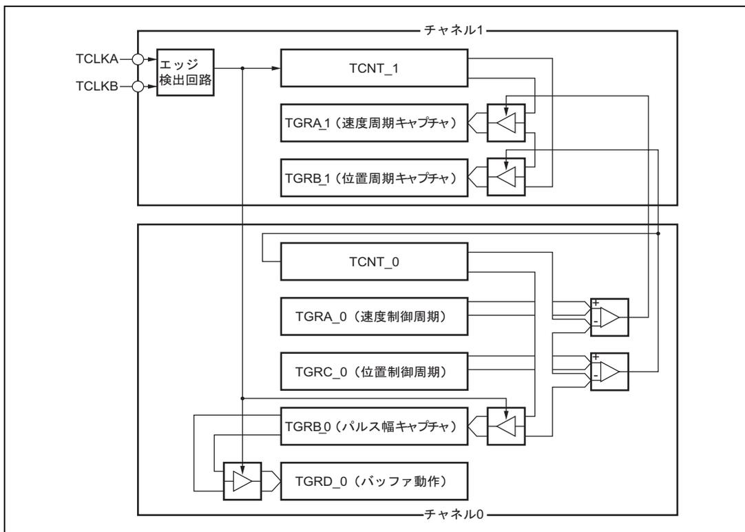
図 10.29 位相計数モードの応用例
