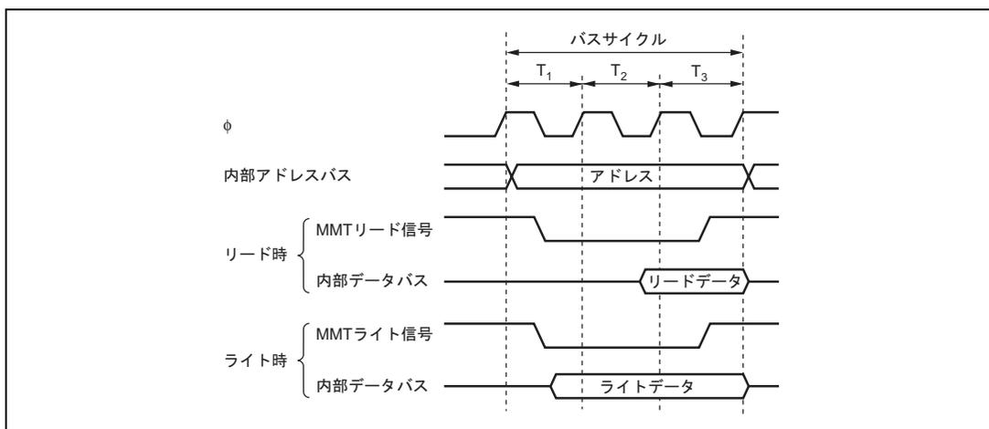
図 7.4 内蔵 MMT モジュールアクセスサイクル
