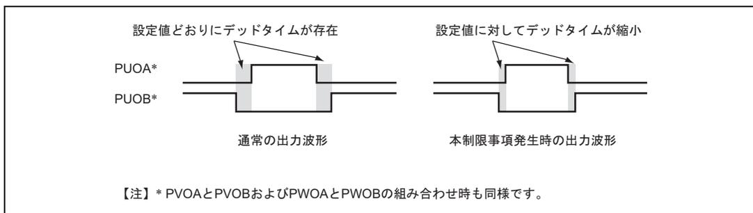
図 11.20 デッドタイム制限事項発生時の出力波形
