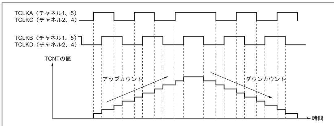
図 10.25 位相計数モード 1 の動作例
