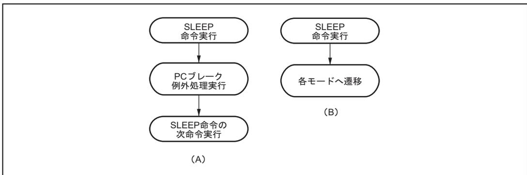
図 6.2 低消費電力モード遷移時の動作
