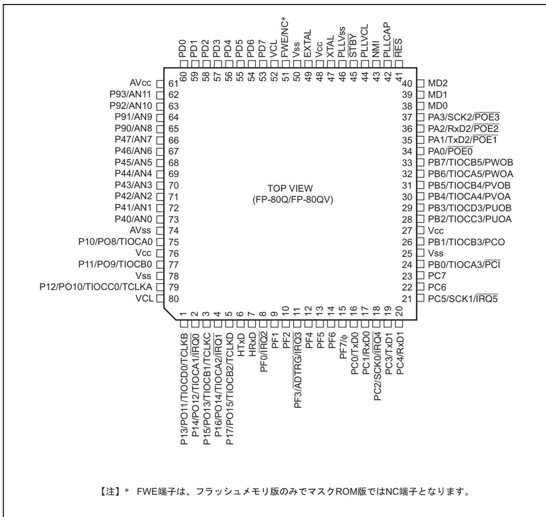
図 1.3 ピン配置図 (HD64F2612、HD6432612、HD6432611)
