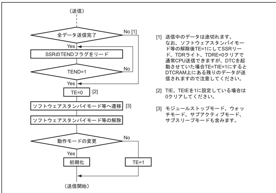
図 14.34 送信時のモード遷移フローチャートの例
