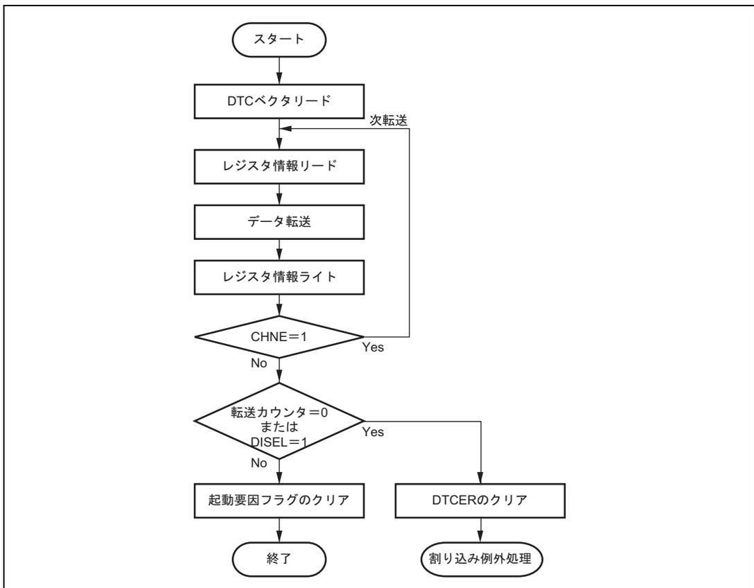
図 8.4 DTC 動作フローチャート
