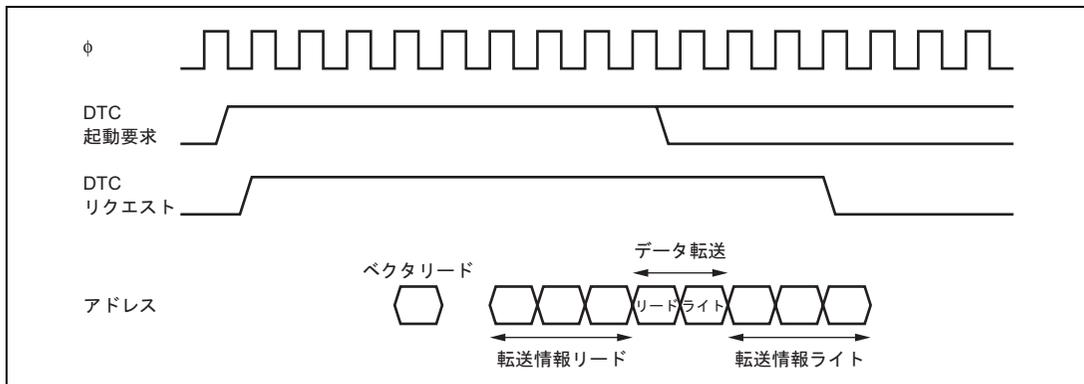
図 8.9 DTC の動作タイミング (ノーマルモード、リピートモードの例)
