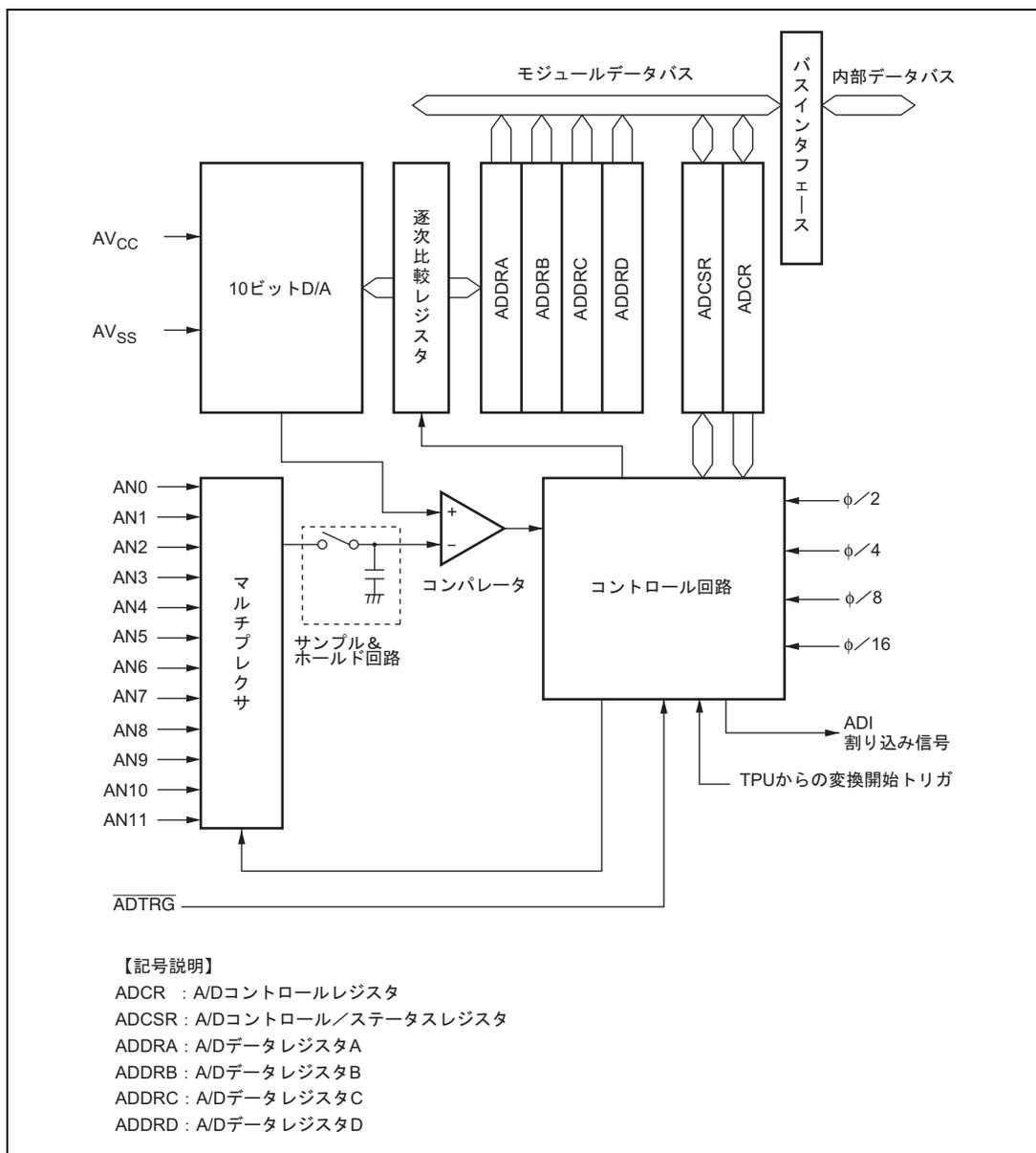
図 16.1 A/D 変換器のブロック図
