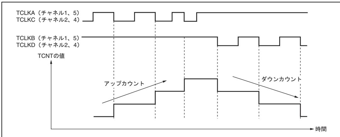
図 10.27 位相計数モード3の動作例
