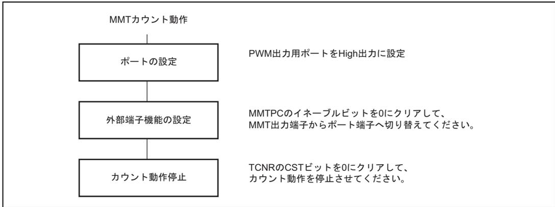
図 11.3 MMT 解除手順例
