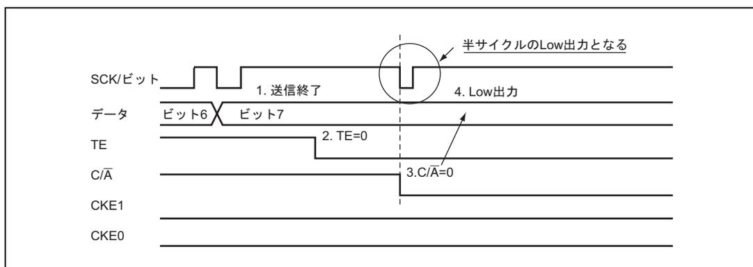
図 14.38 SCK 端子からポート端子へ切り替えるときの動作
