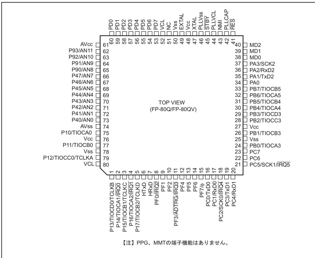
図 1.4 ピン配置図 (HD6432616、HD6432614)
