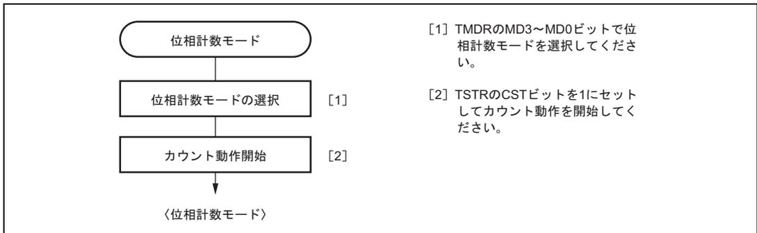
図 10.24 位相計数モードの設定手順例
