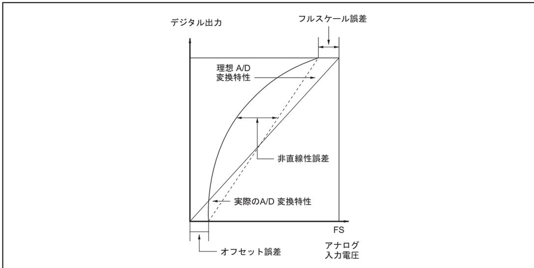
図 16.5 A/D 変換精度の定義
