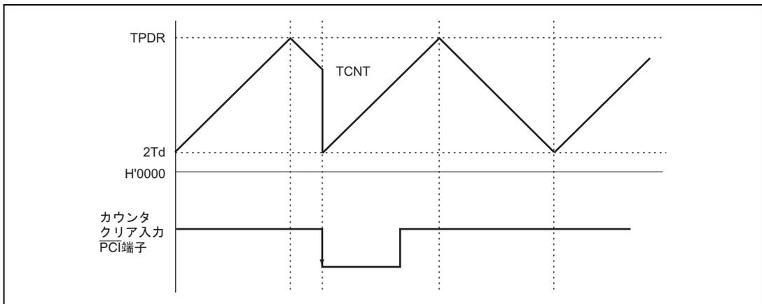
図 11.7 TCNT カウンタクリアの動作例
