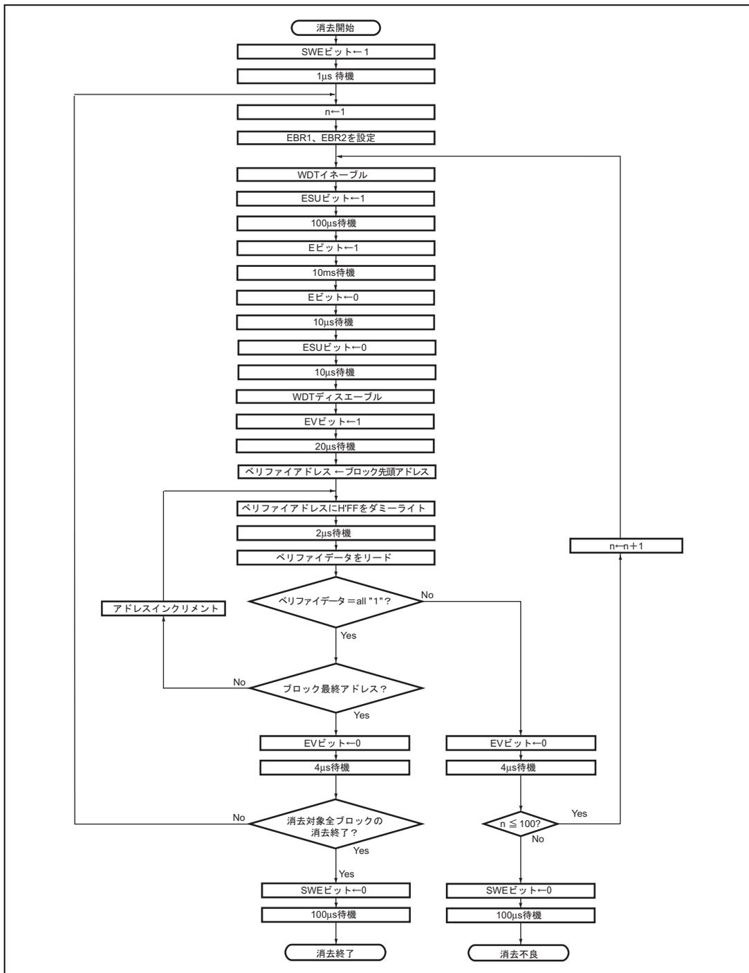
図 18.10 イレース/イレースベリファイフロー
