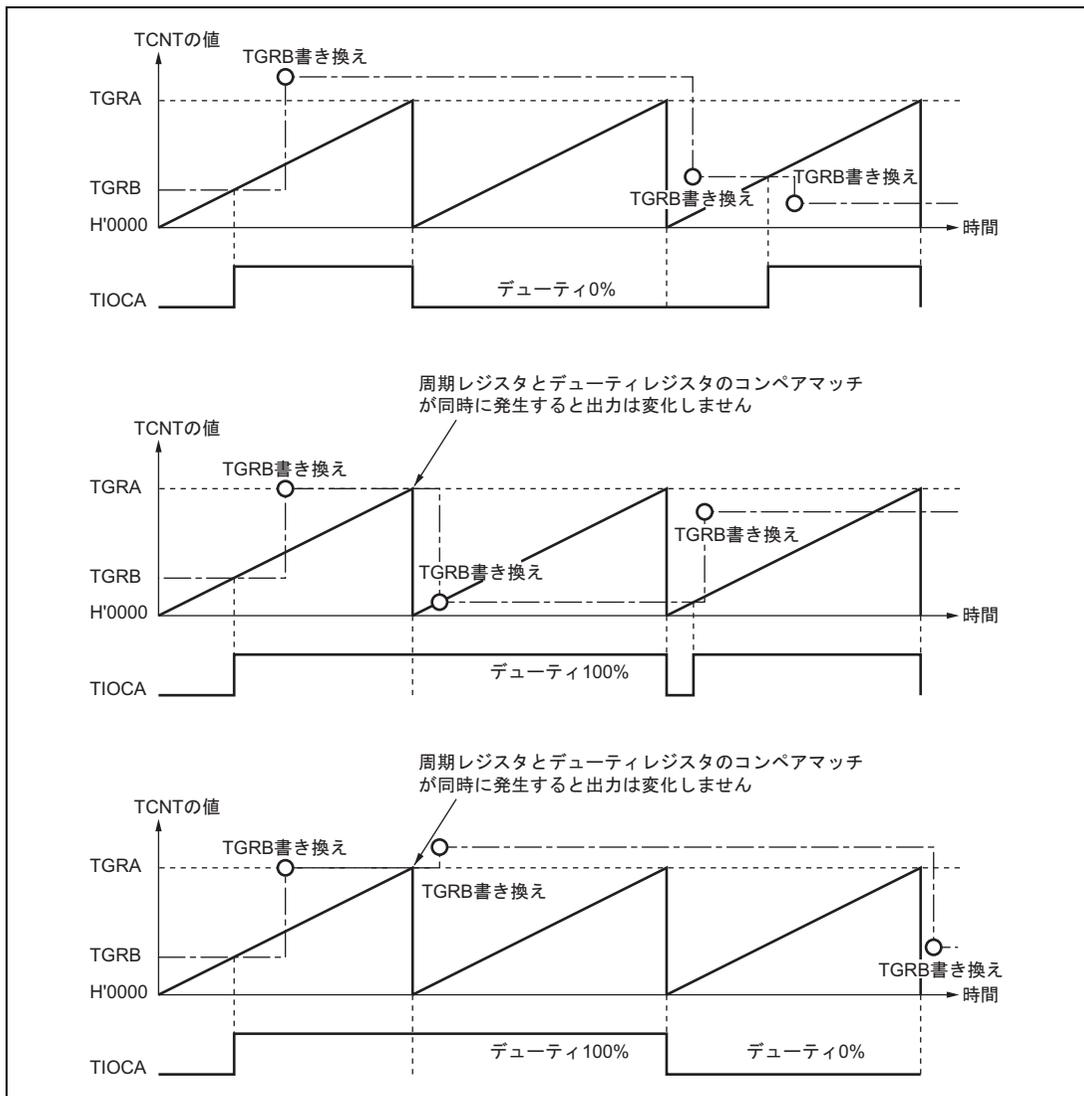
図 10.23 PWM モード動作例 (3)
