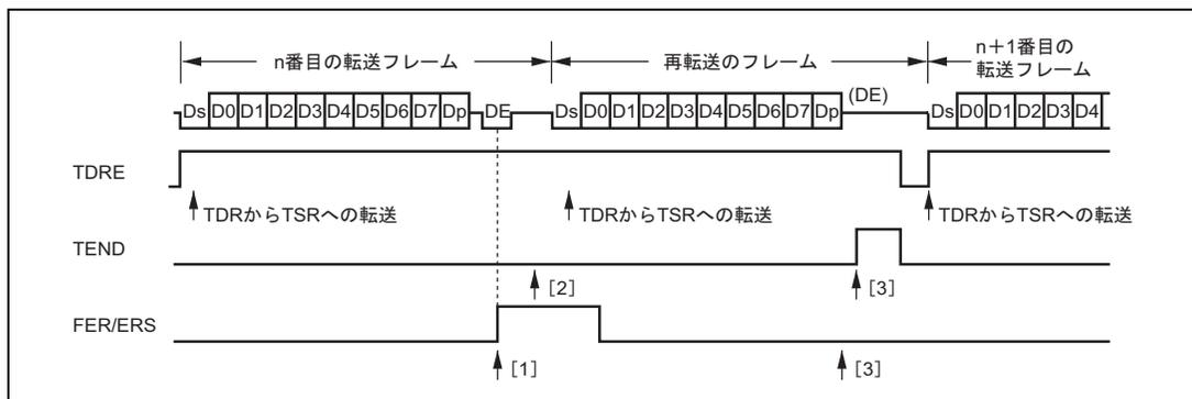
図 14.26 SCI 送信モードの場合の再転送動作
