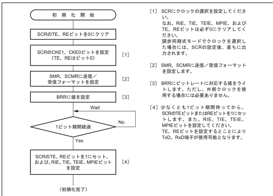
図 14.5 SCI の初期化フローチャートの例
