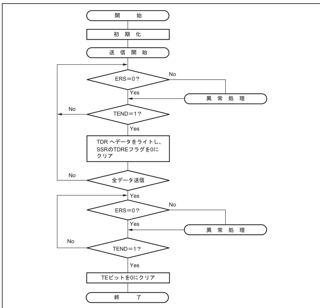
図 14.28 送信処理フローの例
