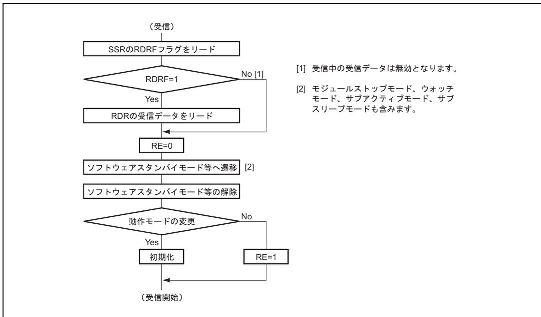
図 14.37 受信時のモード遷移フローチャートの例
