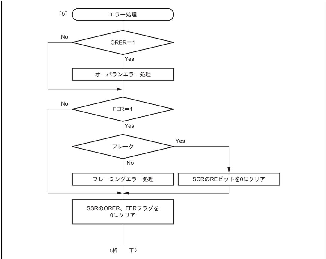
図 14.13 マルチプロセッサシリアル受信のフローチャートの例 (2)
