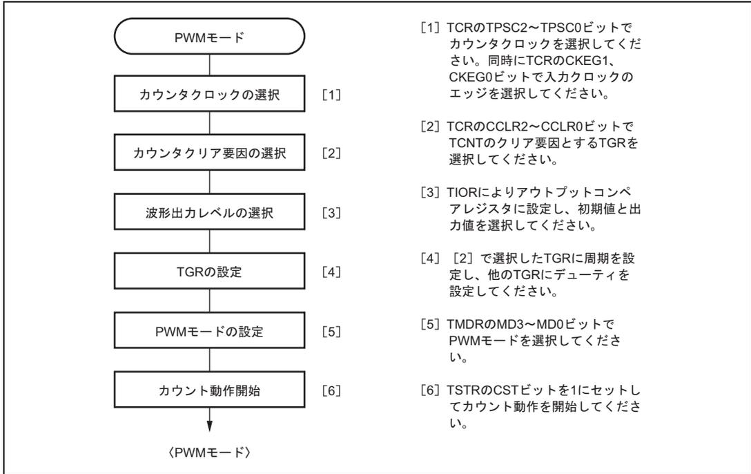
図 10.20 PWMモードの設定手順例
