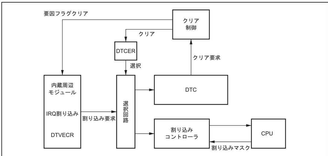
図 8.2 DTC 起動要因制御ブロック図
