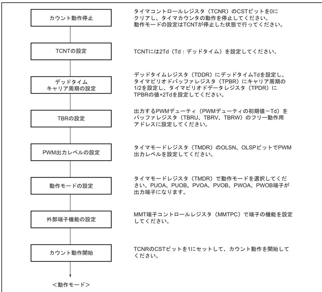
図 11.2 動作モードの設定手順例
