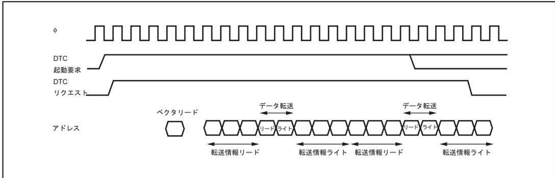
図 8.11 DTC の動作タイミング (チェーン転送の例)
