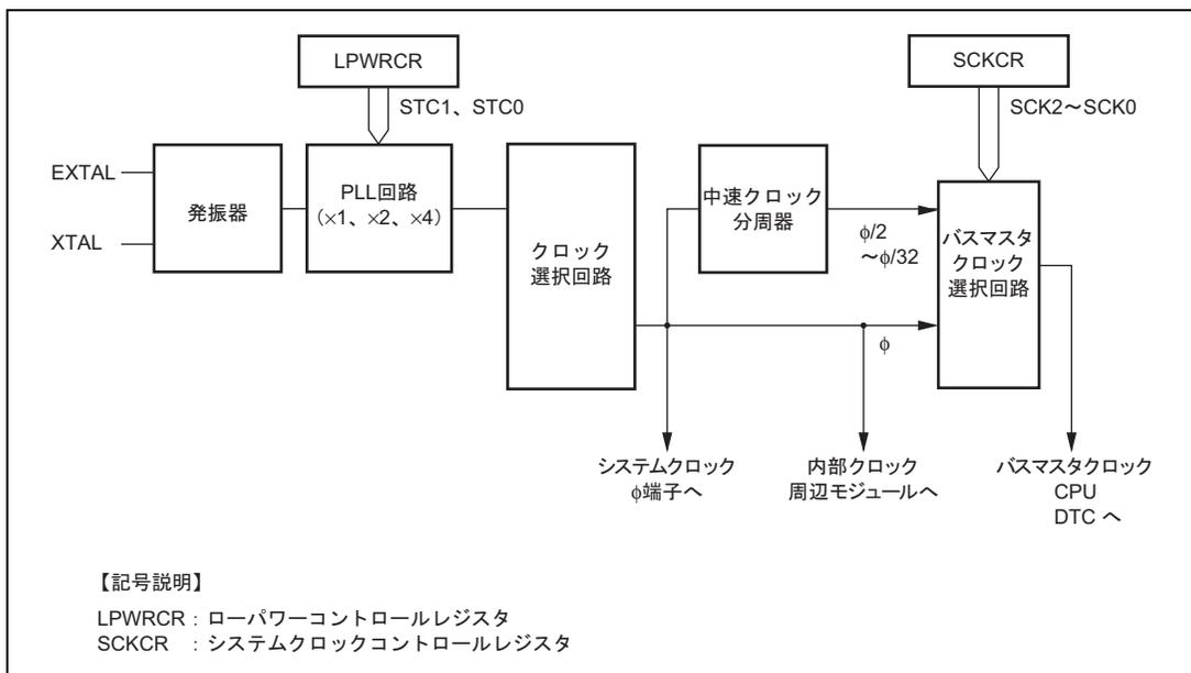
図 19.1 クロック発振器のブロック図
