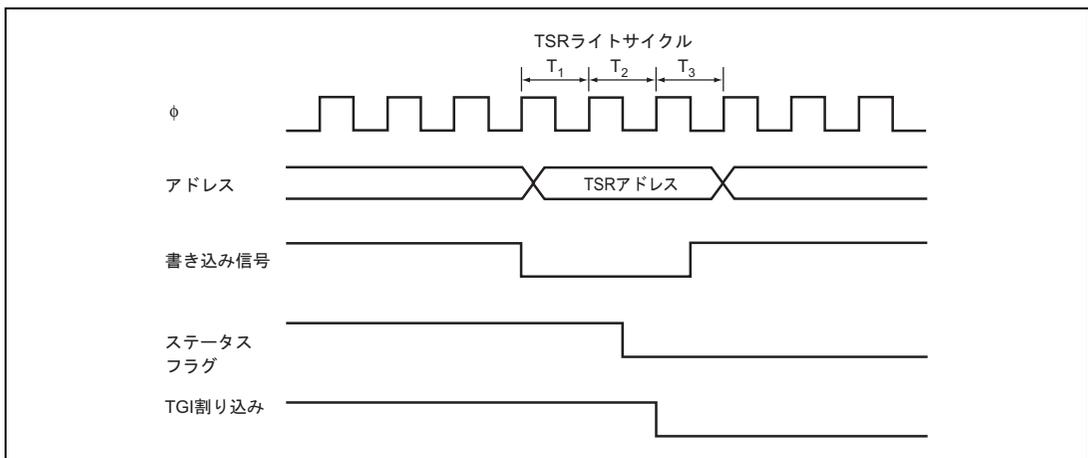
図 11.15 CPU によるステータスフラグのクリアタイミング
