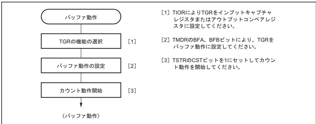
図 10.14 バッファ動作の設定手順例
