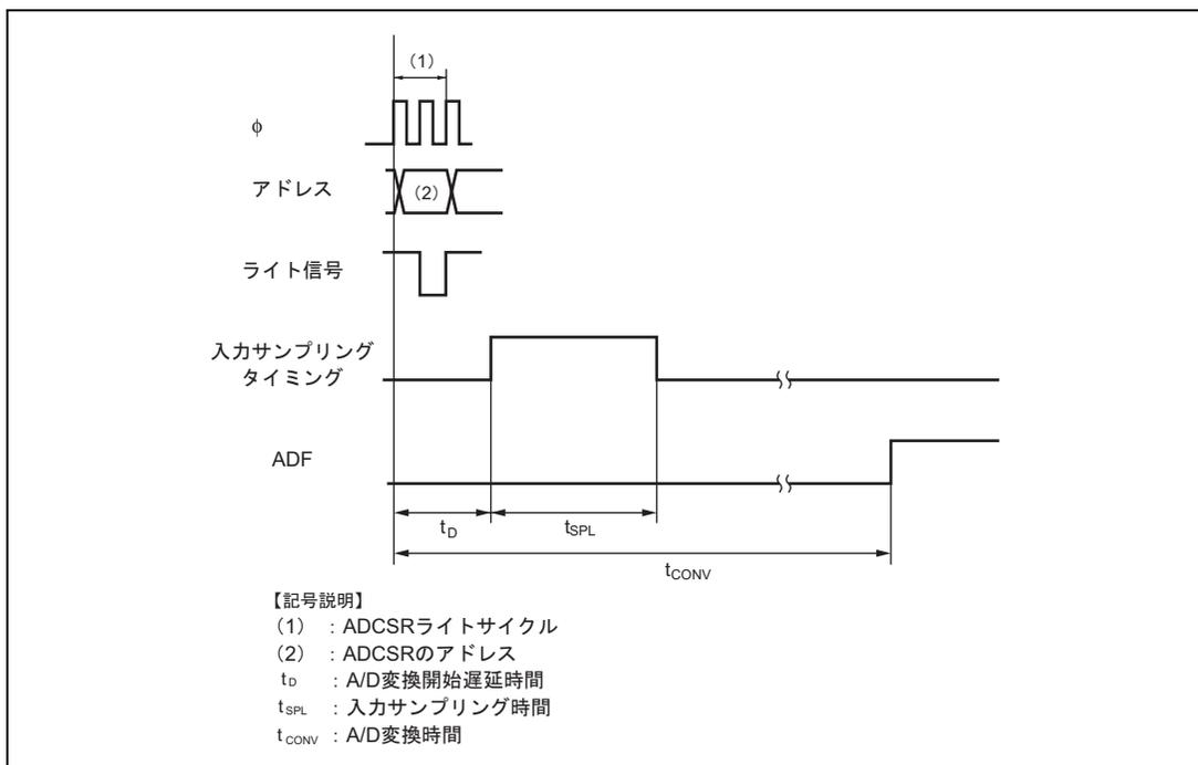
図 16.2 A/D 変換タイミング
