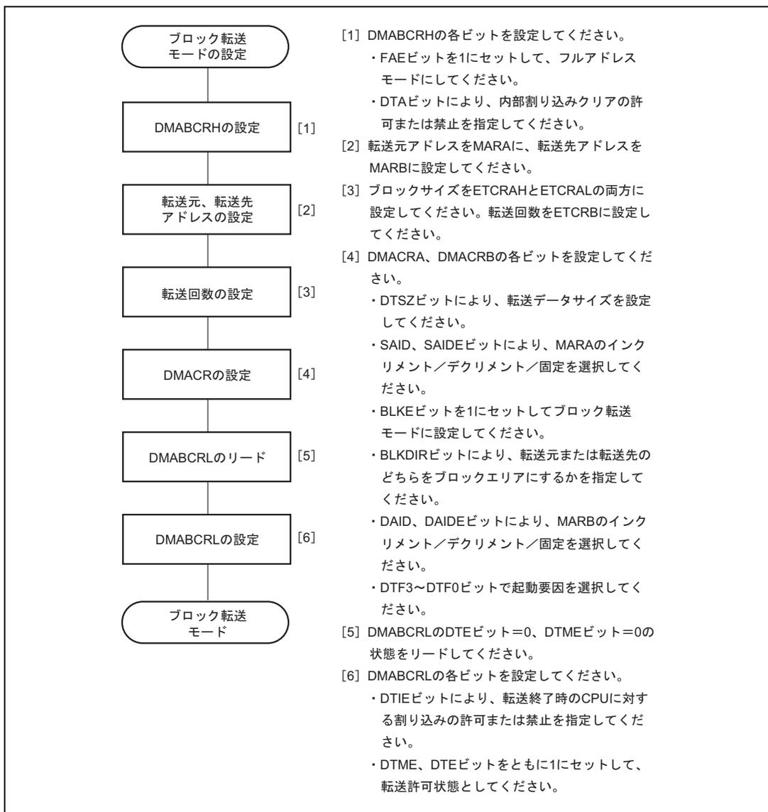
図 7.16 ブロック転送モードの設定手順例
