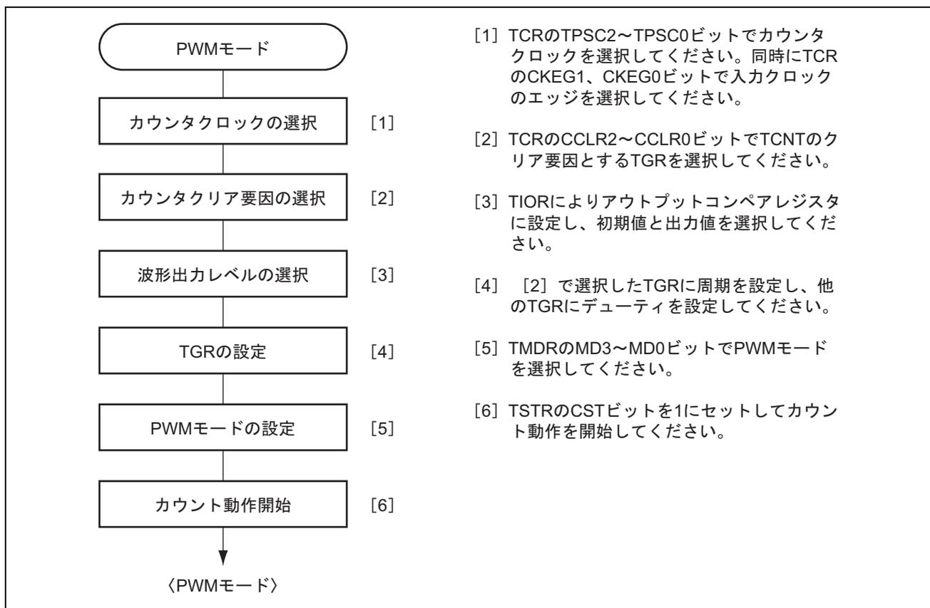
図 10.21 PWM モードの設定手順例
