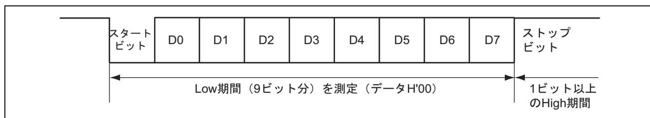
図 24.7 ビットレートの自動合わせ込み
