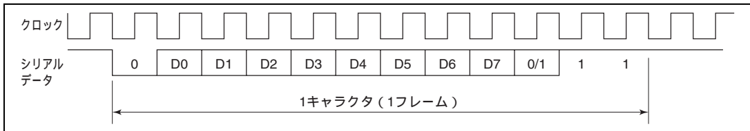
図 10.9 出力クロックと通信データの位相関係（調歩同期式モード） （8 ビットデータ / パリティあり / 2 ストップビットの例）
