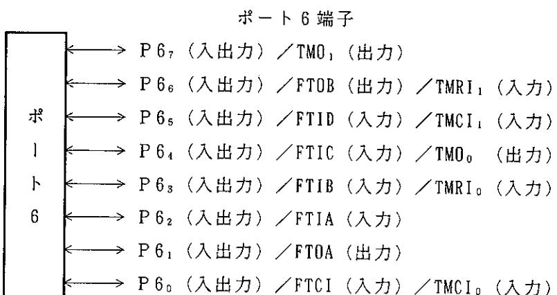
図 7.14(b) H 8 / 3 5 2 2 のポート 6 の端子構成
