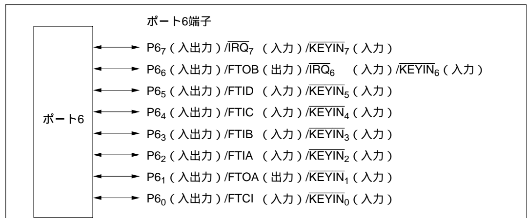
図 7.14 ポート6の端子構成
