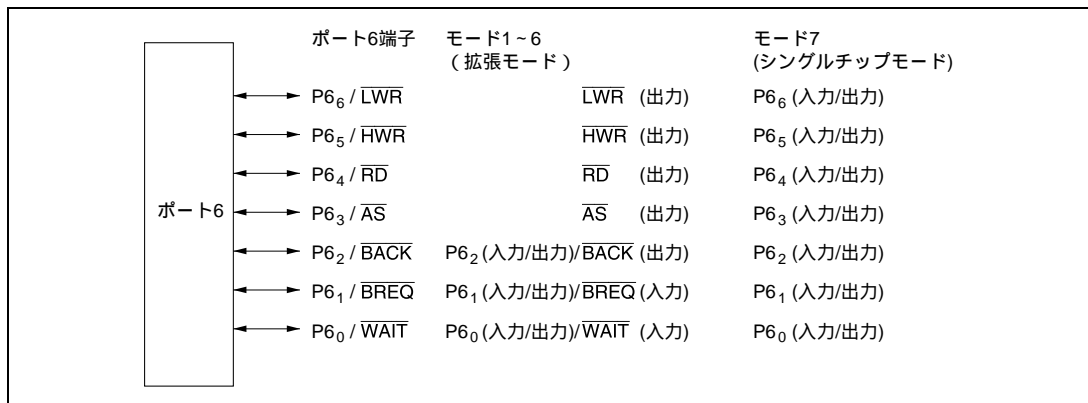
図 9.6 ポート 6 の端子構成
