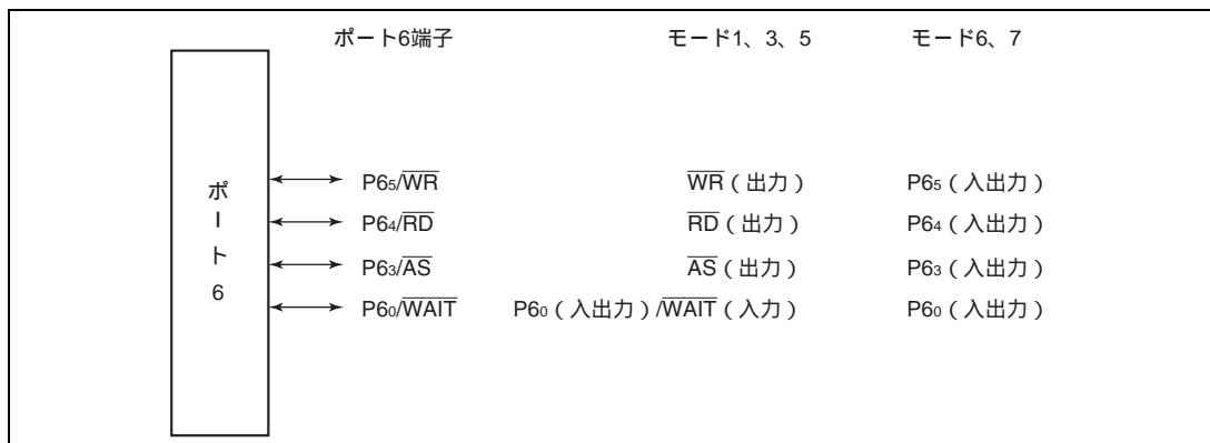
図 7.16 ポート 6 の端子構成
