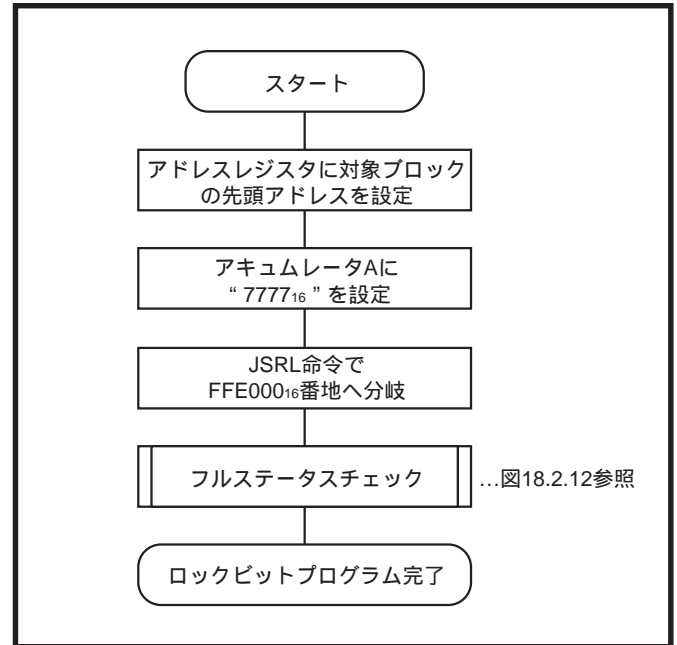
図18.2.8 ロックビットプログラムフローチャート
