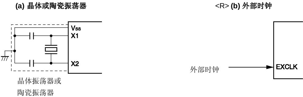
图 6-9. X1 振荡器的外部电路示例
