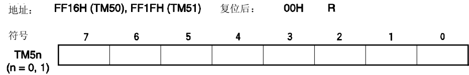
图 8-3. 8 位定时器计数器 5n（TM5n）的格式
