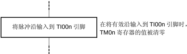
<2> TM0n 寄存器清零&启动流程
