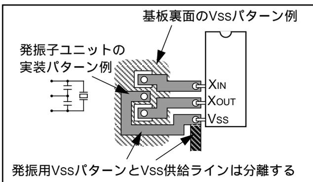
図3.4.10 発振子の裏面のVssパターン
