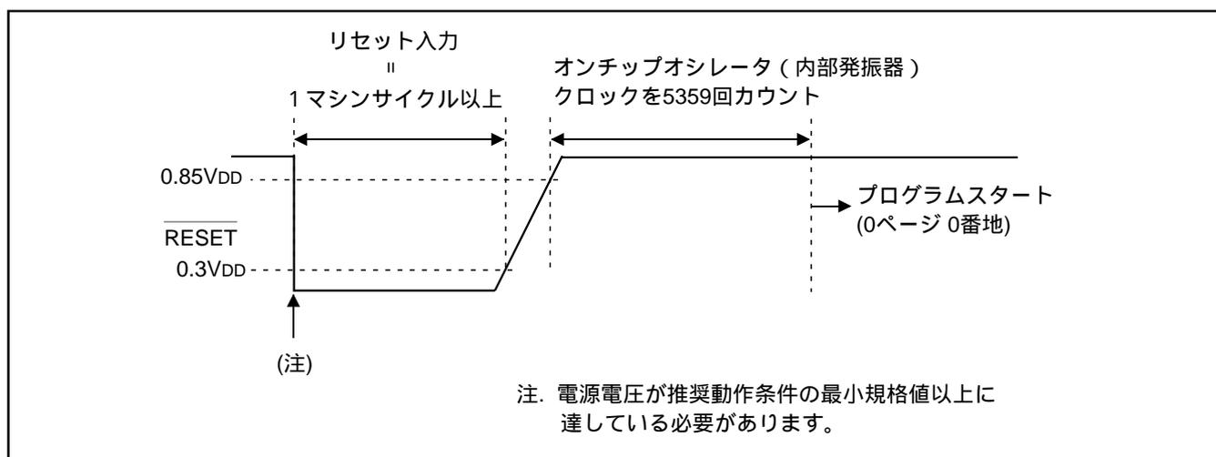
図VB-2．RESET端子の入力波形とリセット動作
