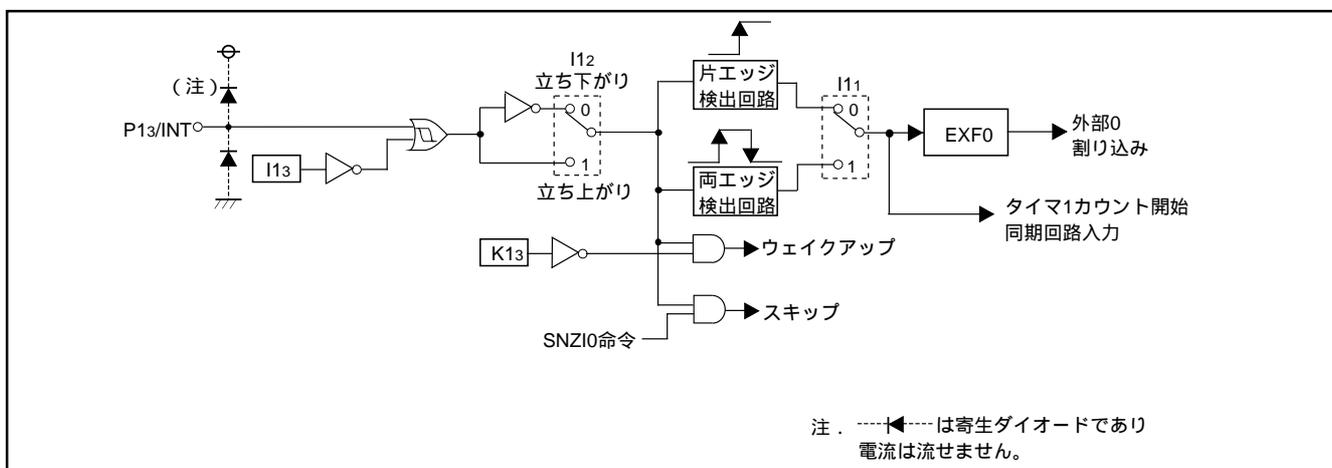
図DD-5 . 外部割り込み回路の構成
