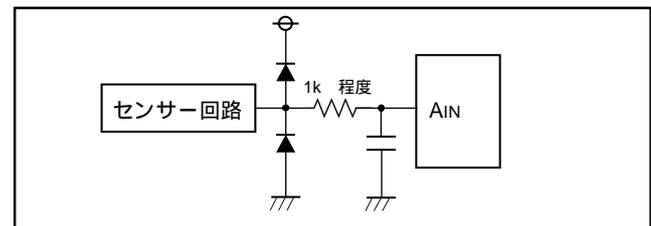
図XB-6 . アナログ入力外付け回路例2
