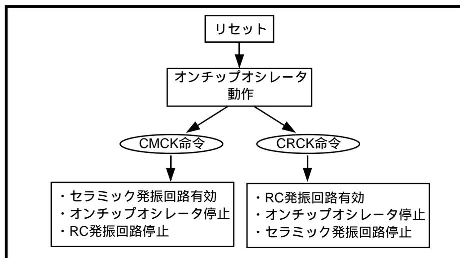
図2.8.1 セラミック共振 / RC発振への切り替え
