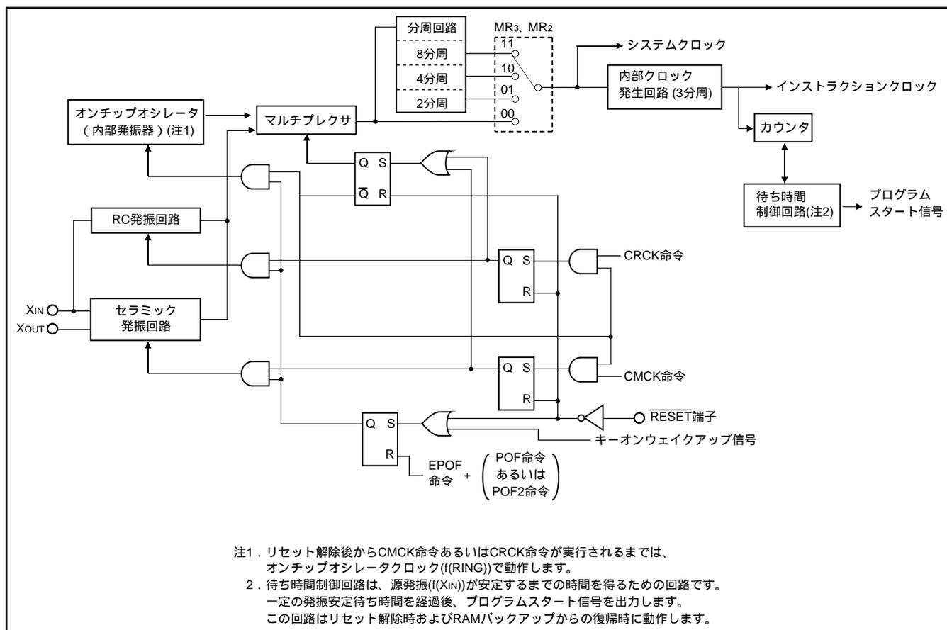
図WA-1. クロック制御回路の構成
