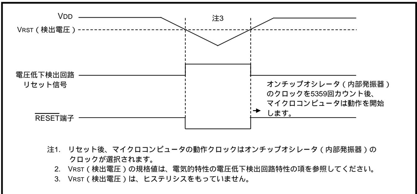
図2.6.2 電圧低下検出回路の動作波形例
