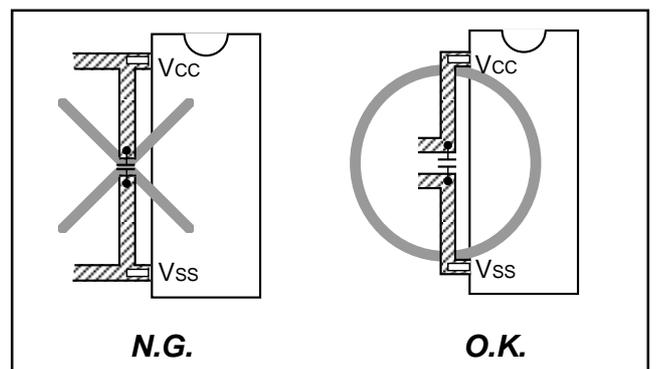
図3.4.6 Vss - VDDライン間のバイパスコンデンサ
