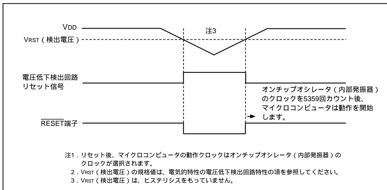
図VC-2 . 電圧低下検出回路動作波形
