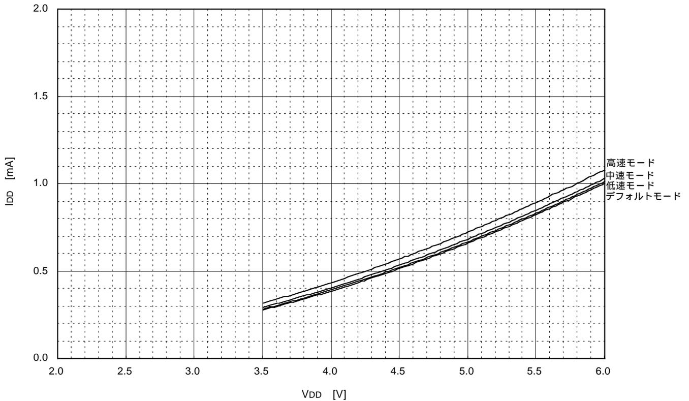
(5) 電源電流(R-IDD)特性(  $T_a=25$  、RC発振、 $V_{DD}=5V$ 、 $C=33pF$  )
