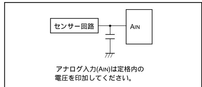
図XB-5 . アナログ入力外付け回路例1
