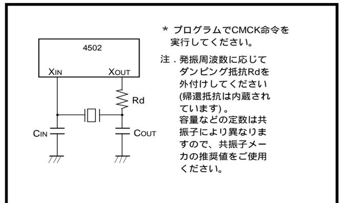
図2.8.3 セラミック共振子外付回路
