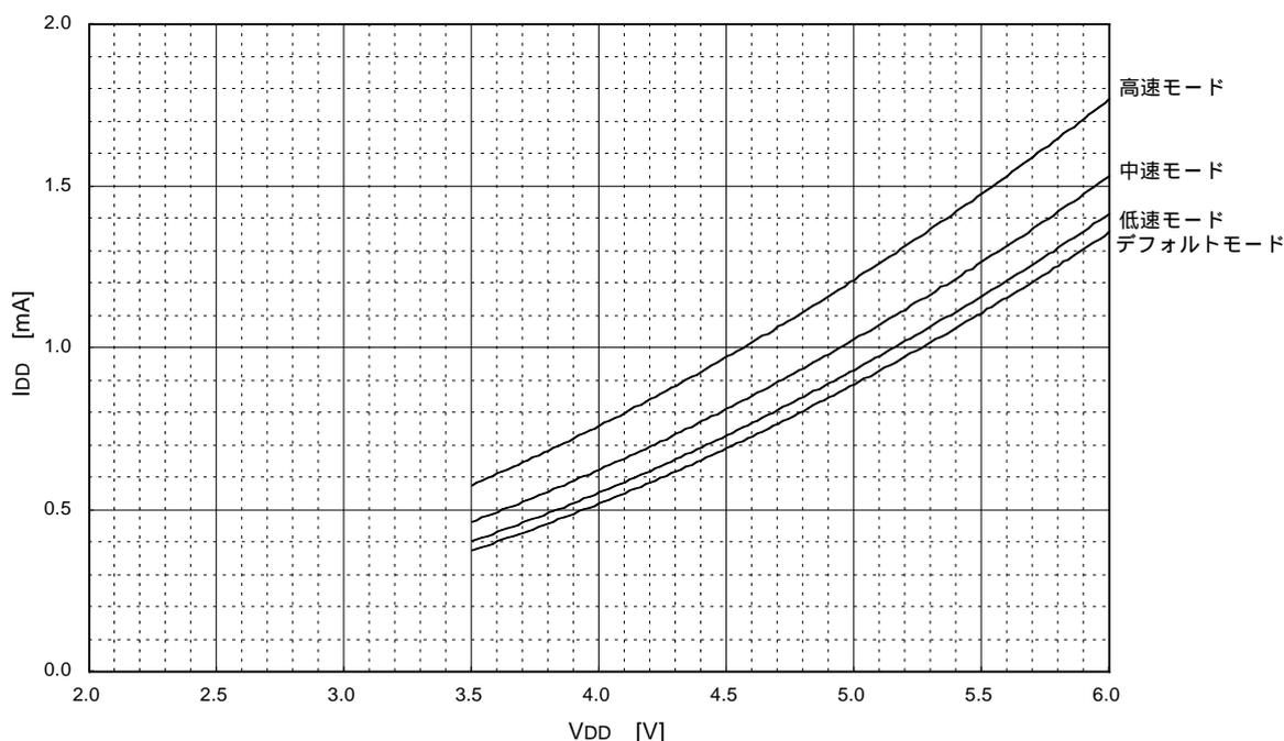
(3) VDD-I<sub>DD</sub>特性( Ta=25℃、f(XIN)=1MHz、セラミック発振 )
