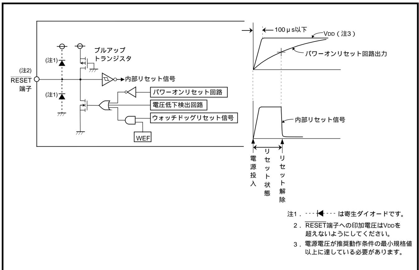
図2.5.1 RESET端子周辺の構成とパワーオンリセット動作
