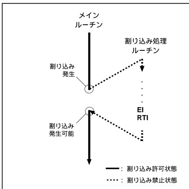
図DD-1 . 割り込み処理プログラム例
