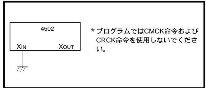
図2.8.2 オンチップオシレータ動作時の $XIN$ 、 $XOUT$ 端子の処理
