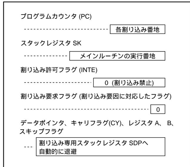
図DD-2 . 割り込み発生時の内部状態
