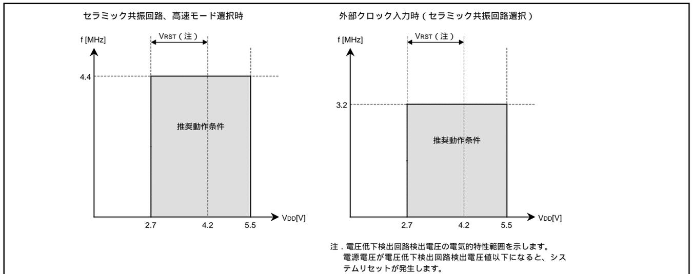
表3.1.3 推奨動作条件2(指定のない場合は、 $T_a = -20 \sim 85$ 、 $V_{DD} = 2.7 \sim 5.5V$ )
