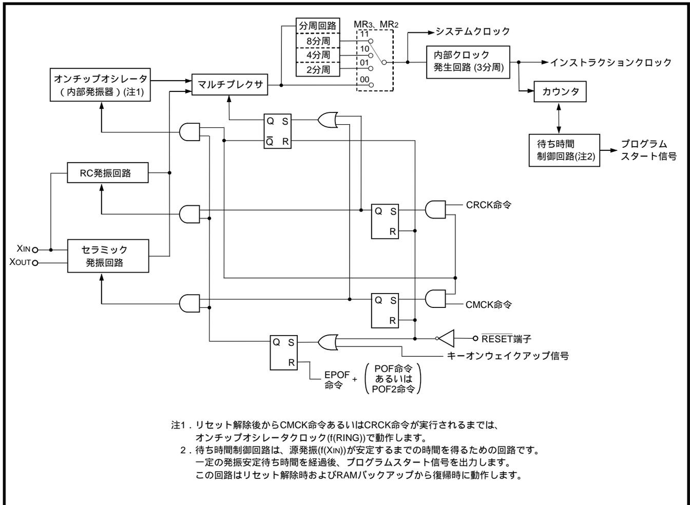
図2.8.5 クロック制御回路の構成
