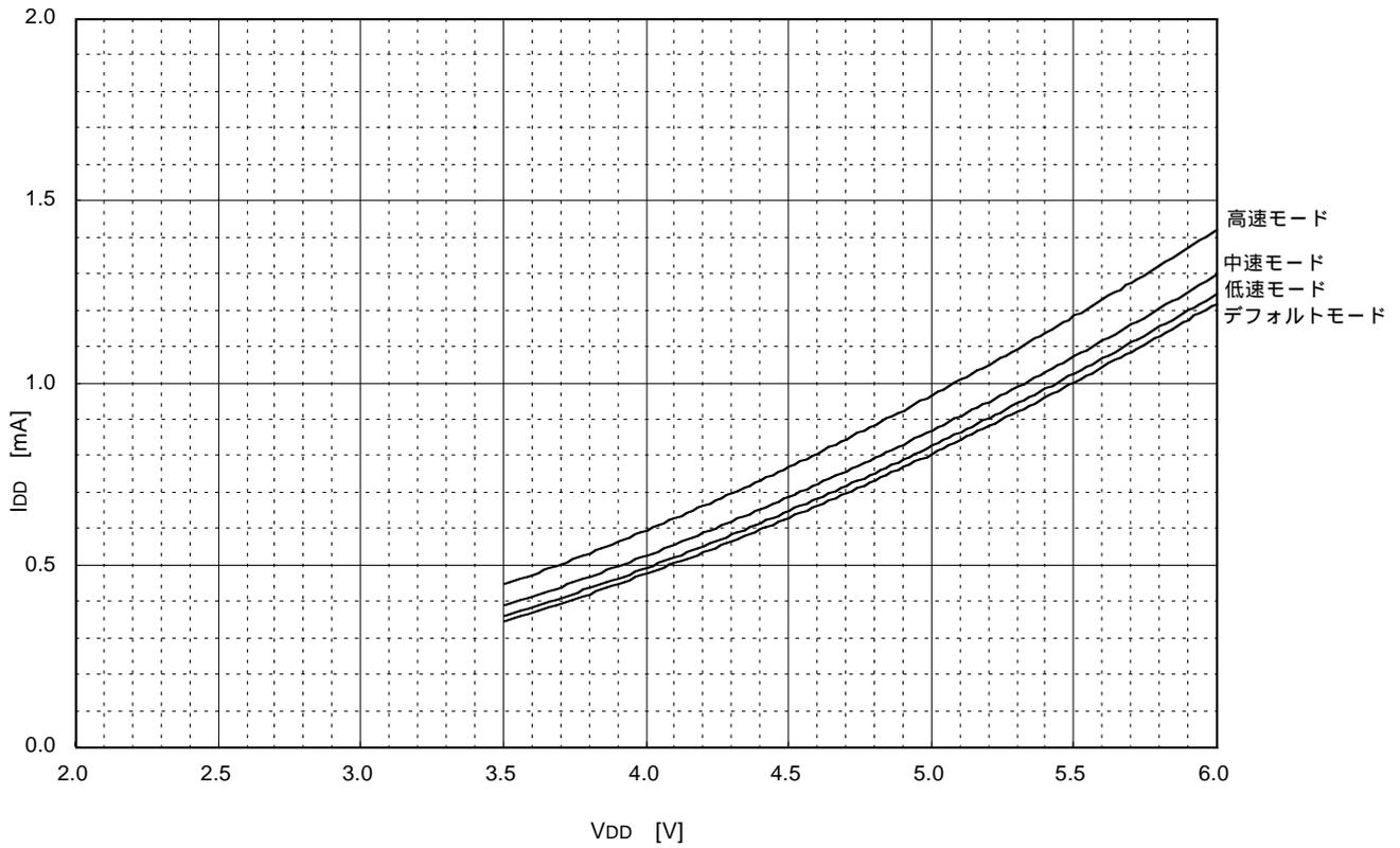
(4) VDD-I<sub>DD</sub>特性( Ta=25℃、f(XIN)=400kHz、セラミック発振 )
