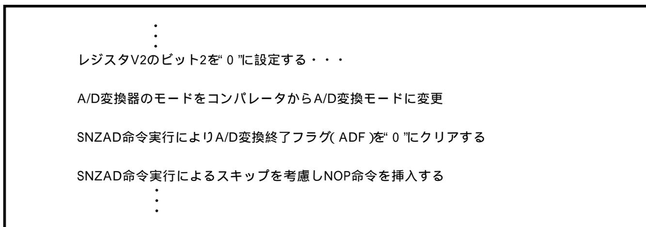
図3.3.7 A/D変換器の動作モードプログラム例
