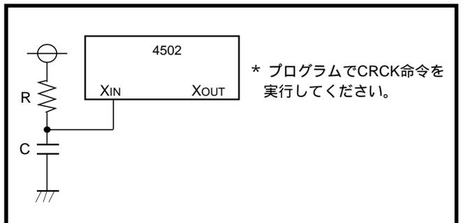
図2.8.4 RC発振外付け回路
