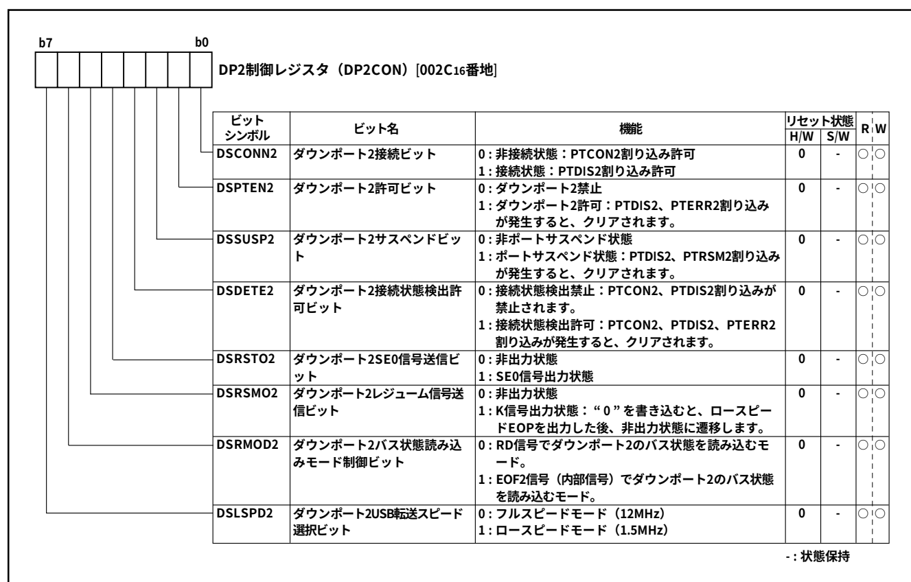
図3.4.62 DP2制御レジスタ(DP2CON)の構成
