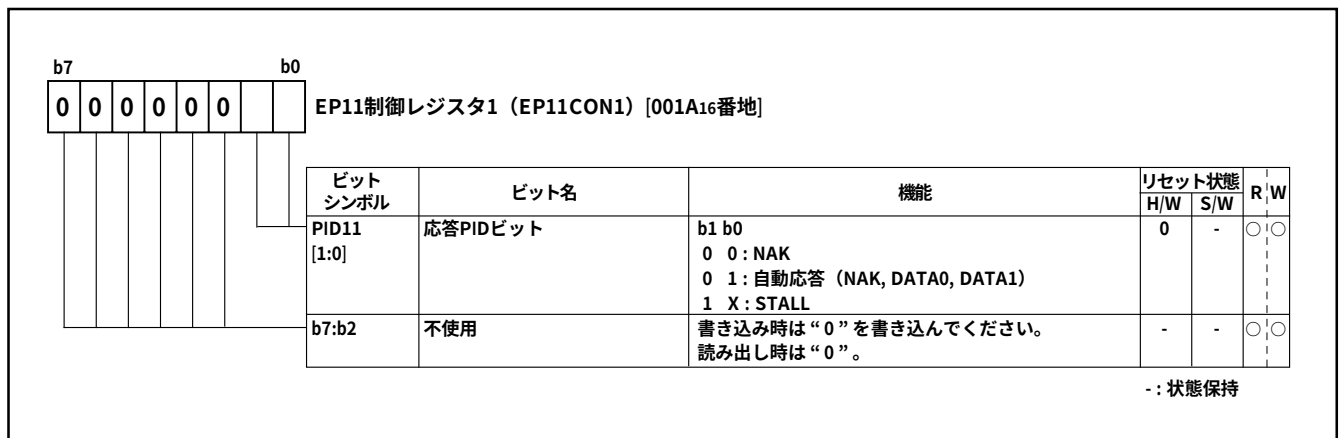
図3.4.23 EP11制御レジスタ1(EP11CON1)の構成
