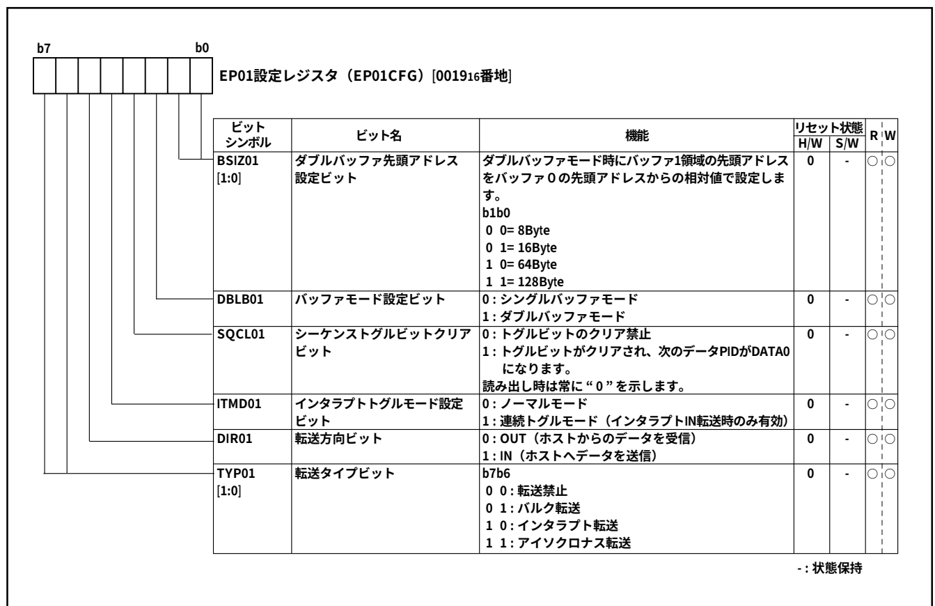
図3.4.13 EP01設定レジスタ(EP01CFG)の構成
