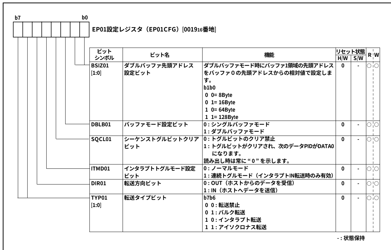
図46. EP01設定レジスタ(EP01CFG)
