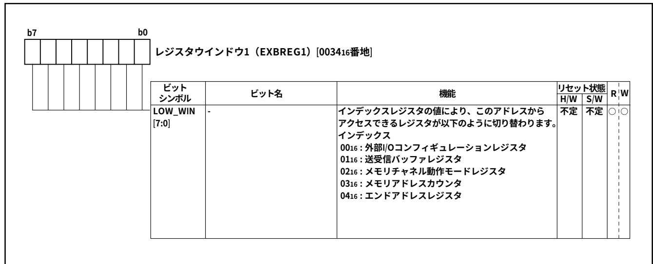
図3.4.68 レジスタウィンドウ1(EXBREG1)の構成
