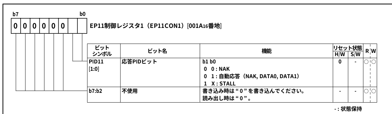
図81. EP11制御レジスタ1(EP11CON1)
