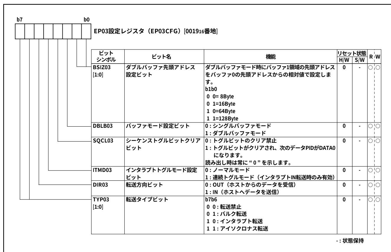
図3.4.15 EP03設定レジスタ(EP03CFG)の構成
