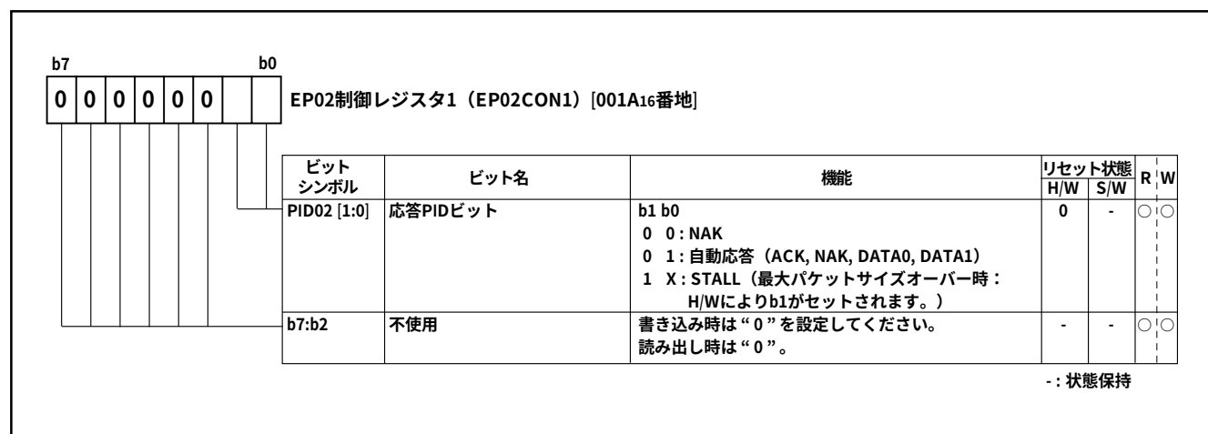
図3.4.20 EP02制御レジスタ1(EP02CON1)の構成
