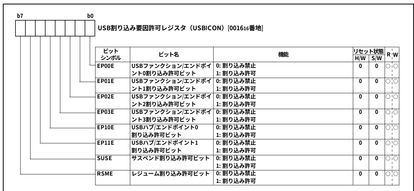
図3.4.9 USB割り込み要因許可レジスタ(USBICON)の構成
