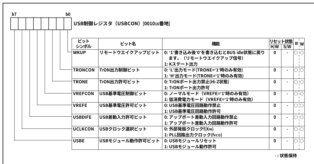
図3.4.3 USB制御レジスタ(USBCON)の構成
