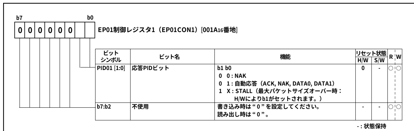
図47. EP01制御レジスタ1(EP01CON1)
