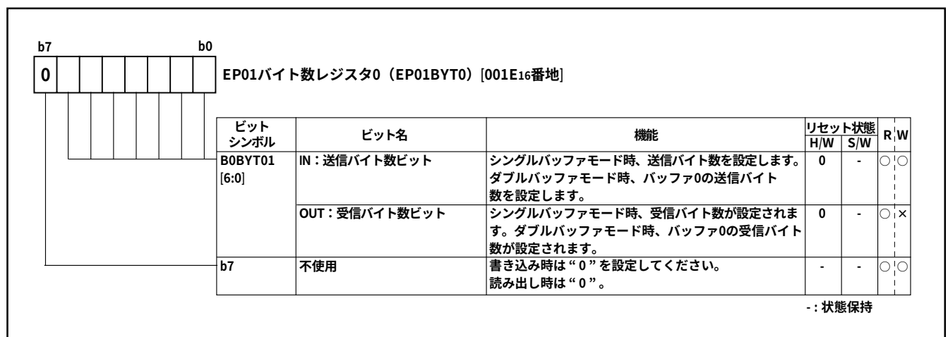
図3.4.42 EP01バイト数レジスタ0(EP01BYT0)の構成
