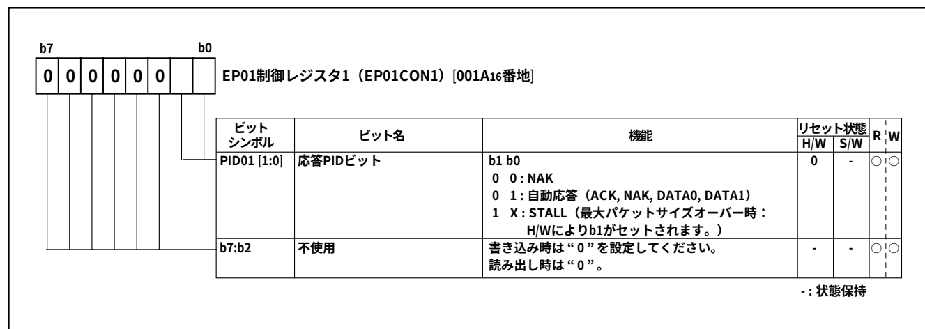
図3.4.19 EP01制御レジスタ1(EP01CON1)の構成
