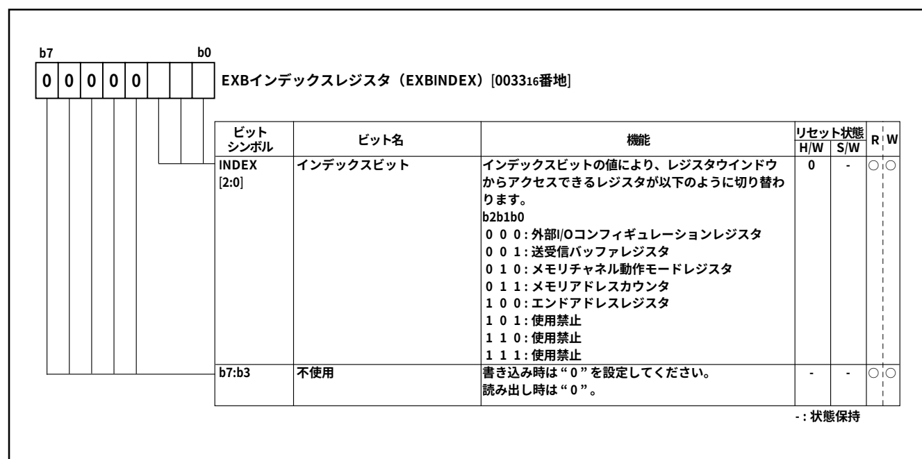
図3.4.67 EXBインデックスレジスタ(EXBINDEX)の構成
