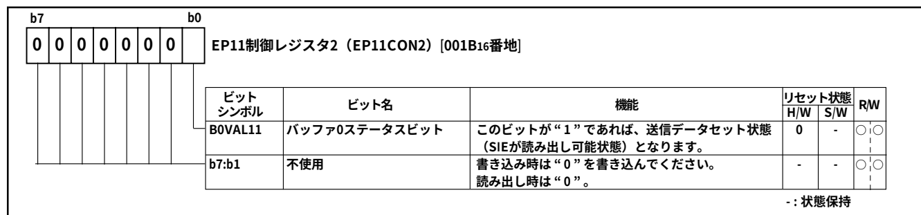
図82. EP11制御レジスタ2(EP11CON2)
