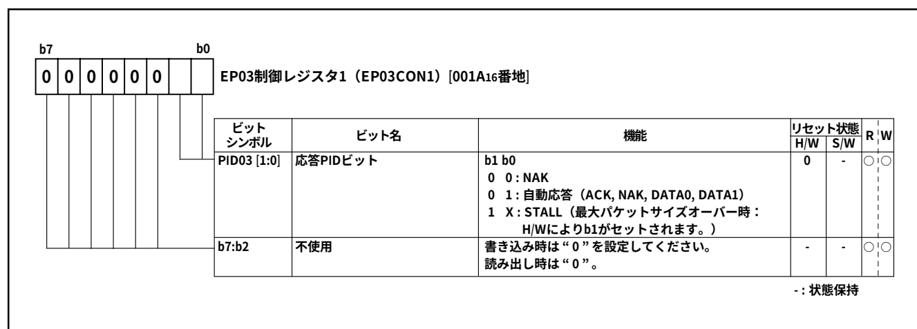
図3.4.21 EP03制御レジスタ1(EP03CON1)の構成
