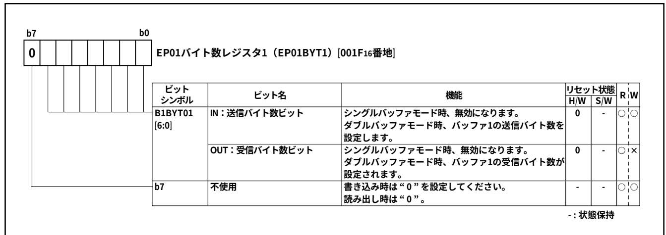
図3.4.47 EP01バイト数レジスタ1(EP01BYT1)の構成
