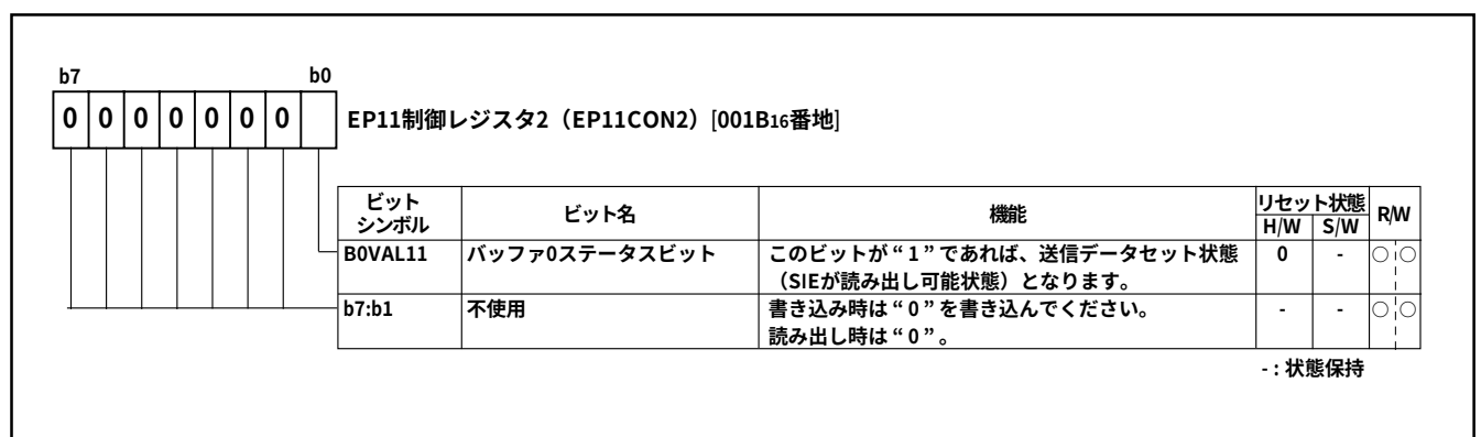
図3.4.29 EP11制御レジスタ2(EP11CON2)の構成
