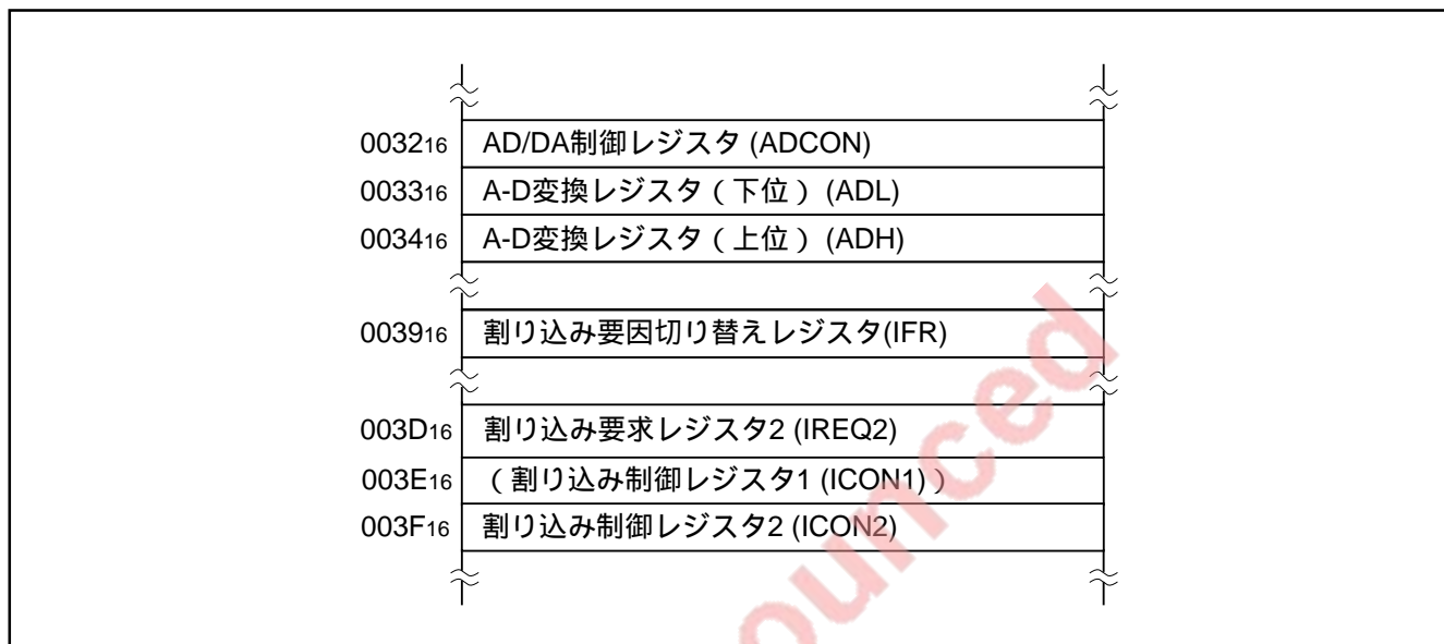
図2.5.1 A-D変換器関連レジスタのメモリ配置
