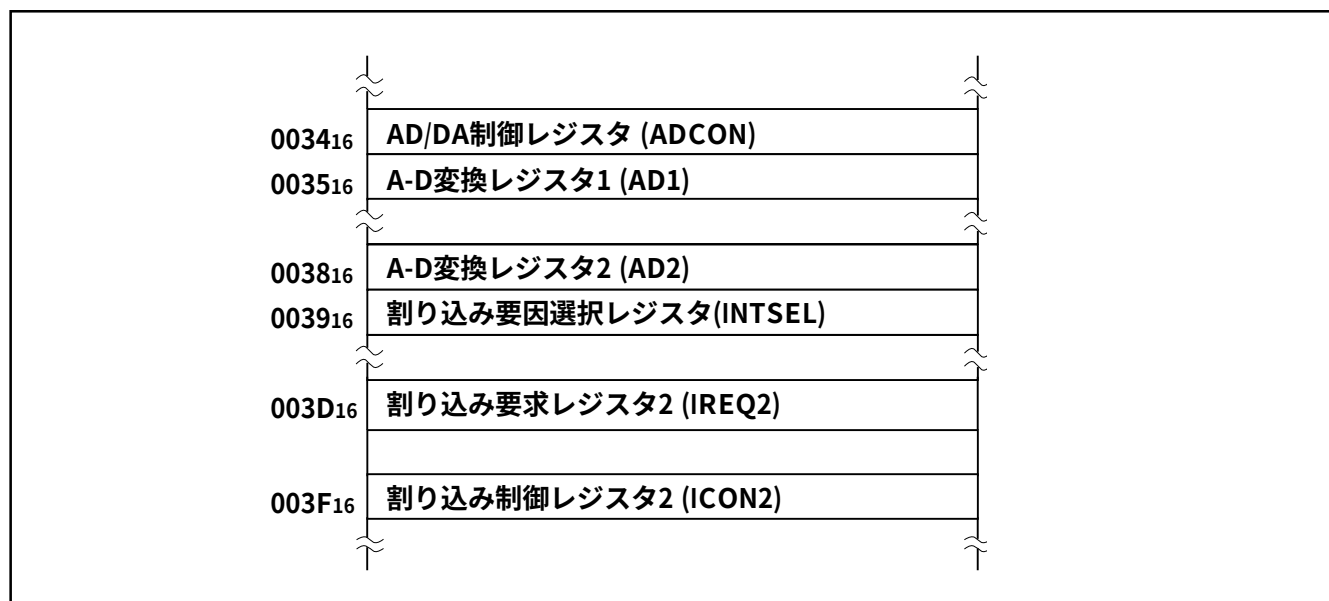
図2.7.1 A-D変換器関連レジスタのメモリ配置
