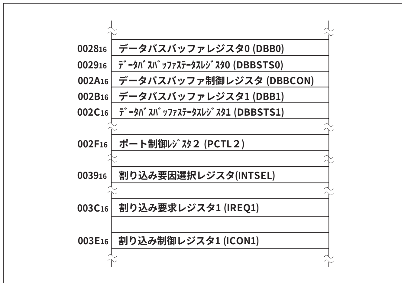
図2.9.1 バスインタフェース関連レジスタのメモリ配置
