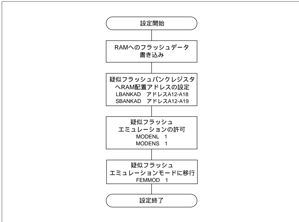
図6.7.9 疑似フラッシュエミュレーションモード移行シーケンス
