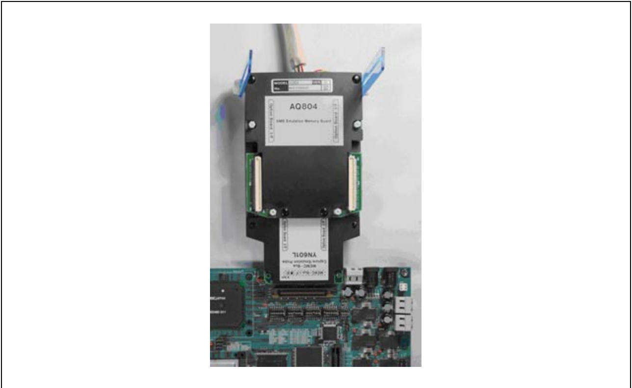
図6 - 5 advicePLUS YN601との接続図 (SDRAMバス・トレーサ)
