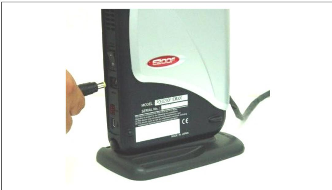
図 2.25 ACアダプタの接続方法
