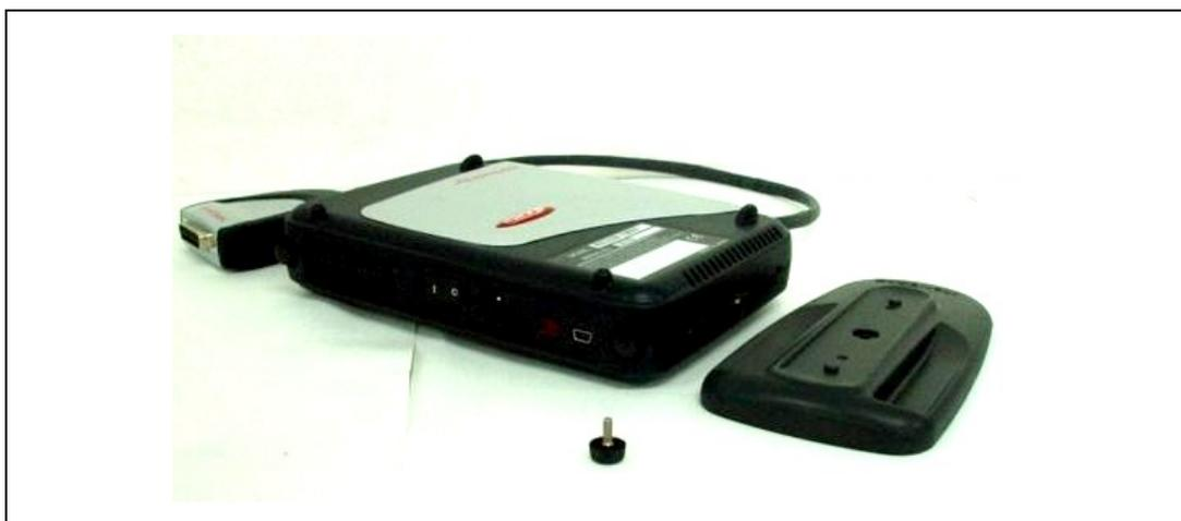
図 2.20 縦置き用ベース筐体の取り外し
