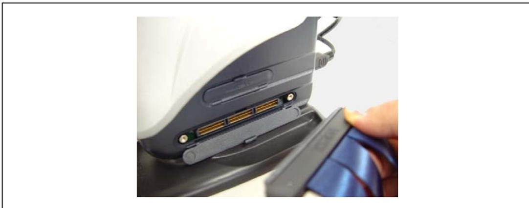
図 2.11 エバチップユニット使用時の E200F 側のトレースケーブル接続方法
