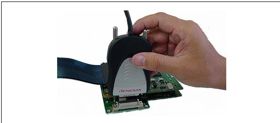
図 2.18 H-UDI/AUD プローブとエバチップユニットの接続方法
