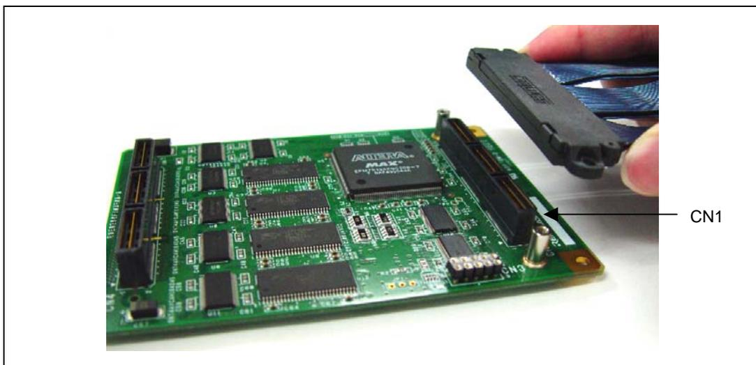
図 2.6 エミュレーションメモリユニット側のトレースケーブル接続方法
