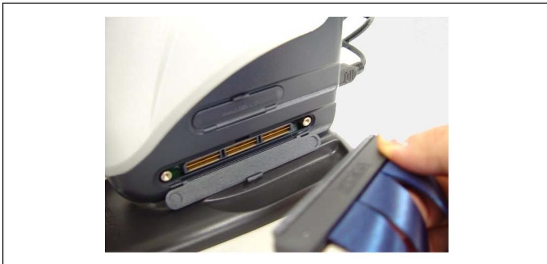
図 2.5 E200F 側のトレースケーブル接続方法
