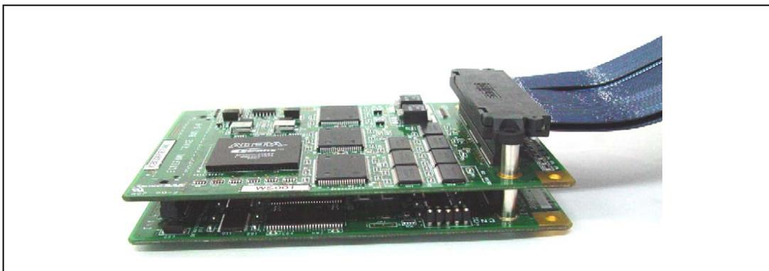
図 2.9 外部バストレースユニット、エミュレーションメモリユニット、およびトレースケーブルの接続方法
