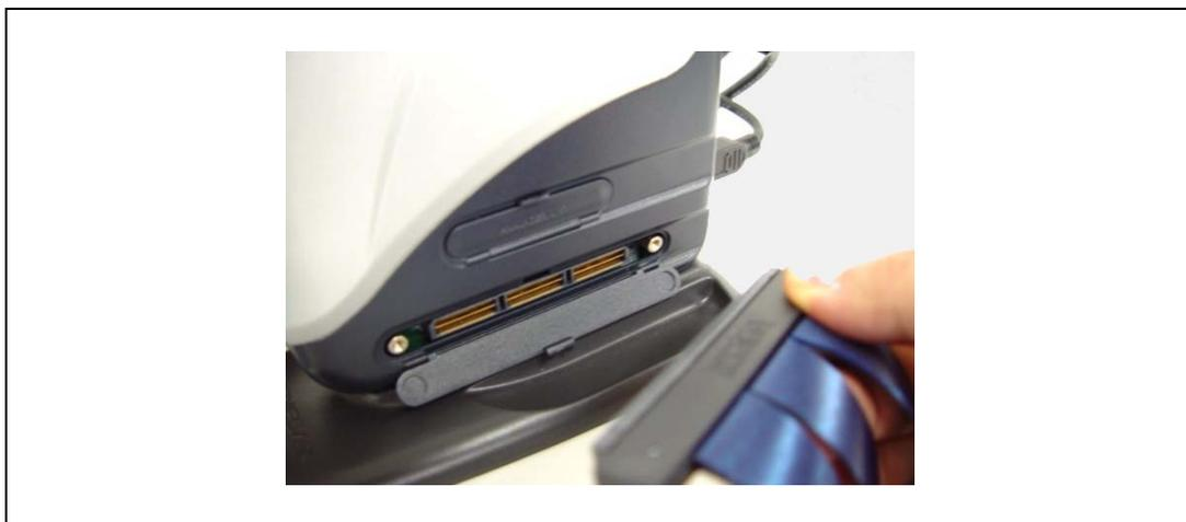
図 2.2 E200F 側のトレースケーブル接続方法
