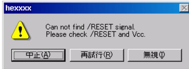
図 4.9 [Can not find /RESET signal]ダイアログボックス
