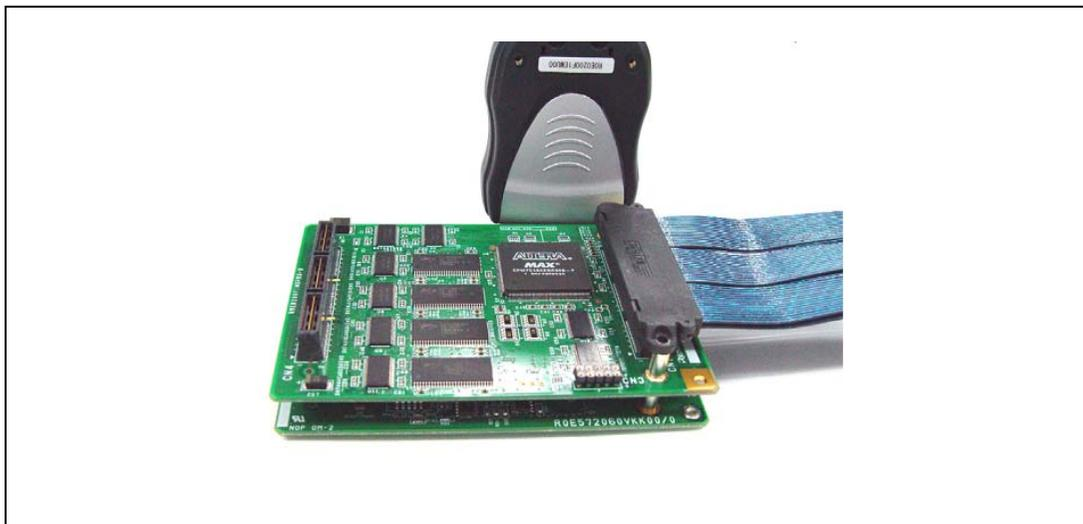
図 2.16 エミュレーションメモリユニット、エパチップユニット、およびトレースケープルの接続方法
