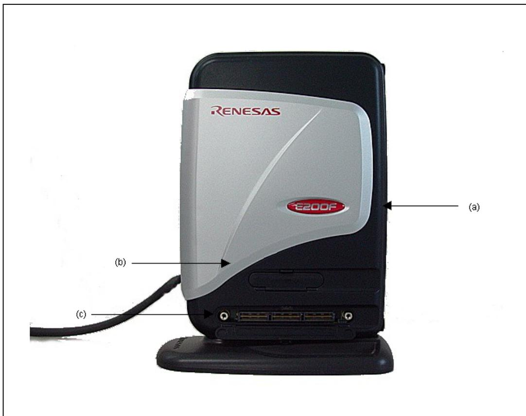
図 1.5 E200F エミュレータの右側面
