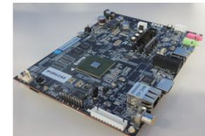
Linuxをサポートし、映像の入出力、USB、ネットワークなど基本的なI/Fを搭載。RZ/Gの機能評価から初期のアプリケーション開発まで使用いただけます。また、HMIスターターパッケージと組み合わせて簡単にグラフィックスや動画の性能を表示させながら確認できます。
