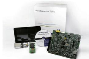
LCDディスプレイモジュール、J-LINK Liteデバッグエミュレータおよび統合開発環境e<sup>2</sup> studio同梱。キット購入後すぐにRZ/A1Hの評価を始められます。
