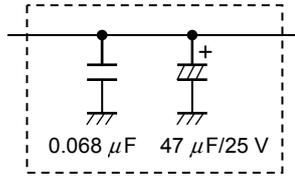
注 1. 電源端子間の干渉を防ぐため、各電源端子(V<sub>OD1</sub>, V<sub>OD2</sub>)の近くにバイパス・コンデンサを配置してください。
