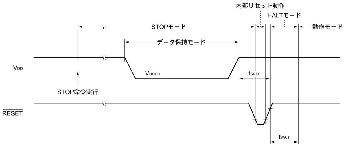
データ保持タイミング (スタンバイ・リリース信号 : 割り込み要求信号によるSTOPモード解除)
