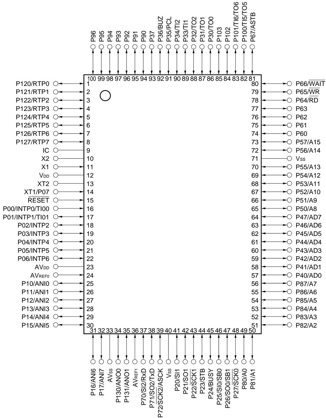
注意 1 . IC ( Internally Connected ) 端子はVssに直接接続してください。
