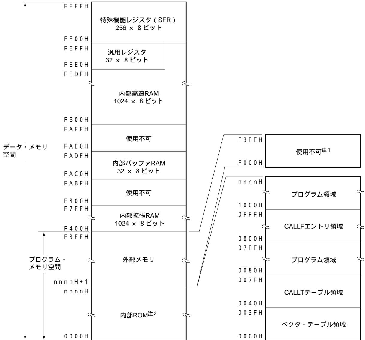
注1 . μPD78078で外部デバイス拡張機能を使用する場合、メモリ・サイズ切り替えレジスタ (IMS) により、内部ROM容量を56 Kバイト以下に設定してください。
