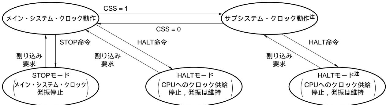
注 メイン・システム・クロックを停止させることにより、消費電流を低減できます。
