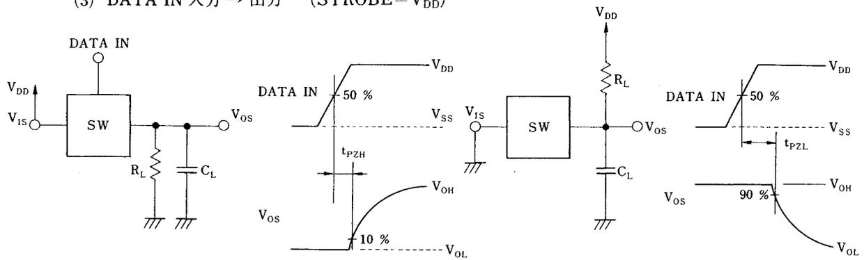
(4) アドレス入力 → 出力 ( $\overline{\text{STROBE}} = V_{DD}$ )
