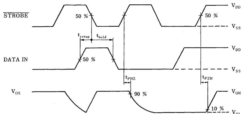
(3) DATA IN 入力 → 出力 ( $\overline{\text{STROBE}} = V_{DD}$ )
