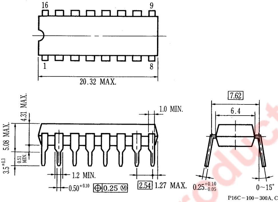
16ピン・プラスチック・ミニフラット (300 mil) 外形図(単位: mm)
