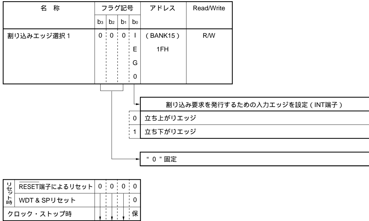
図12 - 11 割り込みエッジ選択レジスタの構成
