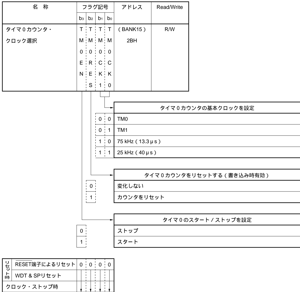
図13 - 9 タイマ0カウンタ・クロック選択レジスタの構成
