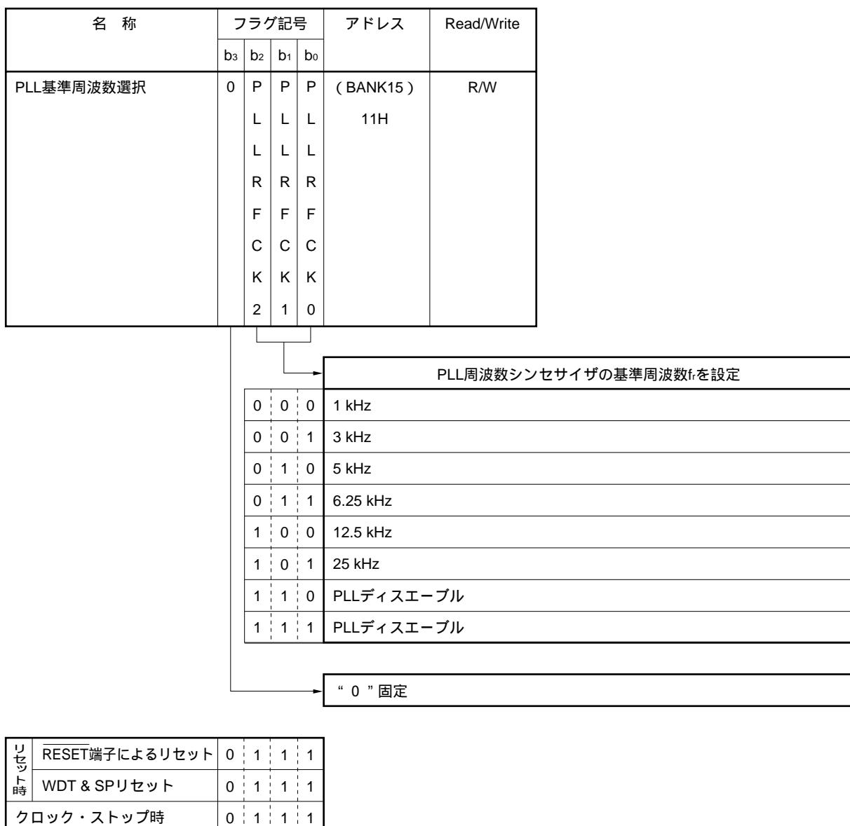
**備考** PLL基準周波数選択レジスタによりPLLディスエーブルを選択したときは，VCOH端子，VCOL端子が内部でプルダウンされます。また，EO1端子，EO0端子はフローティングとなります。
