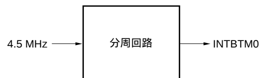
図3 - 2 ベーシック・タイマのブロック図
