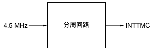
図5 - 2 ベーシック・タイマのブロック図
