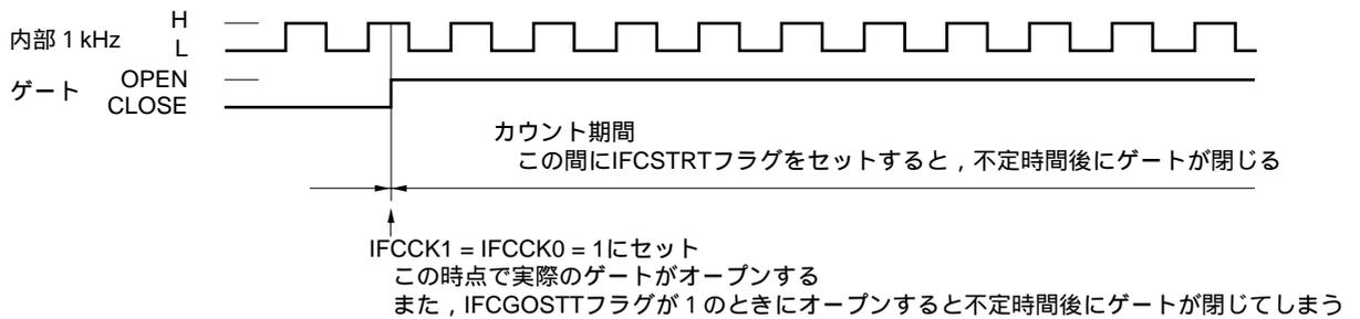
ゲート時間にオープンを選択した場合のゲートの開閉は以下の(a)および(b)に示す2通りの方法があります。
