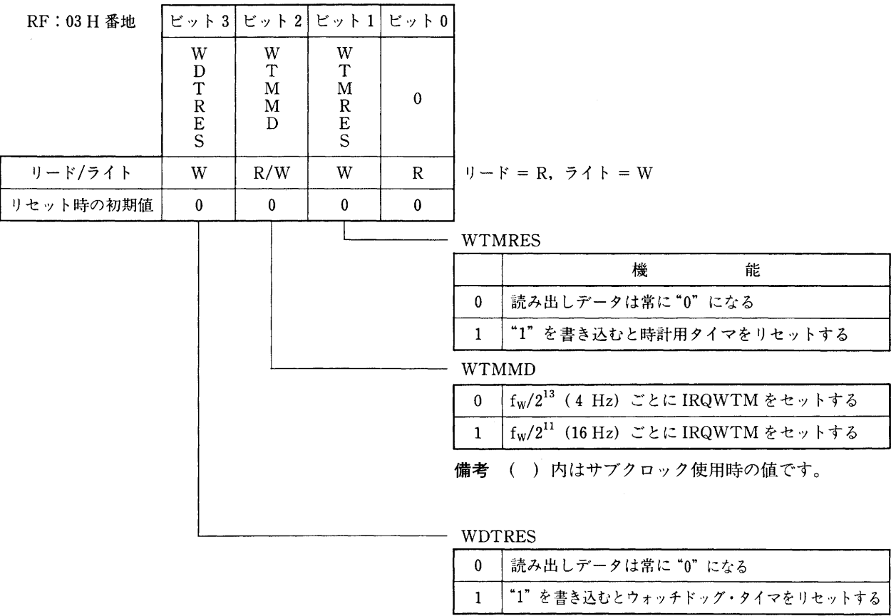
図 8-2 時計用タイマ/ウォッチドッグ・タイマの制御レジスタ
