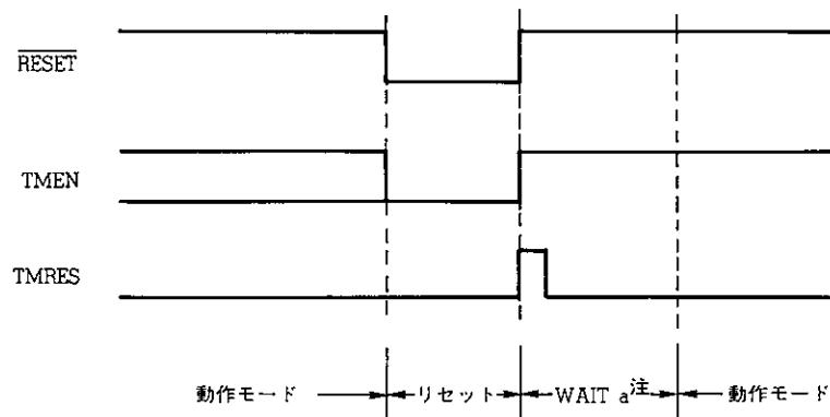
注 発振安定待ち時間です。タイマによりシステム・クロックを256×256カウント (約32 ms,  $f_{cc} = 2 \text{ MHz}$  時) すると動作モードとなります。
