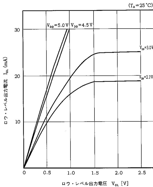
注意 絶対最大定格は1端子あたり30mAです。また、POE<sub>1</sub>端子の入力電圧および出力電圧は、V<sub>DD</sub>+0.3Vを越えることはできません。
