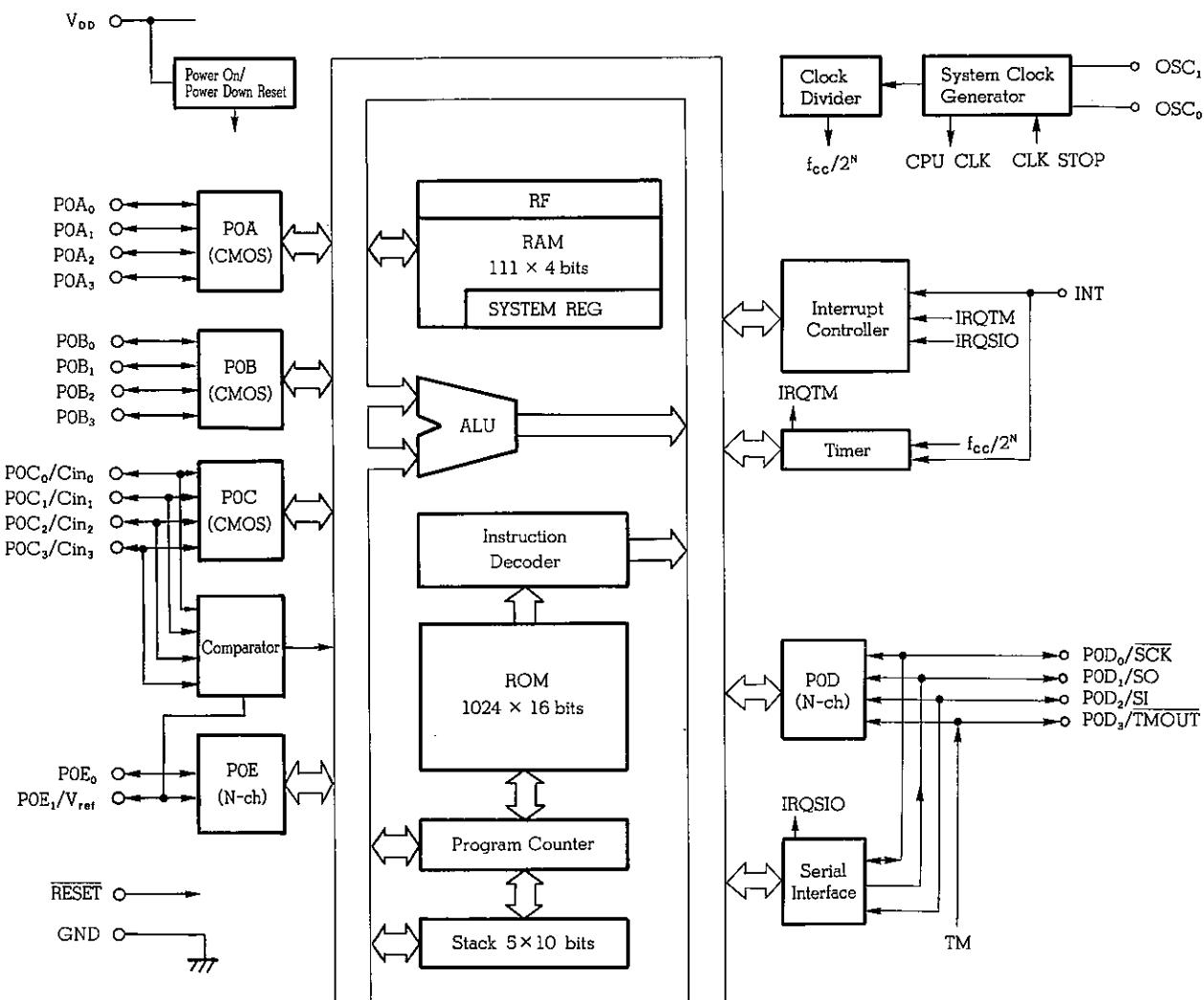
備考 ( ) 内の CMOS, N-ch はポートの出力形式を表します。
