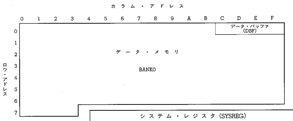
図 11-2 にデータ・バッファの構成を示します。図 11-2 に示すようにデータ・バッファはデータ・メモリの 0FH 番地のビット 0 を LSB とし、0CH 番地のビット 3 を MSB とする 16 ビットで構成されています。
