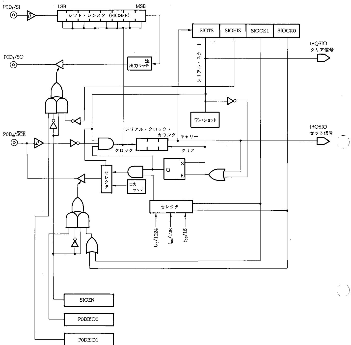
注 シフト・レジスタの出力ラッチは、POD<sub>1</sub> の出力ラッチと兼用になっています。したがって、POD<sub>1</sub> に対して出力命令を実行すると、シフト・レジスタの出力ラッチの状態も変化します。
