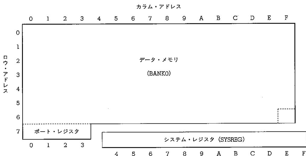
図9-2にシステム・レジスタの構成を示します。図9-2に示すようにシステム・レジスタは、次の7個のレジスタで構成されています。
