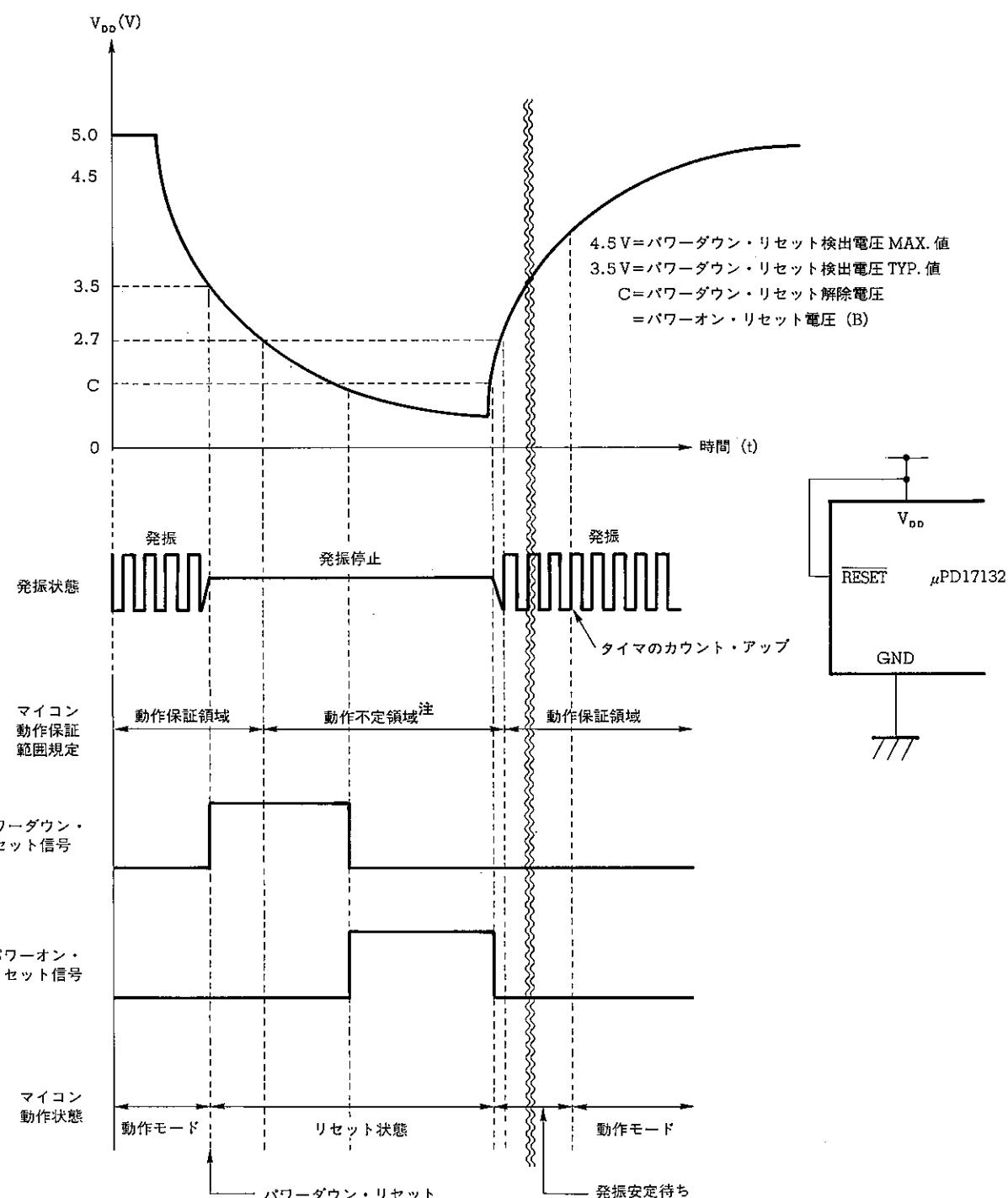
★ 注 動作不定領域とは、 $\mu$ PD17132に規定されている動作がすべては保証されていない領域のことです。ただし、この領域においても、パワーダウン・リセット機能は動作し、マイコン内部のそのほかの機能がすべて停止するまでリセットを発生し続けます。
