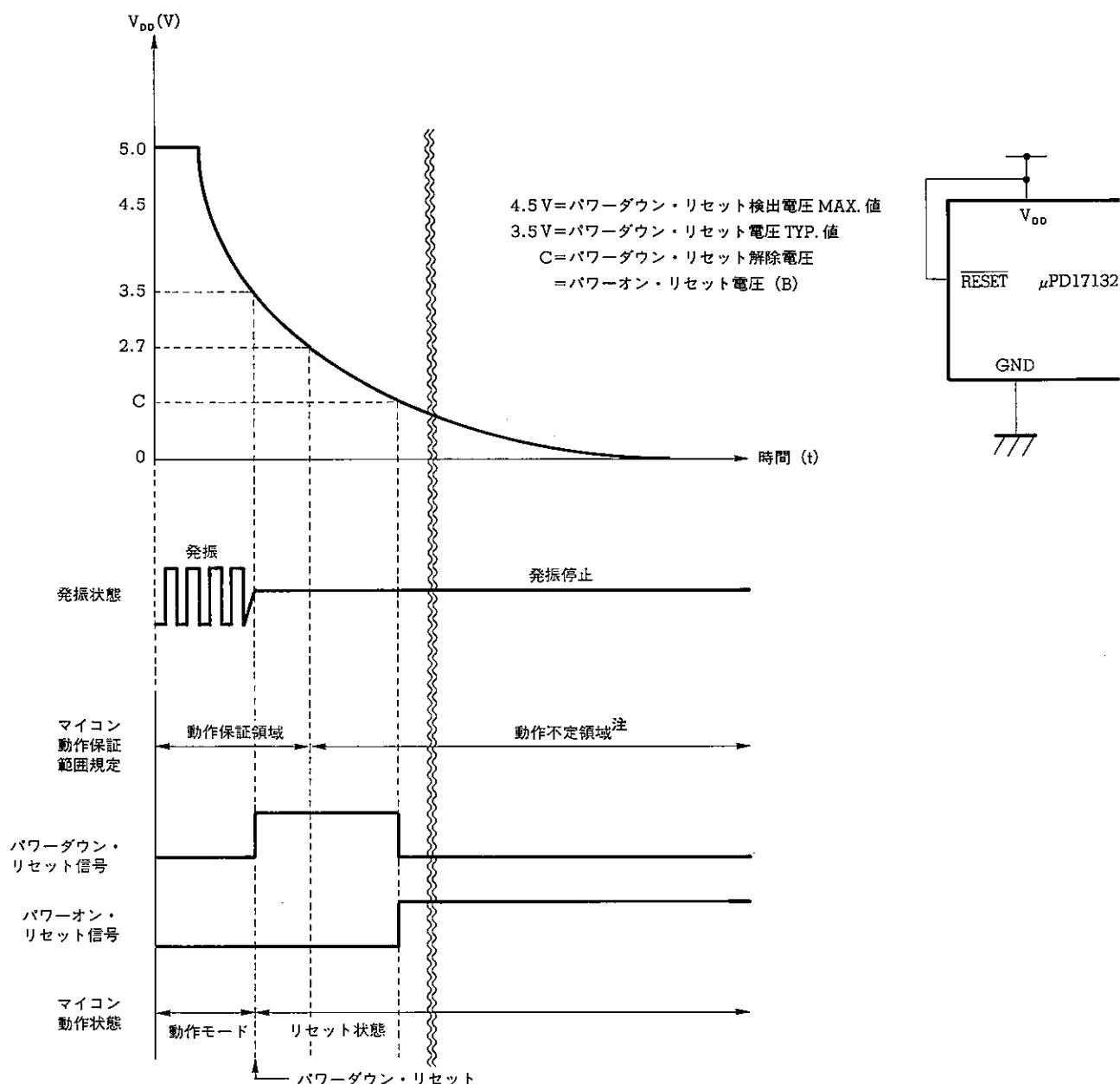
注 動作不定領域とは、 $\mu$ PD17132 に規定されている動作がすべては保証されていない領域のことです。ただし、この低電圧の領域においても、ほかのマイコン内部回路機能がすべて停止するまでリセット信号を発生し続けるというパワーダウン・リセット機能のみについては動作が保証されています。
